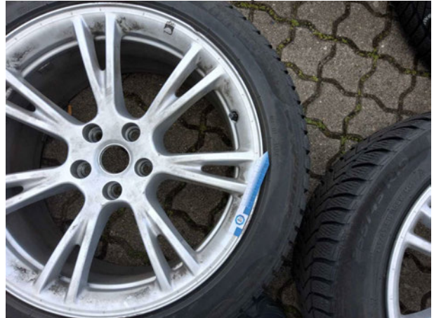
Beschädigung #5: 2.Radsatz: Leichtmetallfelgensatz komplett - verkratzt / verschürft - Wertminderung
