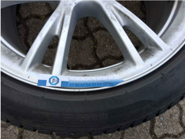
Beschädigung #5: 2.Radsatz: Leichtmetallfelgensatz komplett - verkratzt / verschürft - Wertminderung
