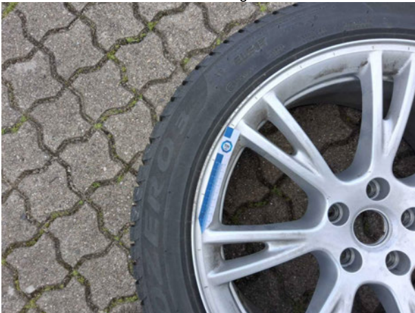
Beschädigung #5: 2.Radsatz: Leichtmetallfelgensatz komplett - verkratzt / verschürft - Wertminderung
