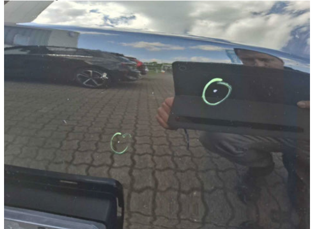
Beschädigung #9: Stossfänger vorn: Stossfänger vorn - Steinschlag - lackieren
