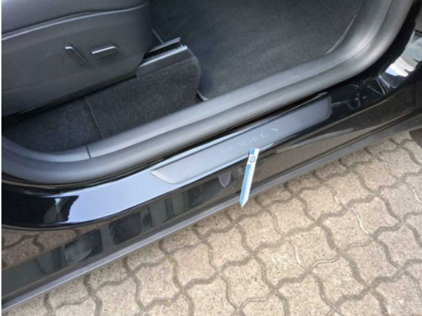
Beschädigung #1: Schweller rechts: Einstieg - Kratzer - Smart Repair
