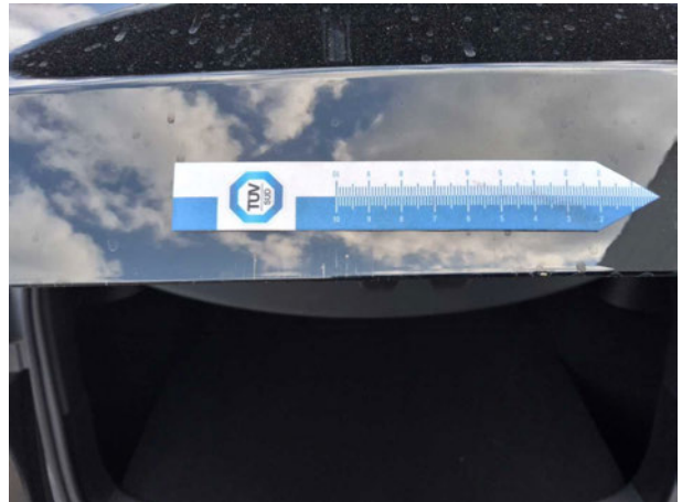
Beschädigung #13: Heckklappe/-tür: Heckklappe - Delle / Lackschaden - instandsetzen und lackieren
