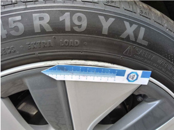
Beschädigung #7: Rad/Reifen: Leichtmetallfelge hinten rechts - beschädigt - erneuern
