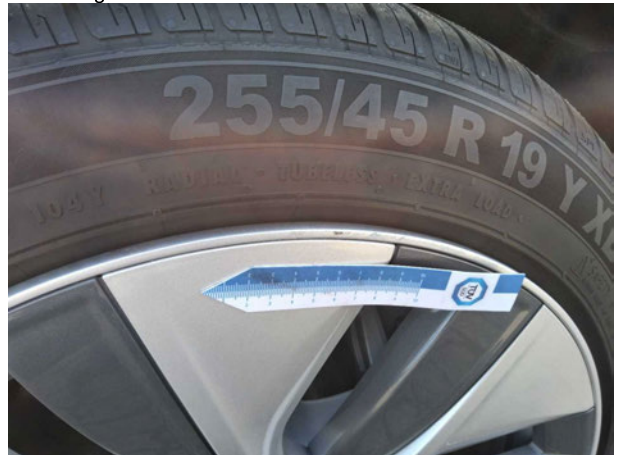
Beschädigung #8: Rad/Reifen: Leichtmetallfelge vorn links - beschädigt - erneuern
