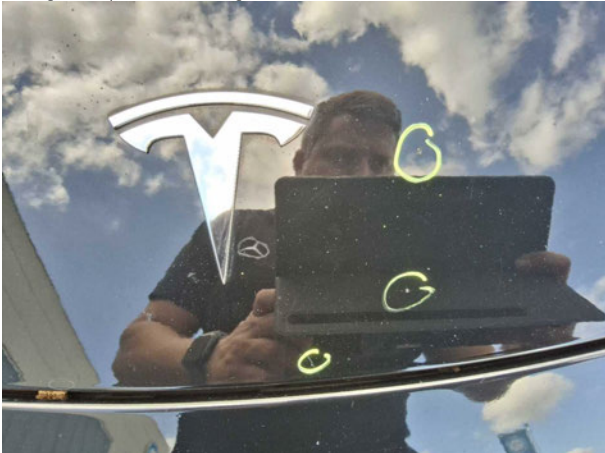
Beschädigung #14: Motorhaube: Motorhaube (Mit Farbstift übergemalt) - Steinschlag - instandsetzen und lackieren
