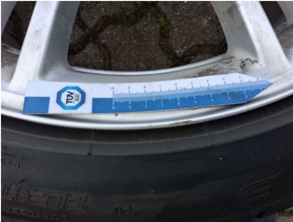
Beschädigung #5: 2.Radsatz: Leichtmetallfelgensatz komplett - verkratzt / verschürft - Wertminderung
