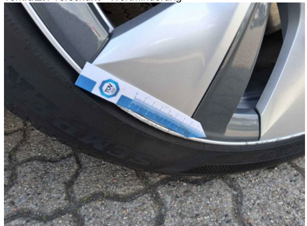
Beschädigung #6: Rad/Reifen: Leichtmetallfelge hinten links - beschädigt - erneuern
