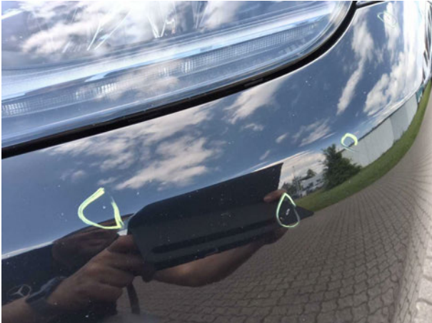
Beschädigung #9: Stossfänger vorn: Stossfänger vorn - Steinschlag - lackieren
