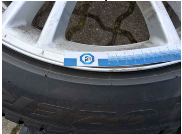
Beschädigung #5: 2.Radsatz: Leichtmetallfelgensatz komplett - verkratzt / verschürft - Wertminderung
