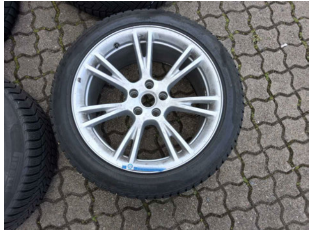
Beschädigung #5: 2.Radsatz: Leichtmetallfelgensatz komplett - verkratzt / verschürft - Wertminderung
