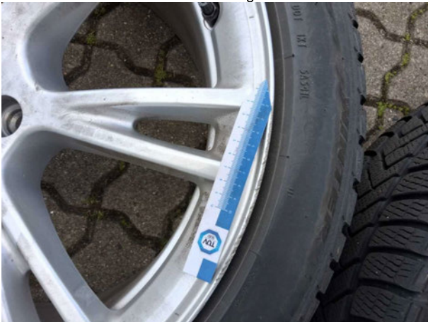
Beschädigung #5: 2.Radsatz: Leichtmetallfelgensatz komplett - verkratzt / verschürft - Wertminderung
