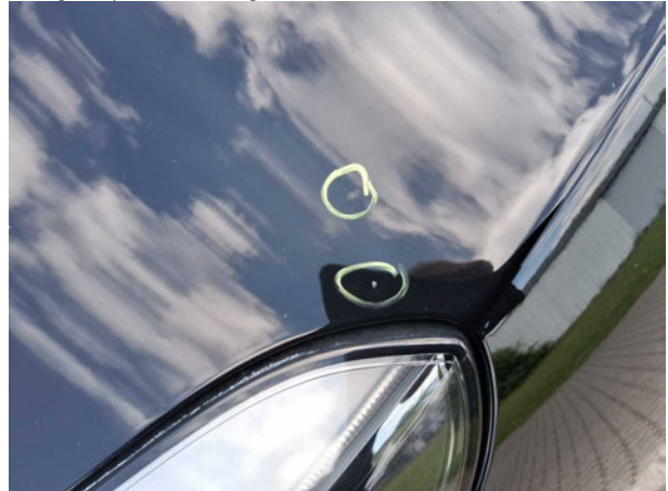
Beschädigung #10: Kotflügel links: Kotflügel links (Mit Farbstift übergemalt) - Steinschlag - instandsetzen und lackieren
