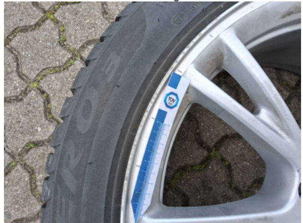
Beschädigung #5: 2.Radsatz: Leichtmetallfelgensatz komplett - verkratzt / verschürft - Wertminderung
