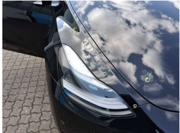
Beschädigung #11: Kotflügel rechts: Kotflügel rechts (Mit Farbstift übergemalt) - Steinschlag - instandsetzen und lackieren
