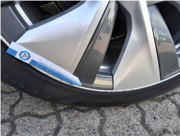
Beschädigung #6: Rad/Reifen: Leichtmetallfelge hinten links - beschädigt - erneuern
