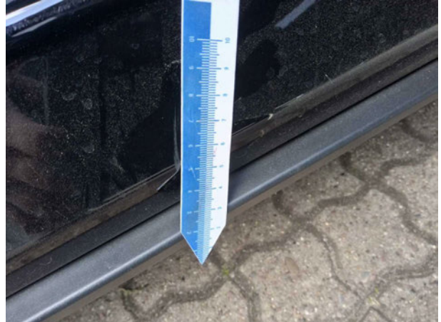
Beschädigung #1: Schweller rechts: Einstieg - Kratzer - Smart Repair
