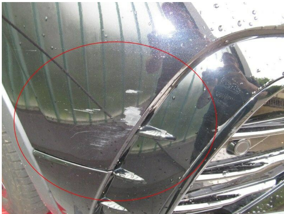
Bild 16 : Stoßfänger vorne Lackierung, verschrammt, lackieren mit Lackaufbau
