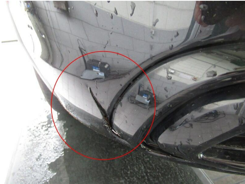
Bild 19 : Heckverkleidung unten gebrochen
