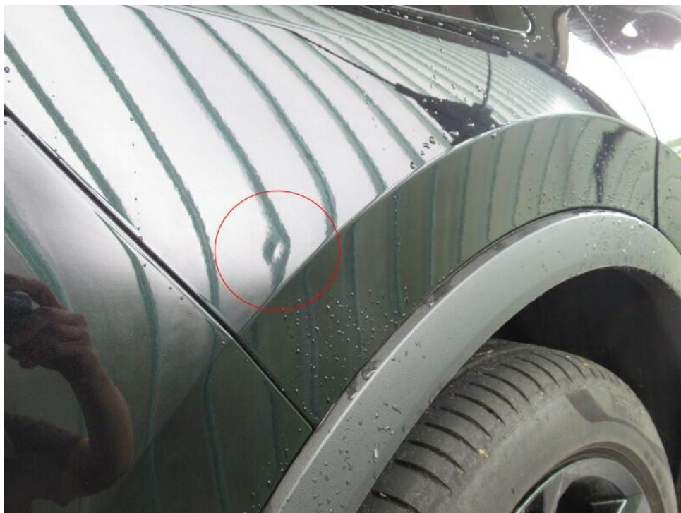
Bild 18 : Seitenwand h.r. Delle
