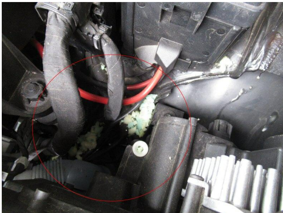
Bild 13 : Dämmmatte Motorraum eingerissen
