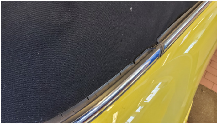
#S.12 Gummileisten rissig (Bild 2/2)
