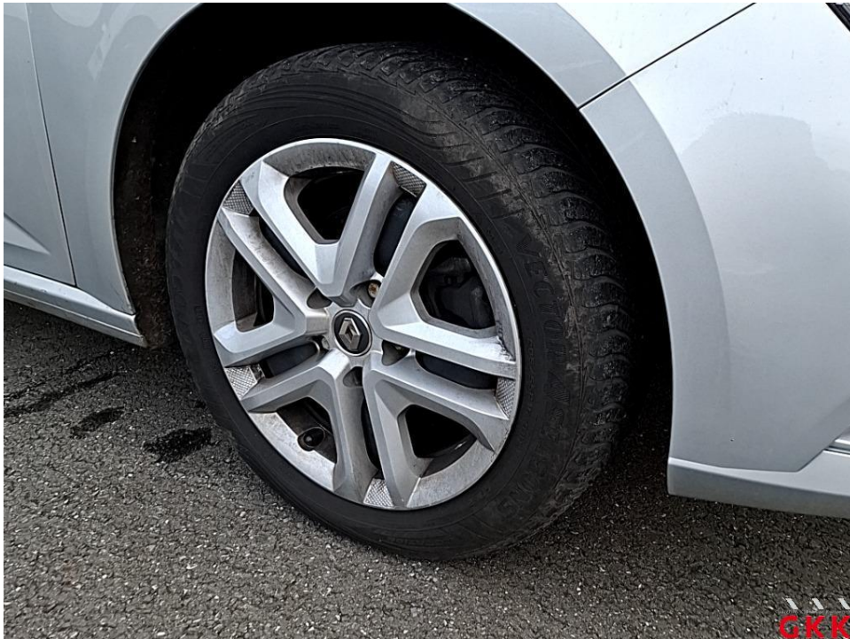
Bild 25 Reifen, vorne rechts, Untermaß, ersetzen
