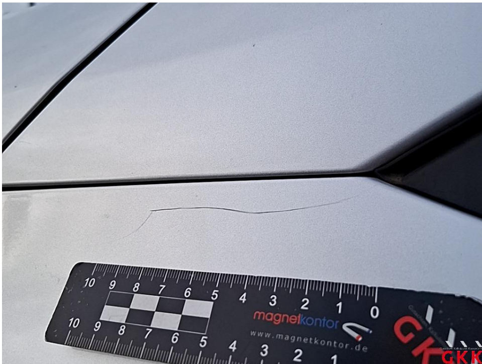
Bild 14 Kotflügel vorne links, verkratzt, lackieren
