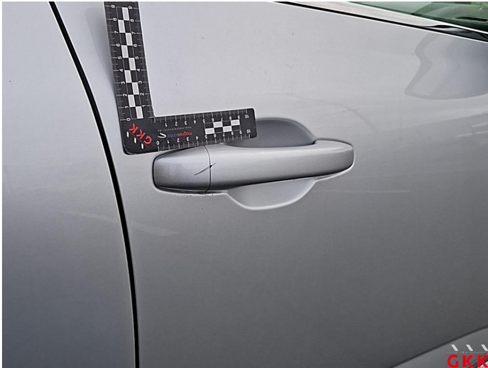
Bild 21 Tür vorne rechts, Griff -Blende-, verkratzt, lackieren
