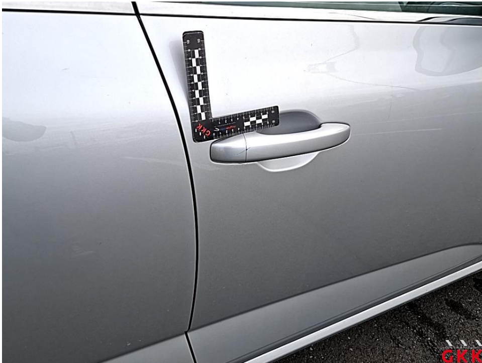
Bild 23 Tür vorne rechts, Griff, verkratzt, lackieren
