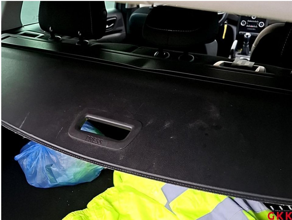
Bild 17 Laderaum, Abdeckung, beschädigt, ersetzen
