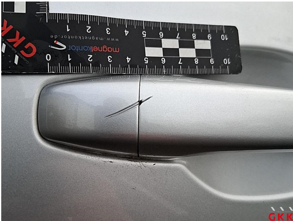
Bild 24 Tür vorne rechts, Griff, verkratzt, lackieren
