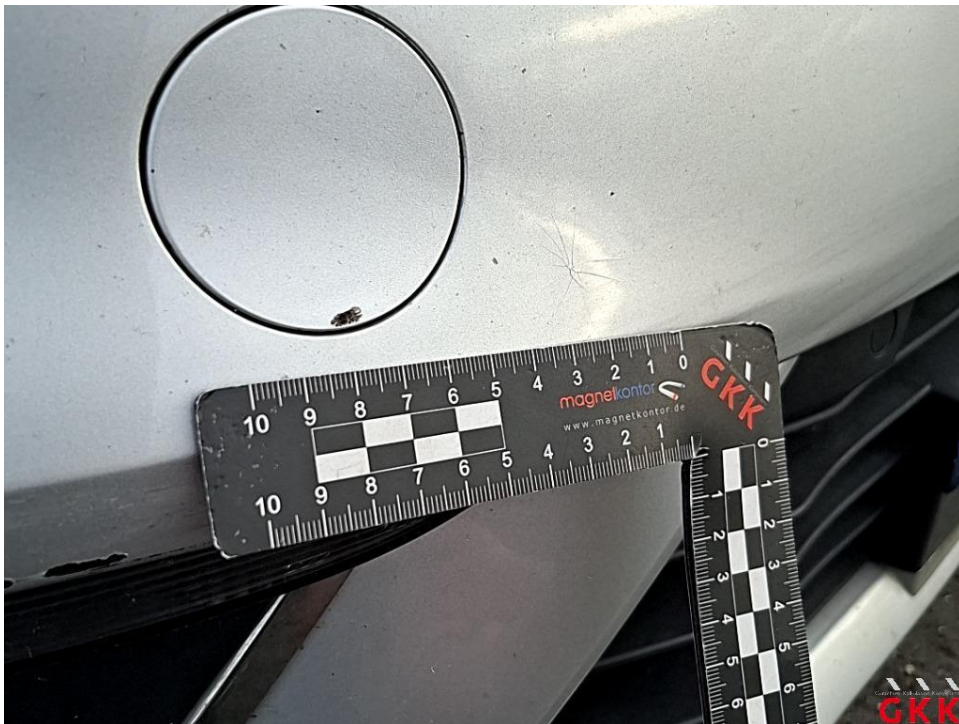
Bild 10 Stoßfänger vorne, Verkleidung -lackiert-, beschädigt, instand setzen - lackieren
