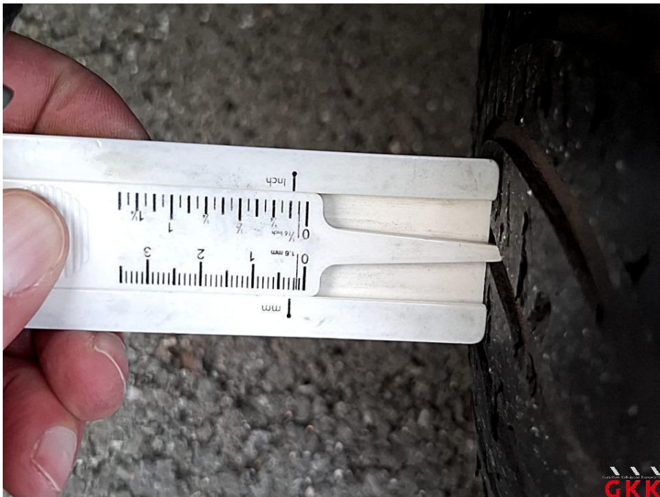
Bild 12 Reifen, vorne links, Untermaß, ersetzen
