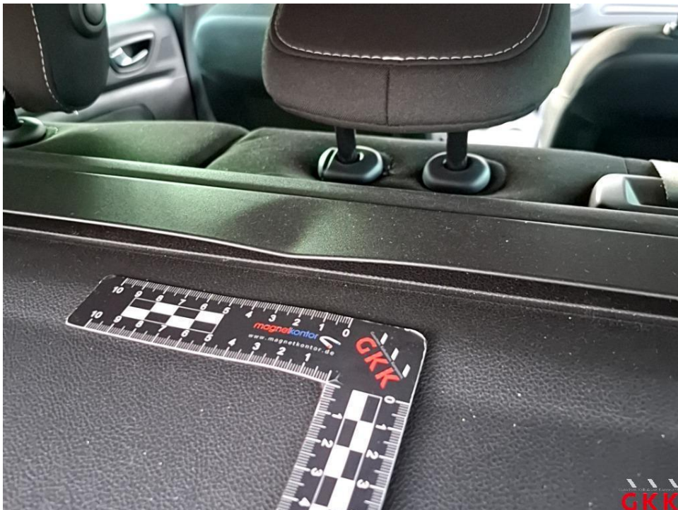
Bild 18 Laderaum, Abdeckung, beschädigt, ersetzen
