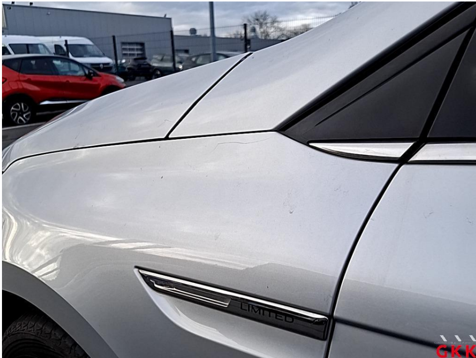
Bild 13 Kotflügel vorne links, verkratzt, lackieren
