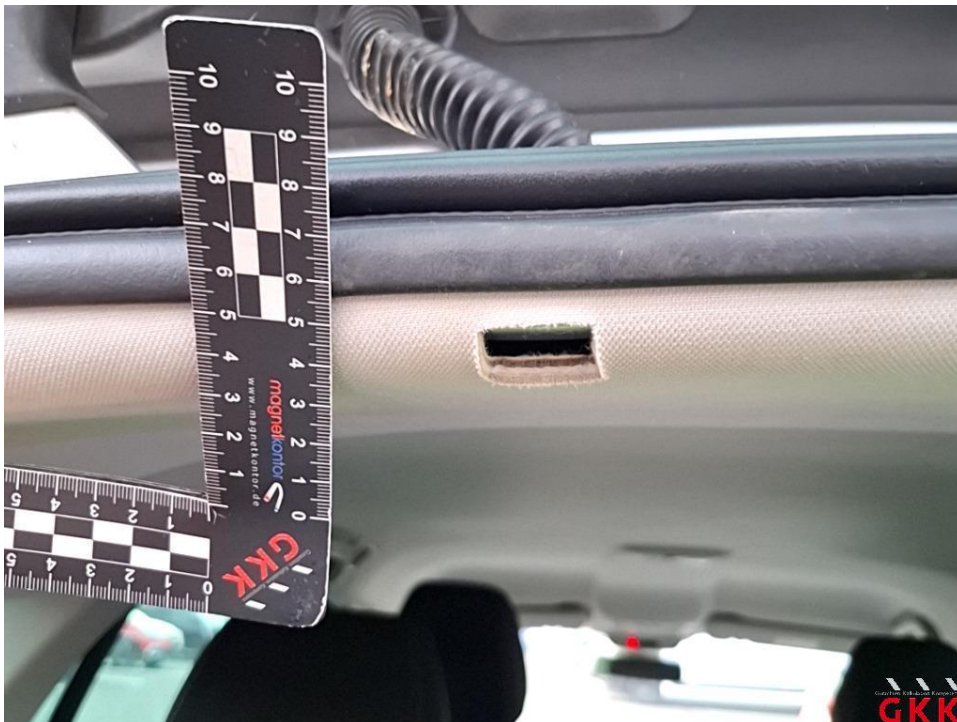
Bild 20 Himmel, Blende, fehlt, ersetzen
