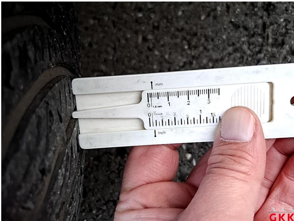
Bild 26 Reifen, vorne rechts, Untermaß, ersetzen
