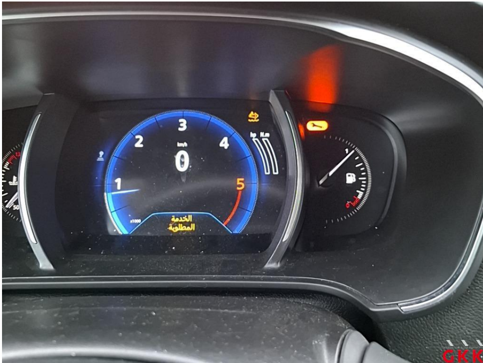
Bild 27 Kombiinstrument, Fehlerspeicher, aktiv, auslesen / prüfen
