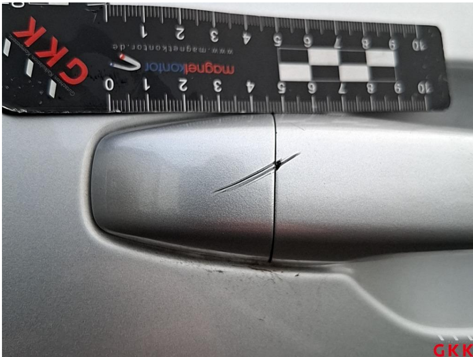
Bild 22 Tür vorne rechts, Griff -Blende-, verkratzt, lackieren
