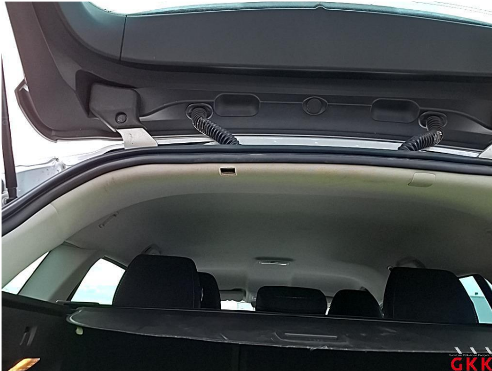
Bild 19 Himmel, Blende, fehlt, ersetzen
