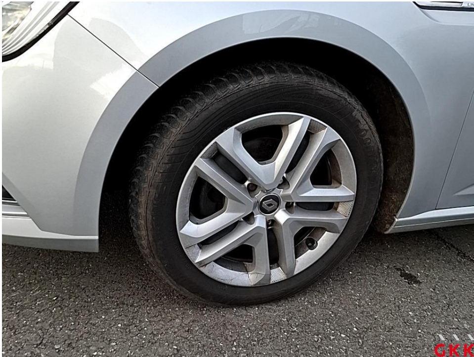
Bild 11 Reifen, vorne links, Untermaß, ersetzen
