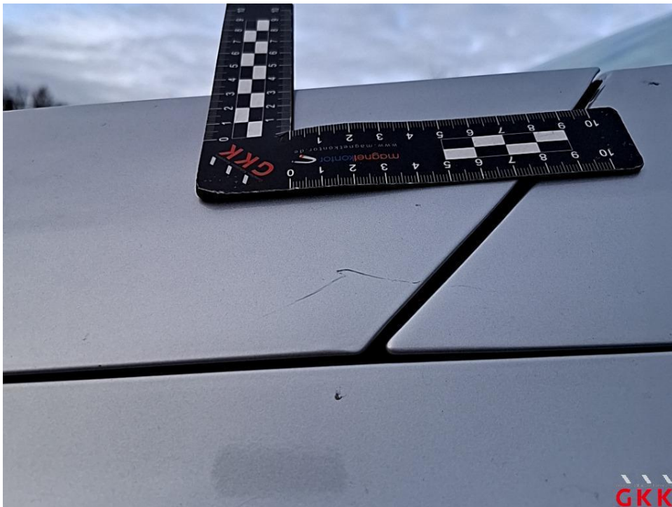
Bild 16 Motorhaube, verkratzt, Smartrepair
