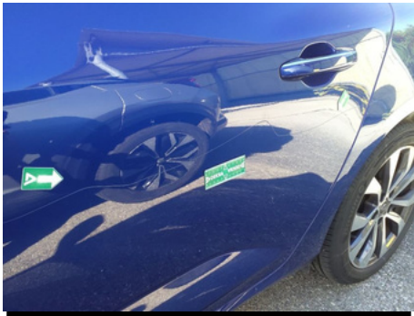
Porte / Arrière Gauche / Enfoncement
