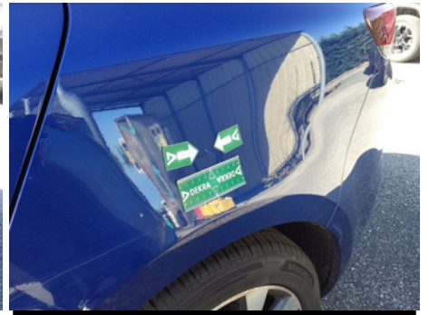
Aile / Arrière Gauche / Enfoncement
