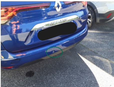
Pare-chocs / Arrière / Enfoncement
