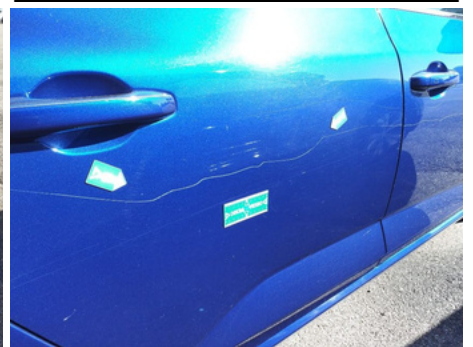
Porte / Arrière Droit / Enfoncement
