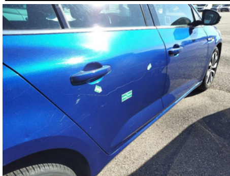
Porte / Arrière Droit / Enfoncement
