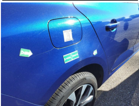
Aile / Arrière Droit / Enfoncement
