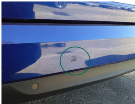
Pare-chocs / Arrière / Enfoncement
