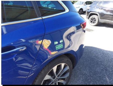
Aile / Arrière Gauche / Enfoncement
