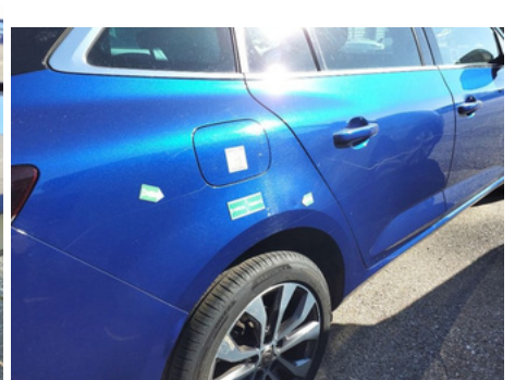
Aile / Arrière Droit / Enfoncement
