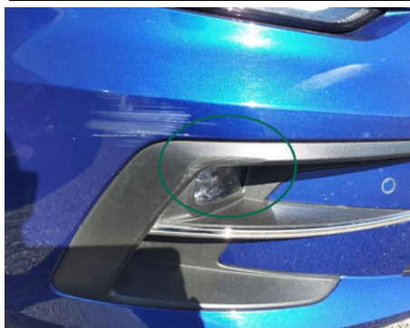
Enjoliveur d'antibrouillard / Avant Droit / Rayure
