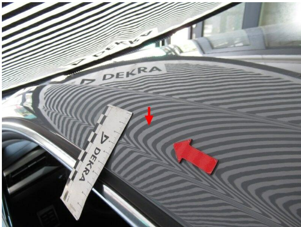
Bild 24 : nicht reparierter Hagelschaden
