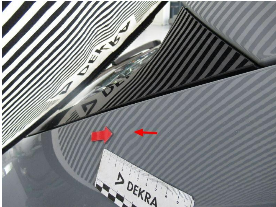
Bild 25 : nicht reparierter Hagelschaden
