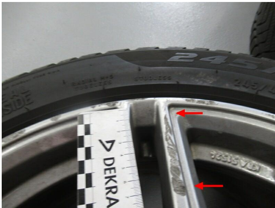
Bild 20 : Felge der Winterreifen hinten rechts zerkratzt
