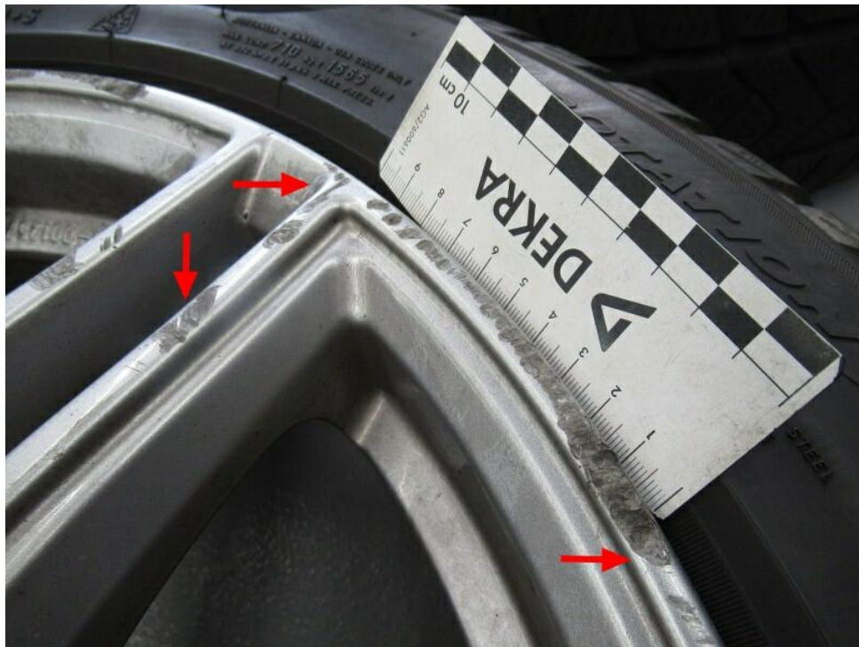
Bild 19 : Felge der Winterreifen hinten rechts zerkratzt
