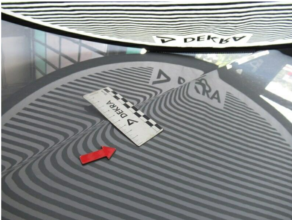
Bild 22 : nicht reparierter Hagelschaden
