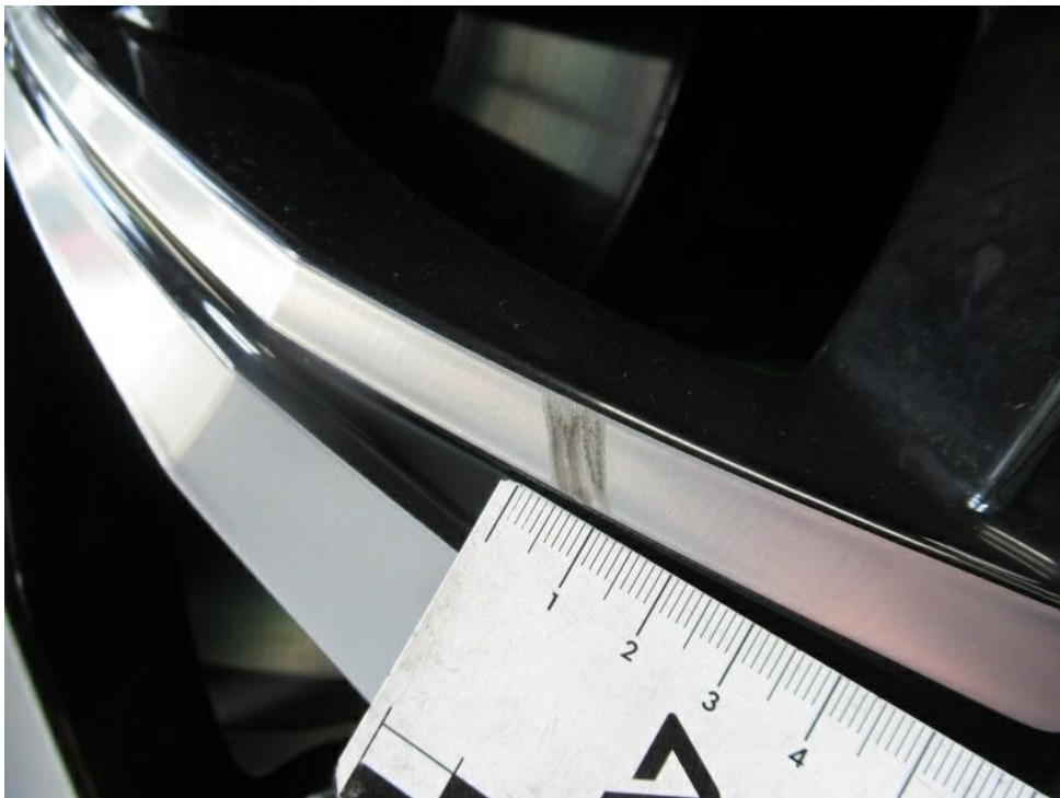
Bild 30 : Glanzgedrehte Felge vorne links zerkratzt
