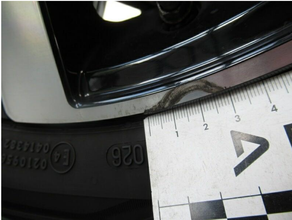
Bild 29 : Glanzgedrehte Felge vorne links zerkratzt
