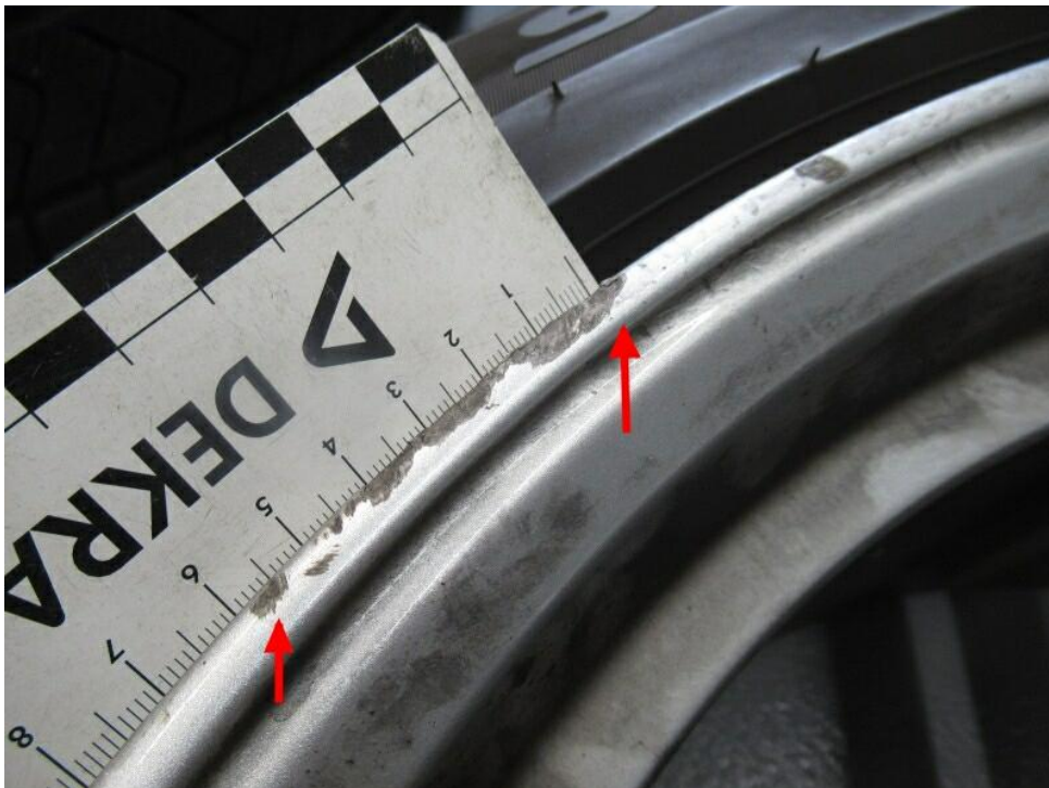
Bild 16 : Felge der Winterreifen vorne rechts zerkratzt
