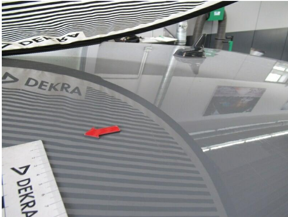
Bild 23 : nicht reparierter Hagelschaden
