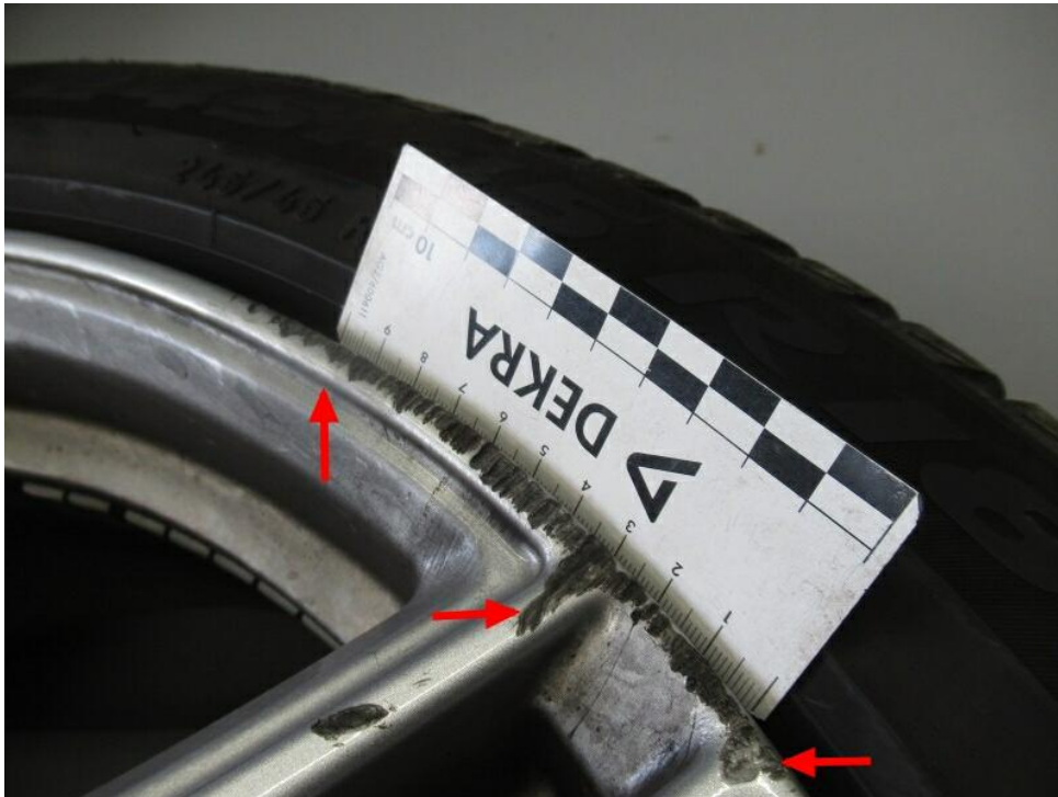
Bild 17 : Felge der Winterreifen vorne rechts zerkratzt
