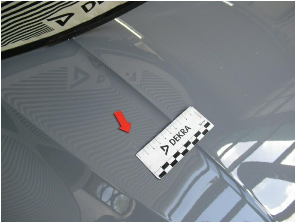
Bild 21 : nicht reparierter Hagelschaden
