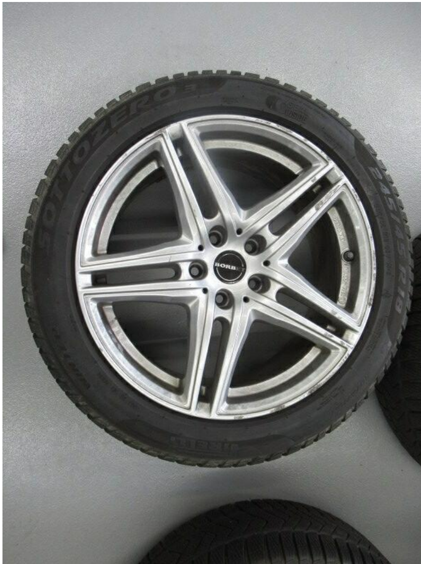
Bild 18 : Felge der Winterreifen hinten rechts zerkratzt
