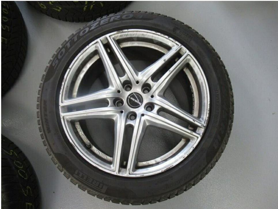
Bild 15 : Felge der Winterreifen vorne rechts zerkratzt
