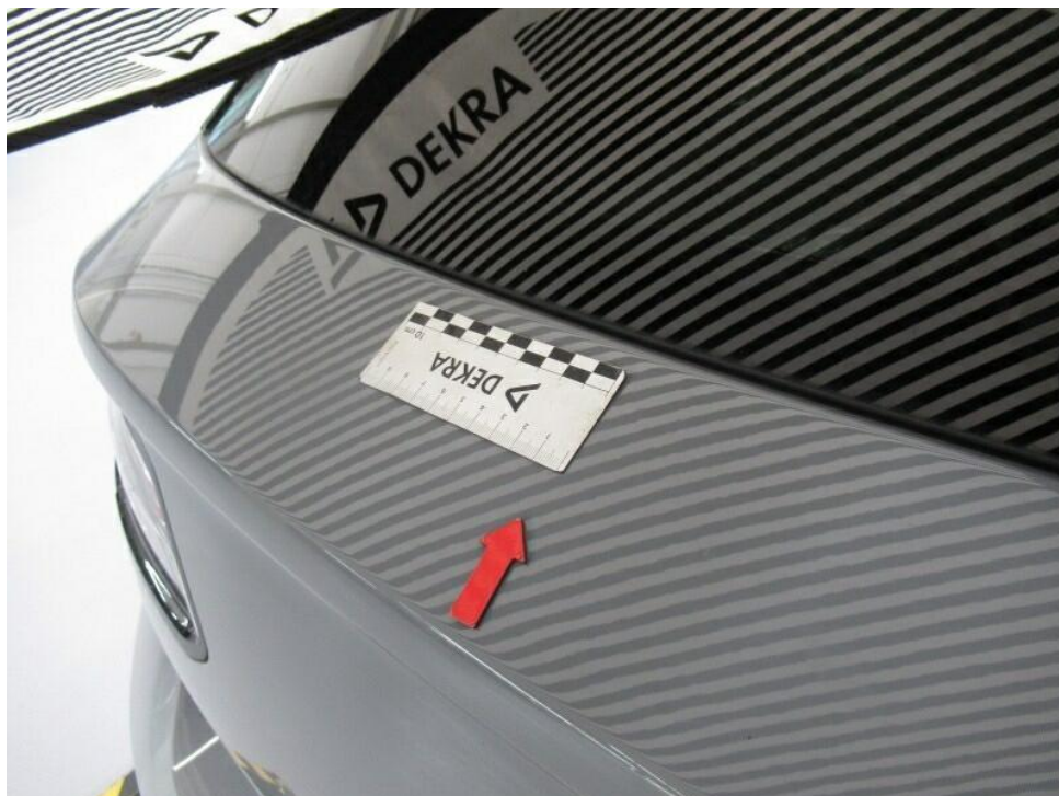
Bild 26 : nicht reparierter Hagelschaden
