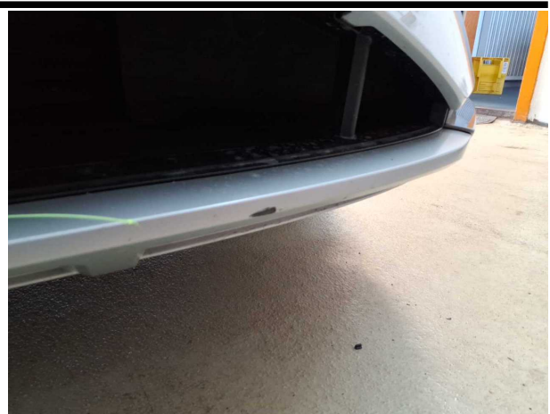
Beschädigung #4: Stossfänger vorn: Spoiler - verkratzt / verschürft - erneuern
