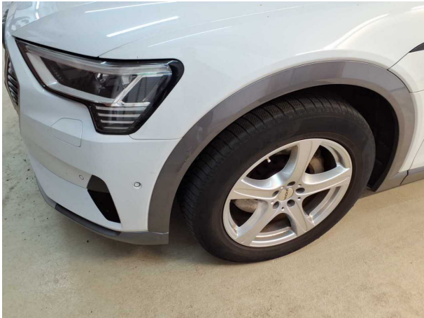
Beschädigung #2: Kotflügel links: Radhausverbreiterung - verkratzt / verschürft - erneuern
