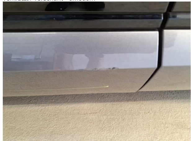
Beschädigung #3: Tür vorn links: Zierleiste unten - verkratzt / verschürft - erneuern
