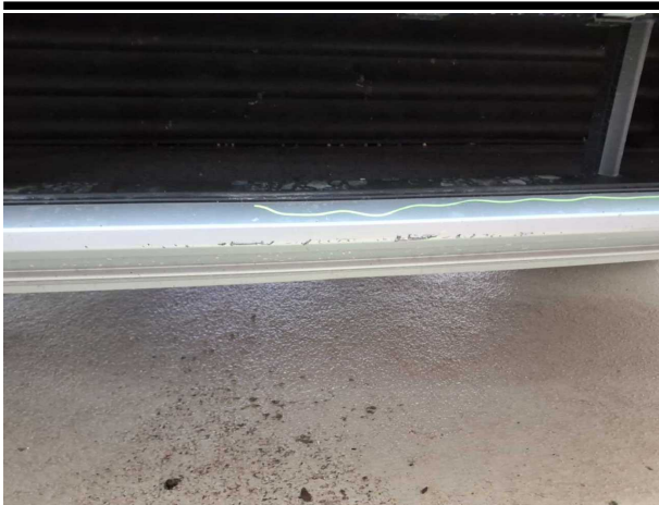
Beschädigung #4: Stossfänger vorn: Spoiler - verkratzt / versch... - erneuern
