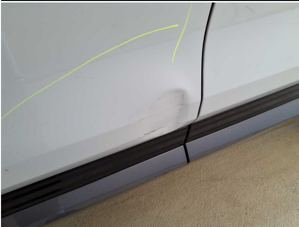
Beschädigung #6: Tür vorn links: Tür - verformt - erneuern
