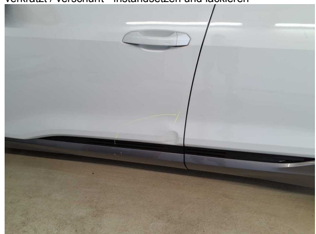
Beschädigung #6: Tür vorn links: Tür - verformt - erneuern
