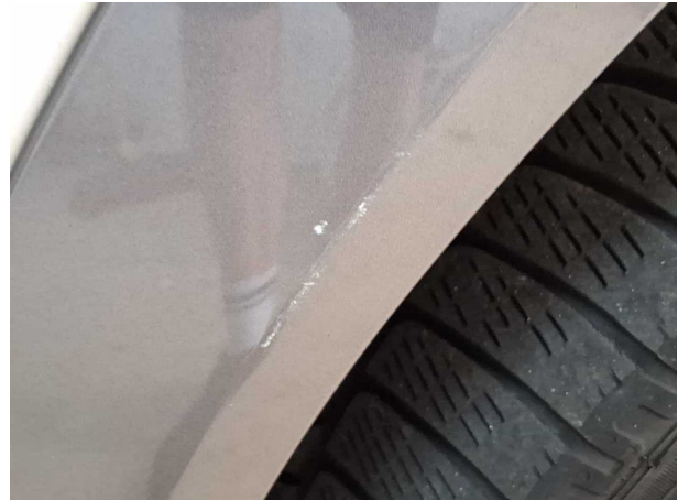
Beschädigung #2: Kotflügel links: Radhausverbreiterung - verkratzt / verschürft - erneuern
