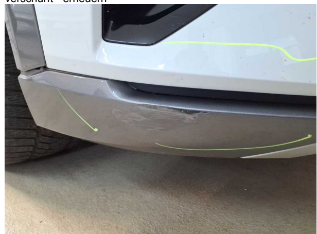
Beschädigung #4: Stossfänger vorn: Spoiler - verkratzt / verschürft - erneuern
