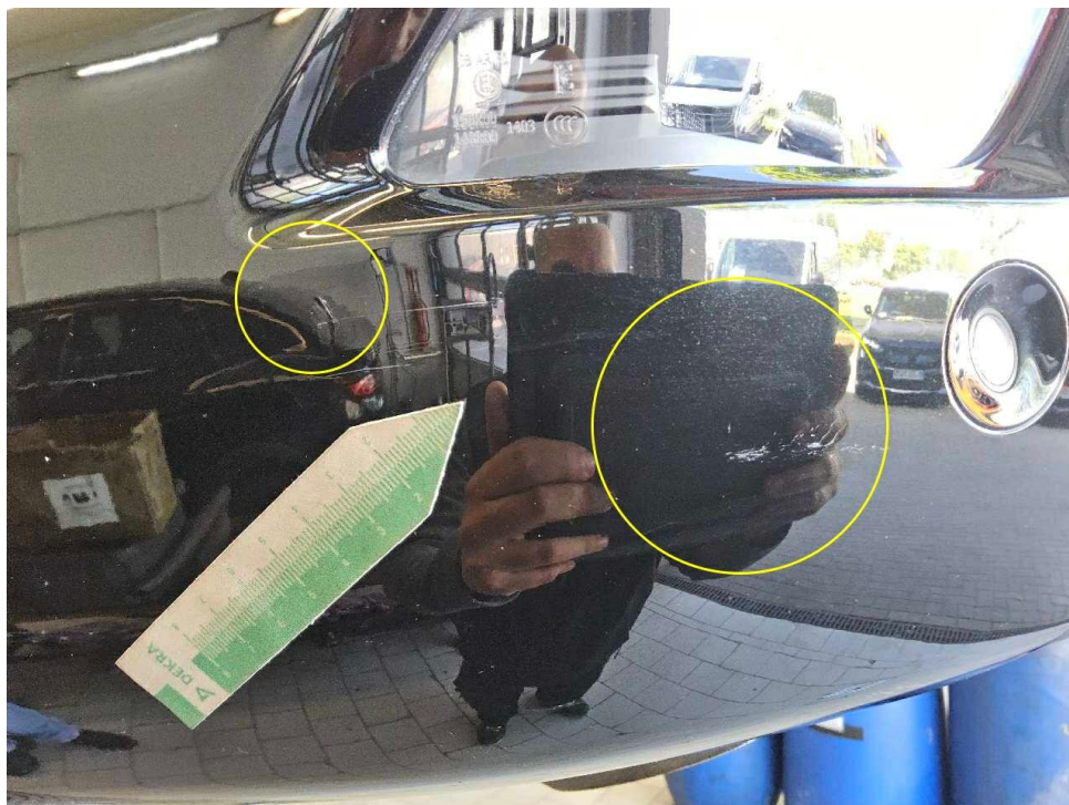
Bild 10 : Stoßfänger hinten Unterteil, verschrammt
