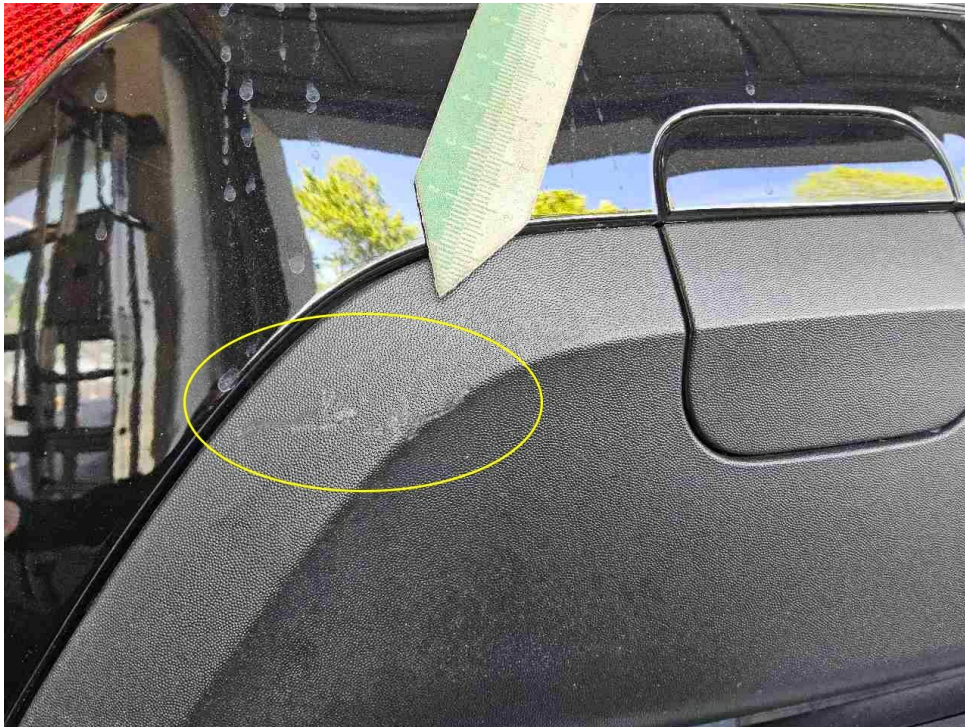
Bild 11 : Abdeckung Stoßfänger hinten Unterteil, verschrammt
