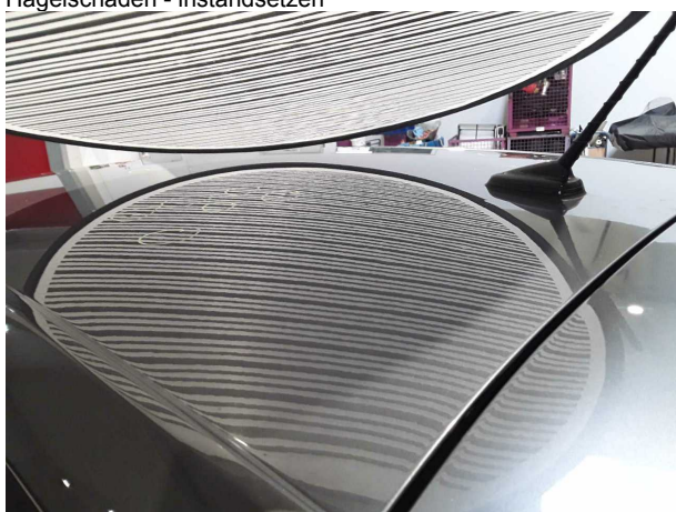
Beschädigung #4: Karosserie: Karosserie (39 Dellen) - Hagelschaden - instandsetzen
