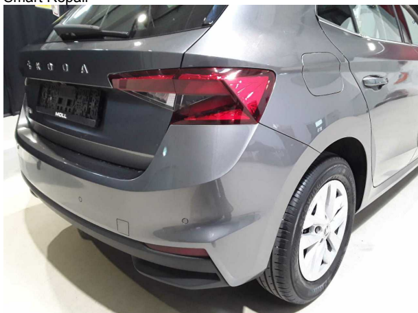
Beschädigung #2: Stossfänger hinten: Stossfänger hinten - Kratzer - lackieren
