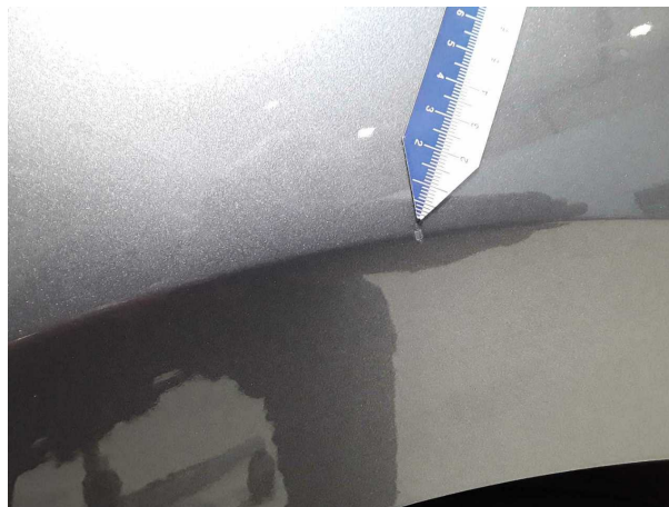
Beschädigung #1: Seitenwand rechts: Seitenwand - Kratzer - Smart Repair
