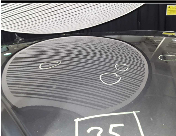
Beschädigung #4: Karosserie: Karosserie (39 Dellen) - Hagelschaden - instandsetzen
