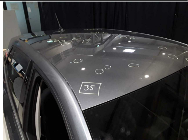
Beschädigung #4: Karosserie: Karosserie (39 Dellen) - Hagelschaden - instandsetzen
