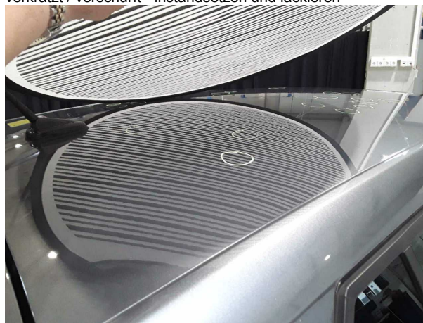
Beschädigung #4: Karosserie: Karosserie (39 Dellen) - Hagelschaden - instandsetzen
