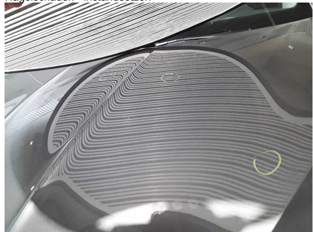
Beschädigung #4: Karosserie: Karosserie (39 Dellen) - Hagelschaden - instandsetzen
