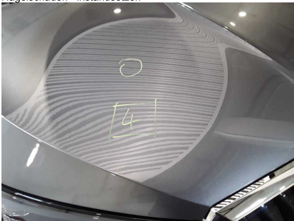
Beschädigung #4: Karosserie: Karosserie (39 Dellen) - Hagelschaden - instandsetzen
