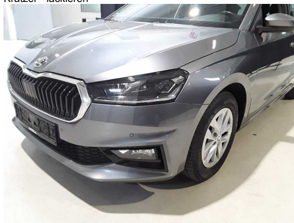
Beschädigung #3: Stossfänger vorn: Stossfänger vorn - verkratzt / verschürft - instandsetzen und lackieren
