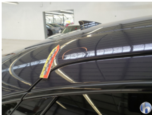
4. Dachrahmen - Rechts 1 Delle - Sanft Instandsetzen
