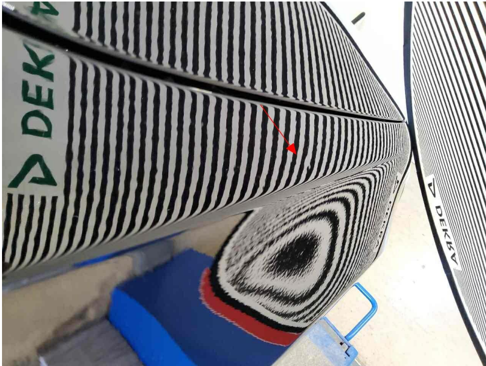
Bild 23 : Hagelschaden Kotföhlge vorne recht
