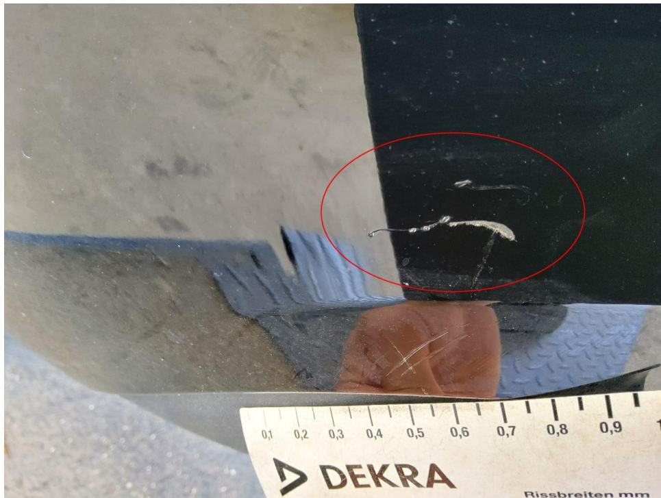
Bild 17 : Stoßfänger hinten Lackierung, verschrammt, lackieren mit Lackaufbau
