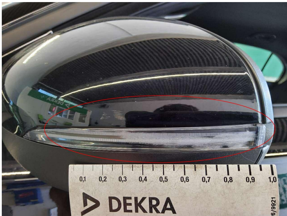
Bild 18 : Blinker Außenspiegel links, verschrammt Abdeckung Außenspiegel links, verschrammt
