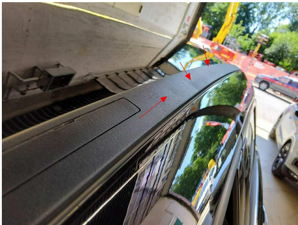
Bild 39 : Hagelschaden Dachleiste links
