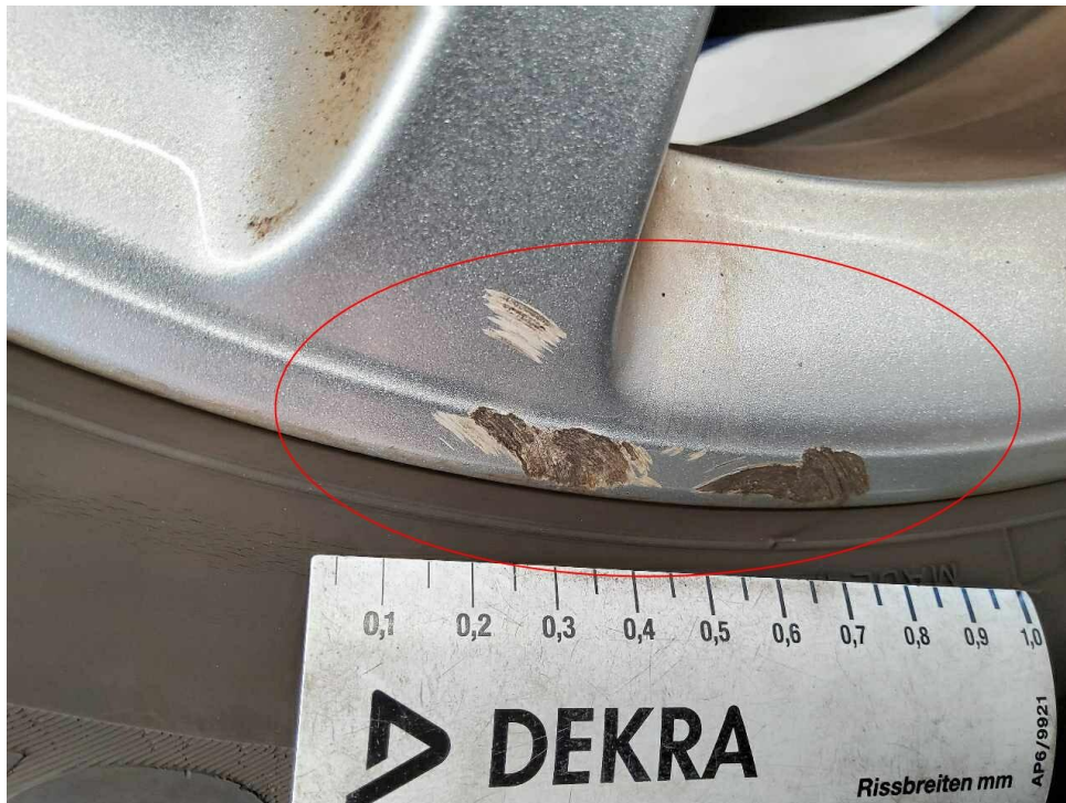
Bild 19 : LM-Felge vorne rechts, verschrammt
