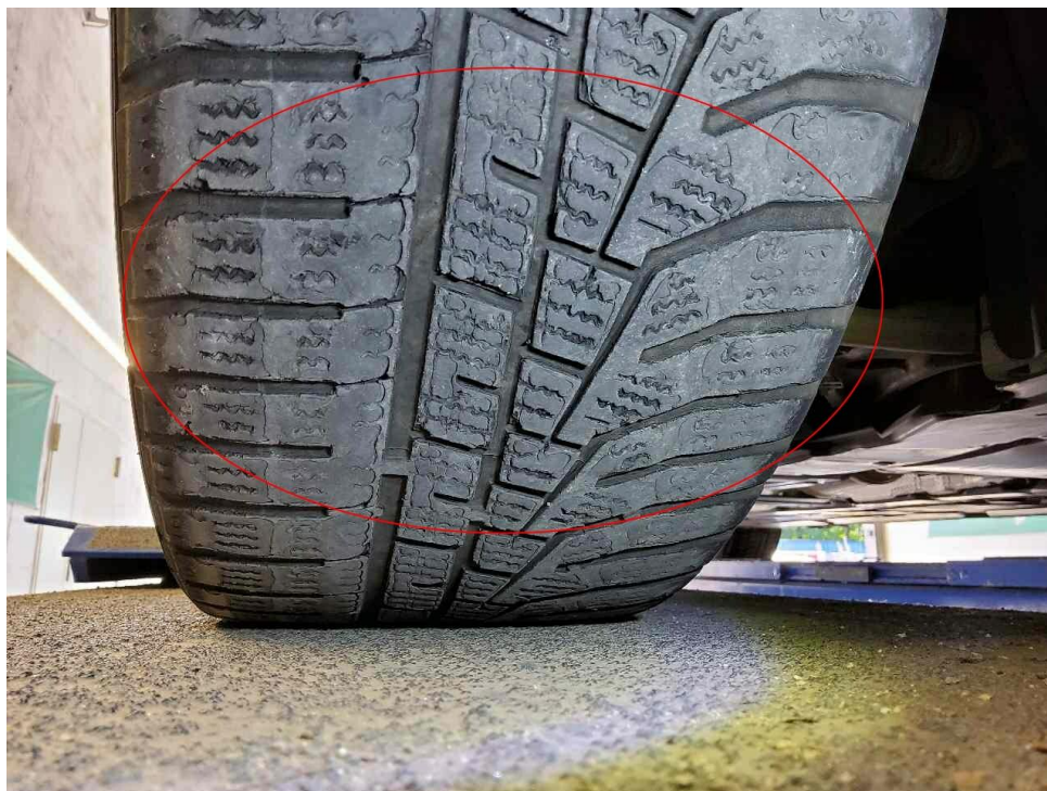
Bild 45 : Reifen vorne rechts, verschlissen
