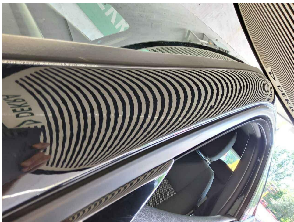
Bild 32 : Hagelschaden Dachrahmen links
