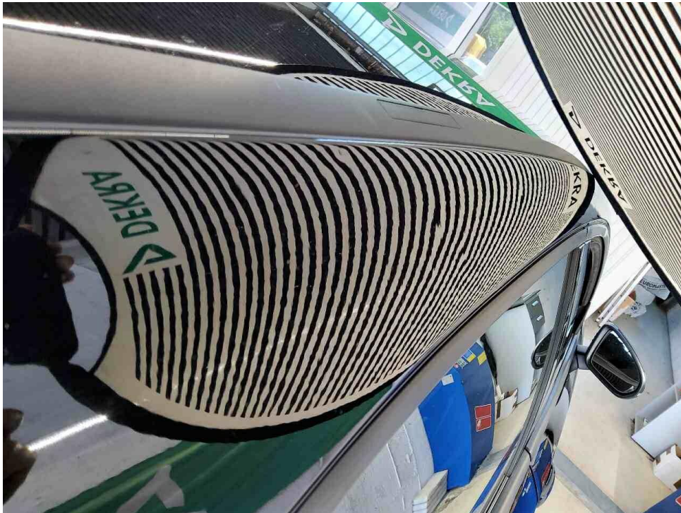
Bild 27 : Hagelschaden Dachrahmen rechts
