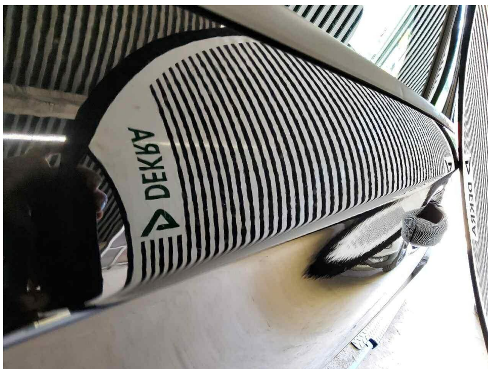
Bild 34 : Hagelschaden Tür hinten links
