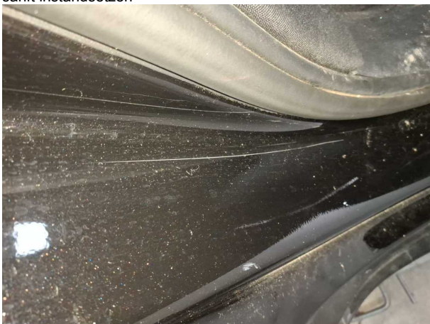
Beschädigung #3: Seitenwand rechts: Einstieg - Kratzer - Smart Repair
