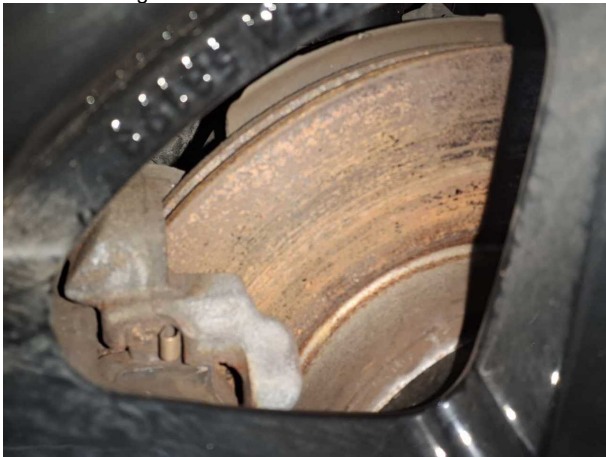
Beschädigung #6: Bremsanlage: Bremsscheiben und Beläge vorn - Korrosion - erneuern
