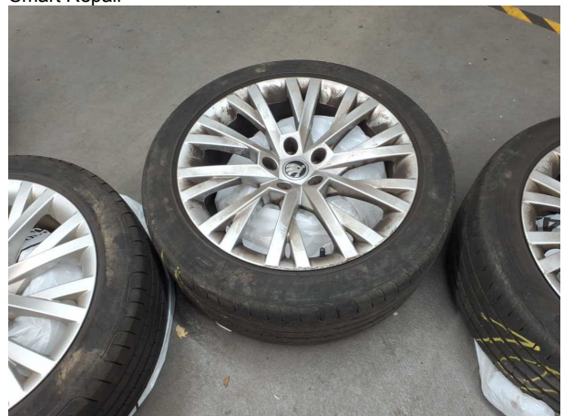
Beschädigung #4: 2.Radsatz: 1 Leichtmetallfelge - beschädigt - Wertminderung
