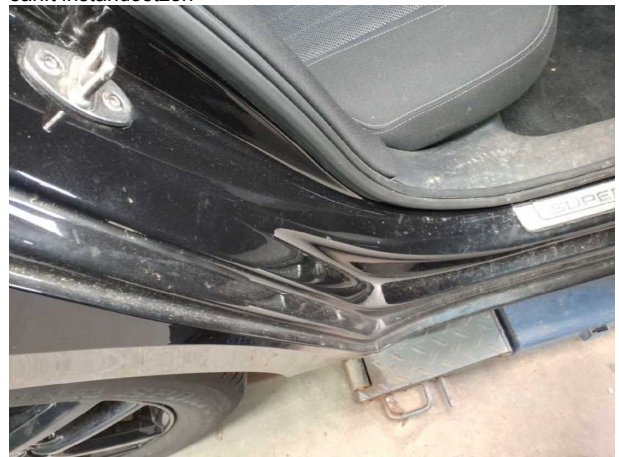
Beschädigung #3: Seitenwand rechts: Einstieg - Kratzer - Smart Repair
