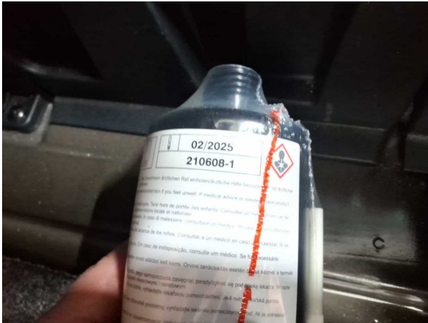
Beschädigung #1: Ausrüstung: Tirefit Füllmittel - abgelaufen - erneuern
