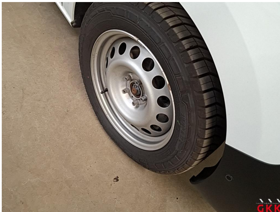
Bild 20 Radkappe(n), vorne rechts, fehlt, ersetzen
