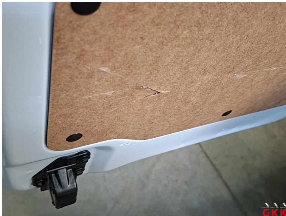
Bild 15 Hecktür links, Innenverkleidung, beschädigt, ersetzen
