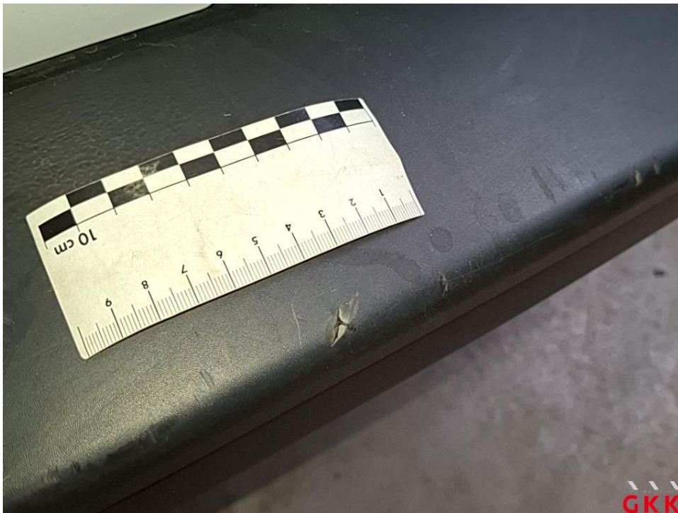
Bild 24 Stoßfänger hinten, Verkleidung -unlackiert-, beschädigt, ersetzen
