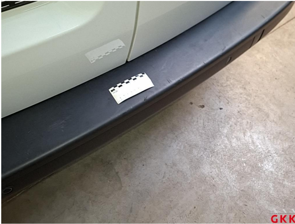
Bild 23 Stoßfänger hinten, Verkleidung -unlackiert-, beschädigt, ersetzen
