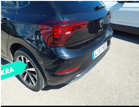
Paragolpes / Trasero / Abolladura
