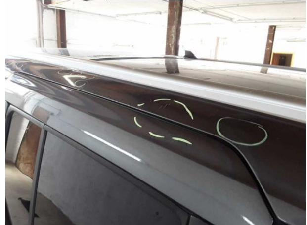
Beschädigung #6: Fahrzeugdach: Dachholm rechts - verkratzt / verschürft - Smart Repair
