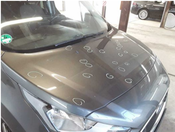
Damage #17: Body: Body (Mehrkosten möglich) - Damage by hail - Repair
