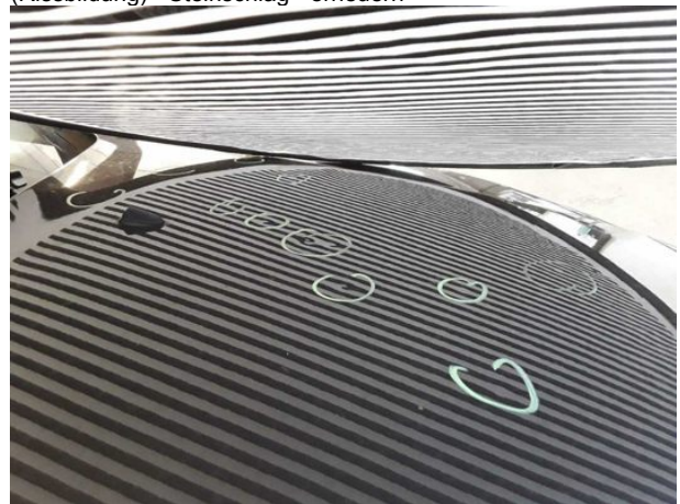
Beschädigung #17: Karosserie: Karosserie (Mehrkosten möglich...) Hagelschaden - instandsetzen
