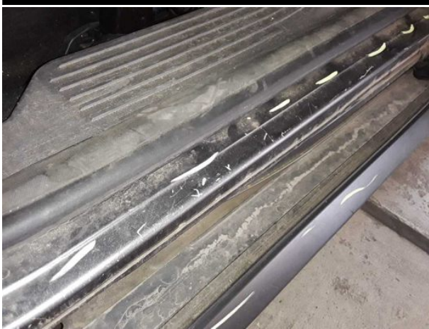
Beschädigung #10: Seitenwand links: Einstieg - verkratzt / verschürft - instandsetzen und lackieren
