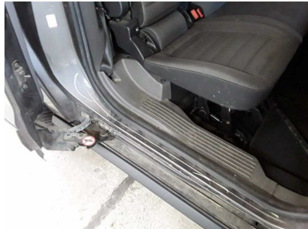
Beschädigung #11: Seitenwand rechts: Einstieg - verkratzt / verschürft - instandsetzen und lackieren
