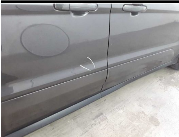
Beschädigung #13: Schiebetür rechts: Schiebetür mit Glasschei... - verkratzt / verschürft - instandsetzen und lackieren
