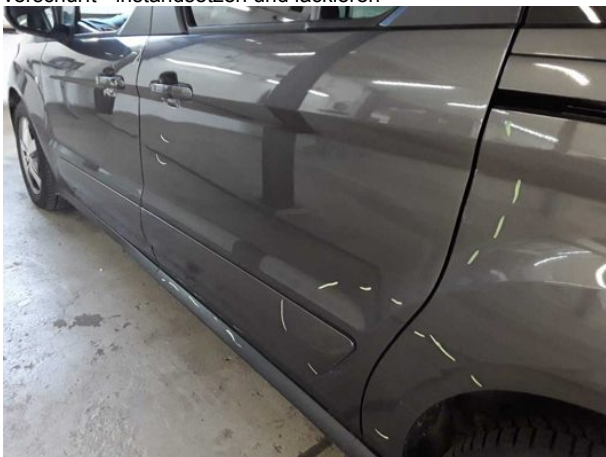
Beschädigung #12: Schiebetür links: Schiebetür mit Glasscheibe - verkratzt / verschürft - instandsetzen und lackieren
