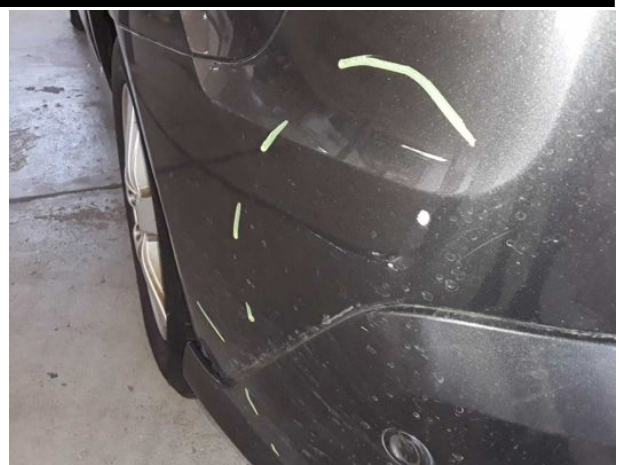
Beschädigung #15: Stossfänger hinten: Stossfänger hinten (Verformt) - verkratzt / verschürft - erneuern
