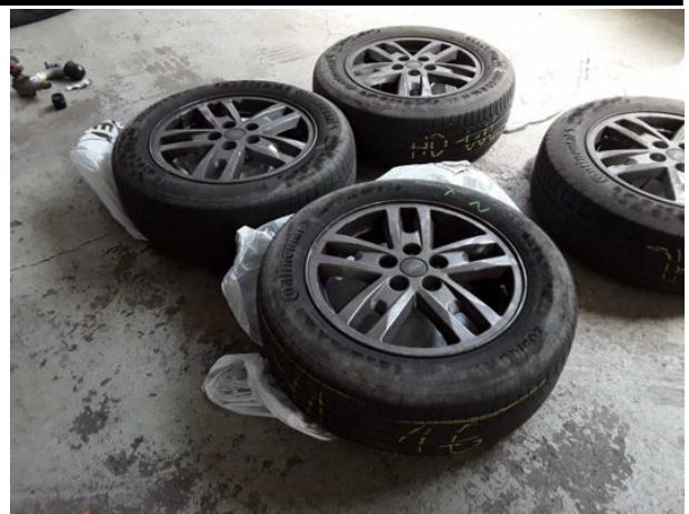
Beschädigung #8: 2.Radsatz: 2 Reifen - verschlissen - erneuern
