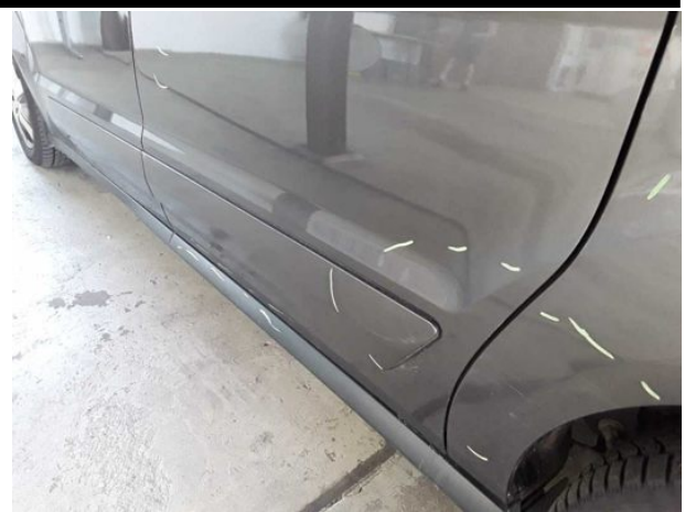
Beschädigung #5: Tür hinten links: Zierleiste unten - verkratzt / verschürft - Smart Repair
