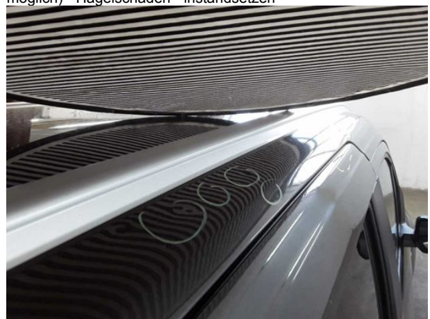
Beschädigung #17: Karosserie: Karosserie (Mehrkosten möglich...) Hagelschaden - instandsetzen
