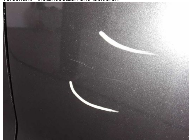
Beschädigung #12: Schiebetür links: Schiebetür mit Glasscheibe - verkratzt / verschürft - instandsetzen und
