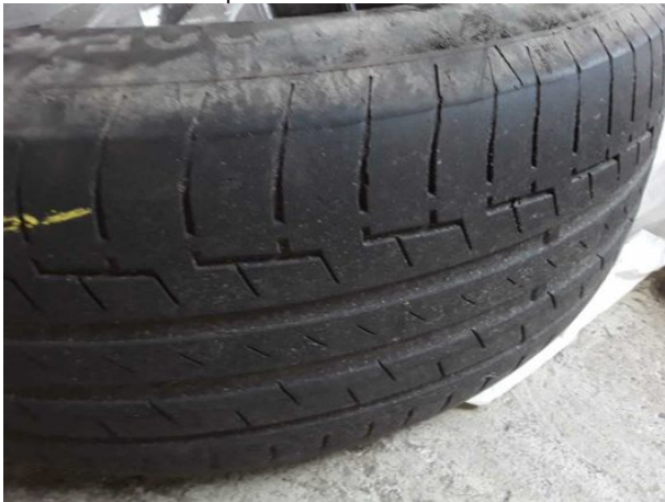
Beschädigung #8: 2.Radsatz: 2 Reifen - verschlissen - erneuern
