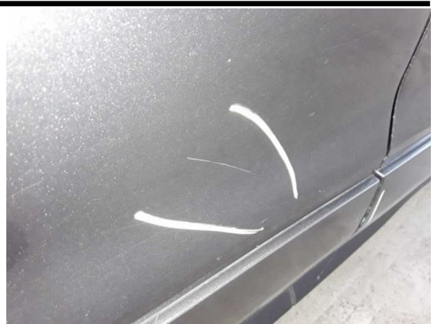
Beschädigung #13: Schiebetür rechts: Schiebetür mit Glasscheibe - verkratzt / verschürft - instandsetzen und
