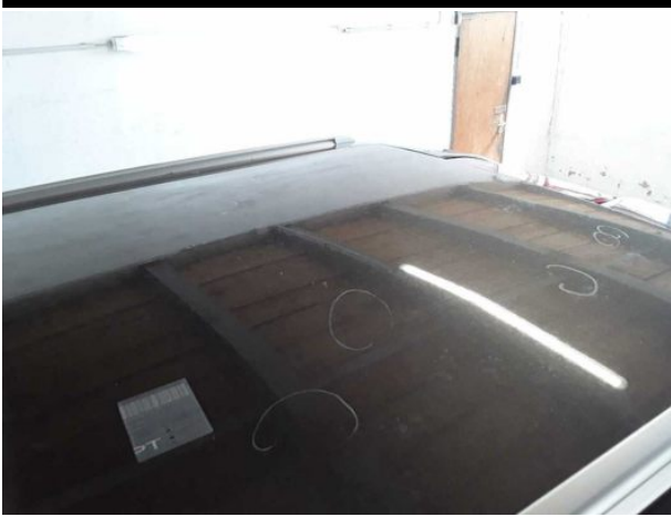
Beschädigung #17: Karosserie: Karosserie (Mehrkosten möglich... Hagelschaden - instandsetzen
