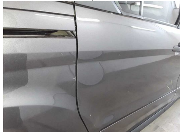
Beschädigung #7: Seitenwand rechts: Seitenwand - verkratzt / verschürft - Smart Repair
