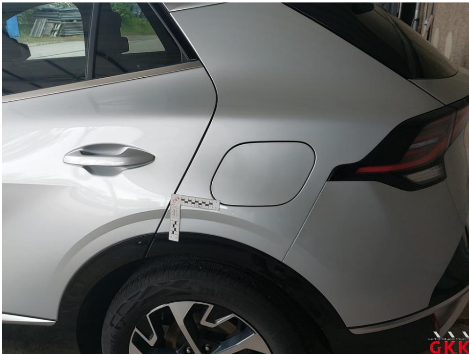
Bild 14. Seitenwand links, verkratzt, lackieren
