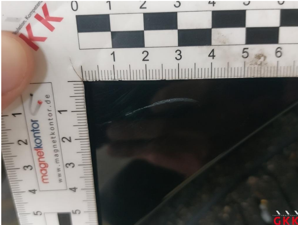
Bild 19. Tür hinten links, Leiste, Radlauf, verkratzt, ersetzen
