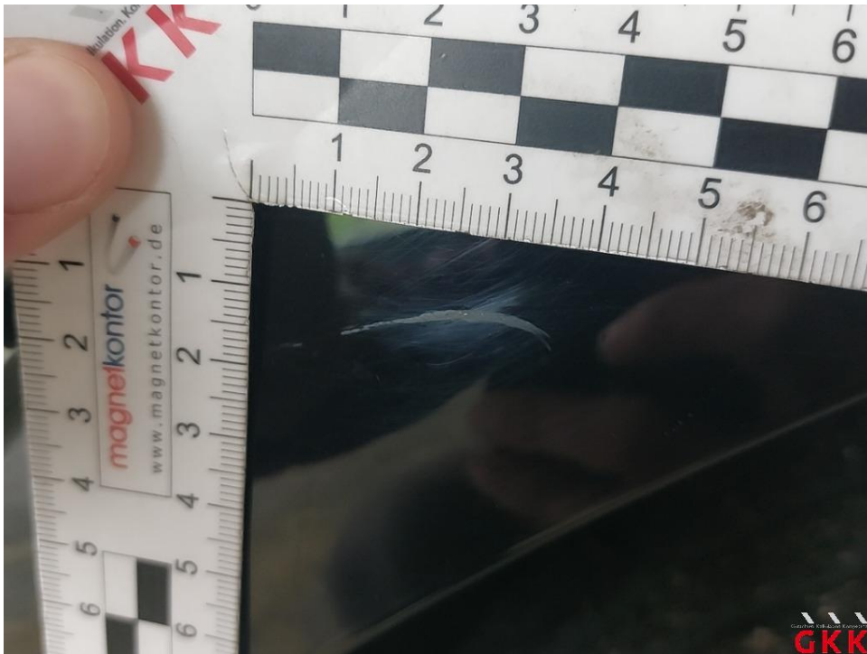
Bild 18. Tür hinten links, Leiste, Radlauf, verkratzt, ersetzen
