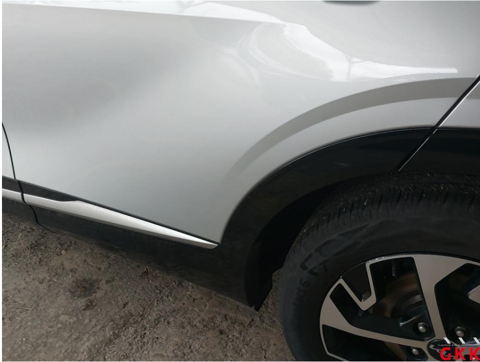
Bild 17. Tür hinten links, Leiste, Radlauf, verkratzt, ersetzen
