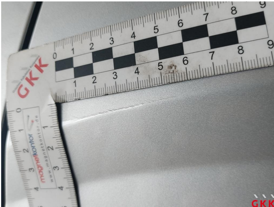
Bild 16. Seitenwand links, verkratzt, lackieren
