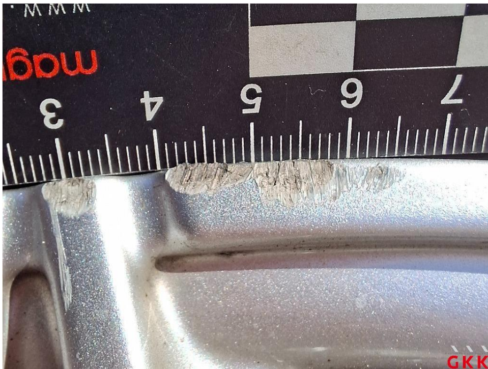
Bild 14. LM-Rad, 1 x beiliegend, Materialabtrag, ersetzen
