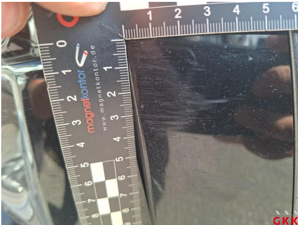
Bild 28. Stoßfänger vorne, Blende -unlackiert-, verkratzt, ersetzen
