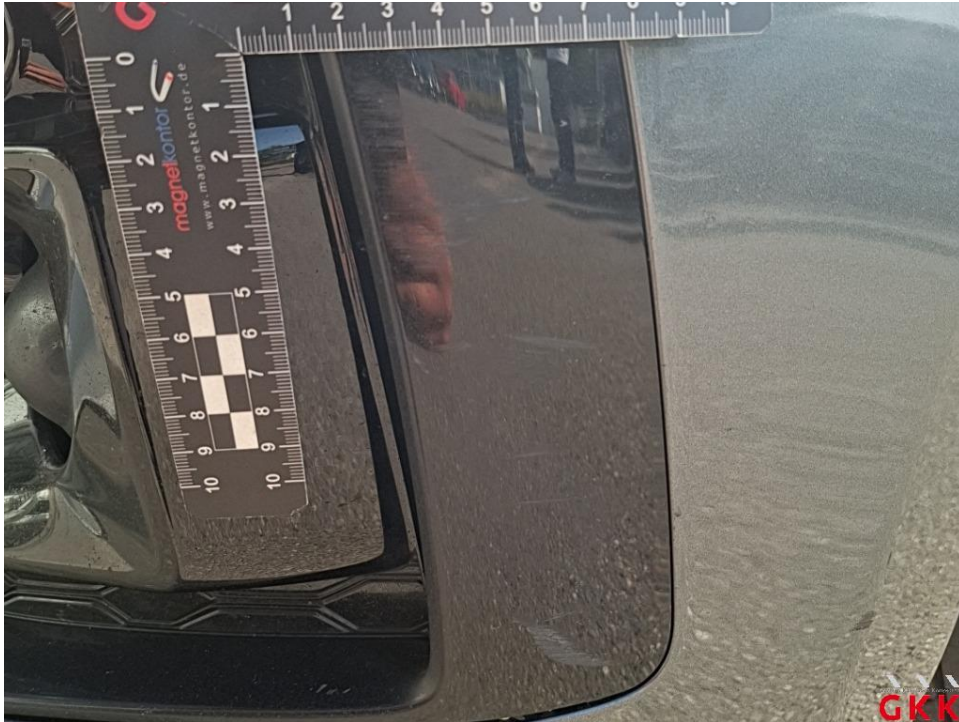
Bild 27. Stoßfänger vorne, Blende -unlackiert-, verkratzt, ersetzen
