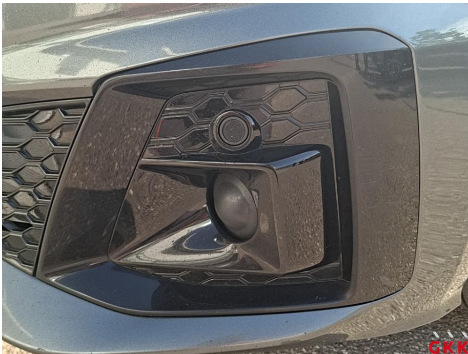
Bild 26. Stoßfänger vorne, Blende -unlackiert-, verkratzt, ersetzen
