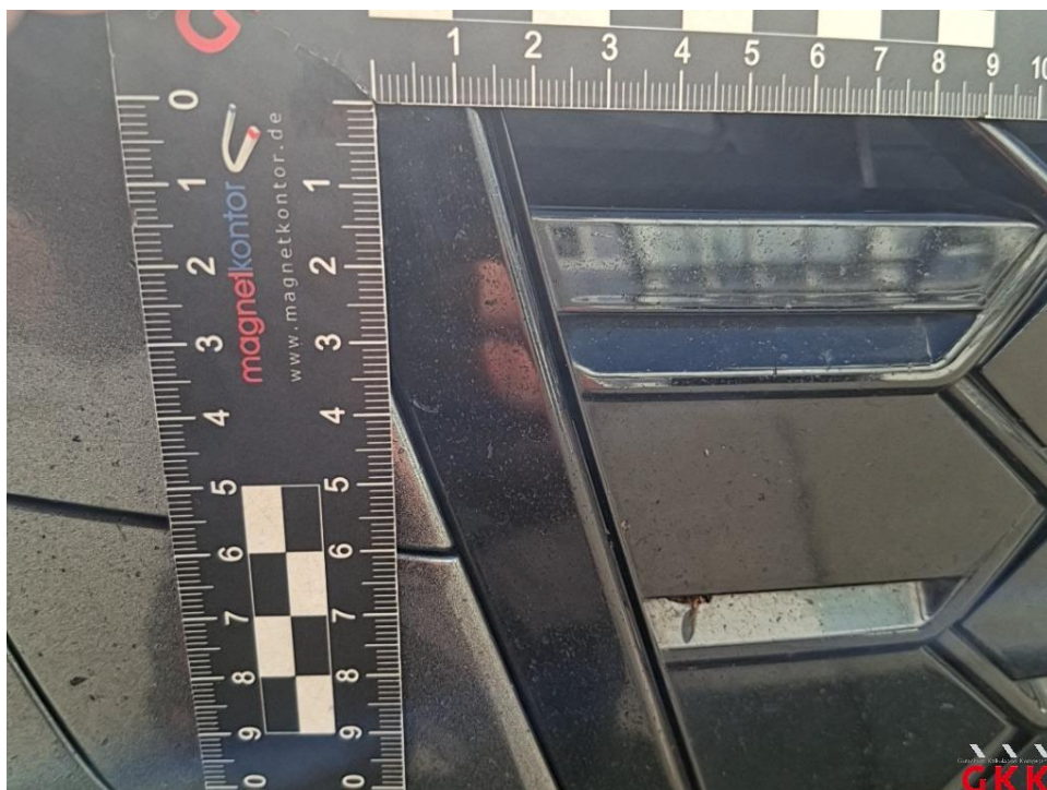
Bild 33. Frontgrill, Steinschlag, ersetzen
