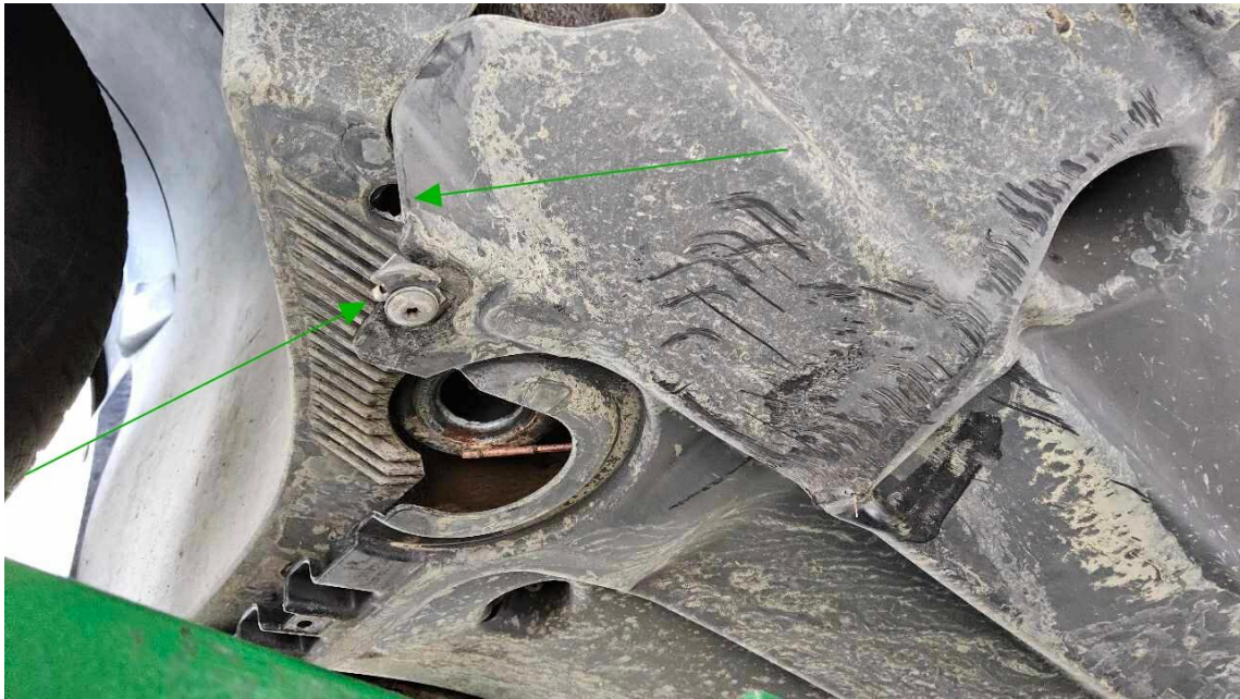
Bild 49 : Unterbodenverkleidung mitte rechts und Radhausschale vorne rechts, gebrochen
