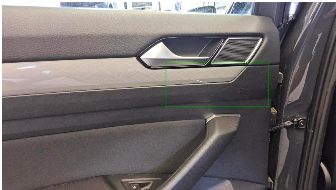
Bild 18 : Verkleidung Tür hinten links, verschrammt, Gebrauchsspur
