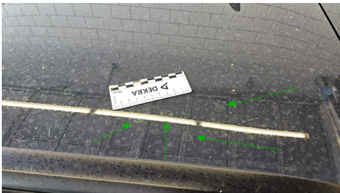
Bild 28 : Dach Lackierung, Umweltschaden, lackieren
