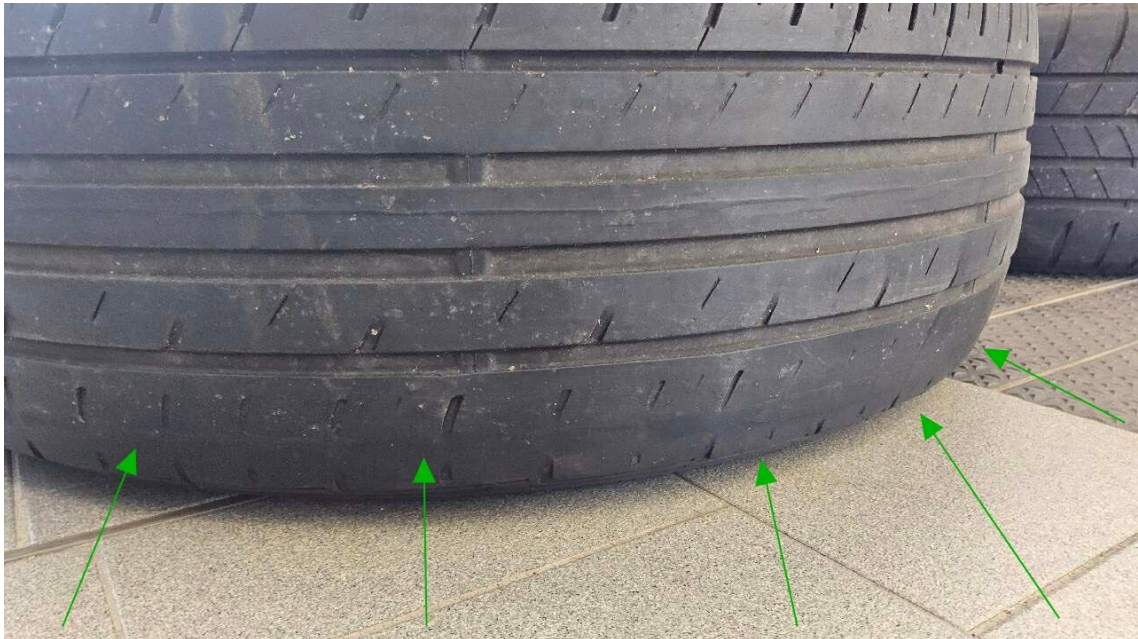
Bild 51 : Sommerreifen Vorderachse einseitig innen abgefahren, erneuern und Achsvermessung
