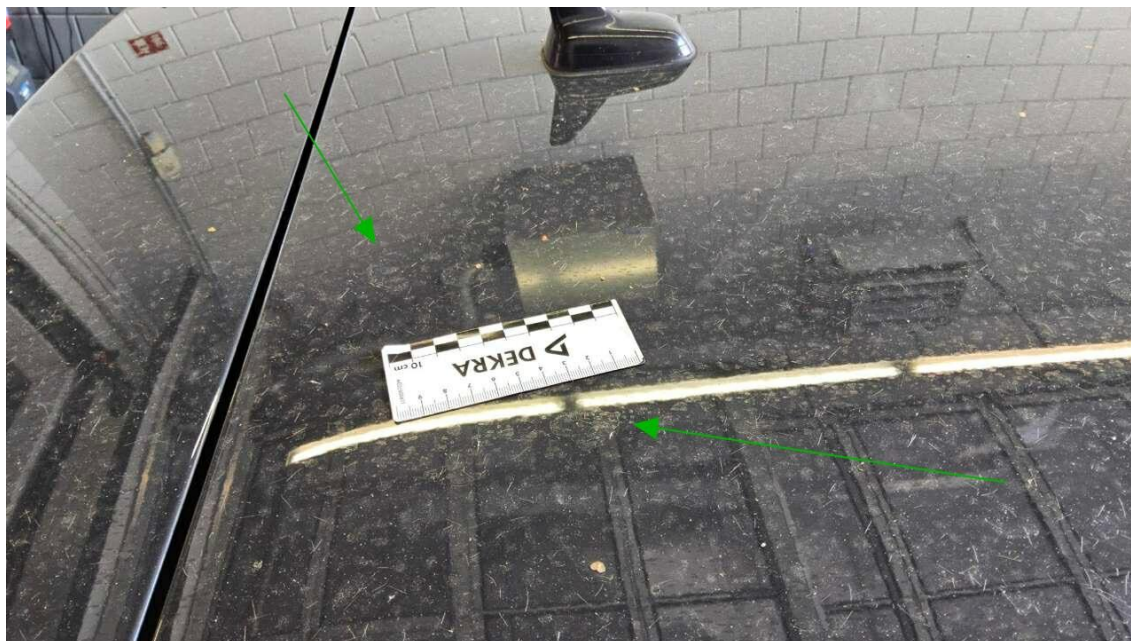
Bild 27 : Dach Lackierung, Umweltschaden, lackieren
