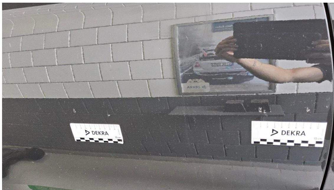
Bild 37 : Tür hinten rechts Lackierung, zerkratzt, lackieren mit Lackaufbau
