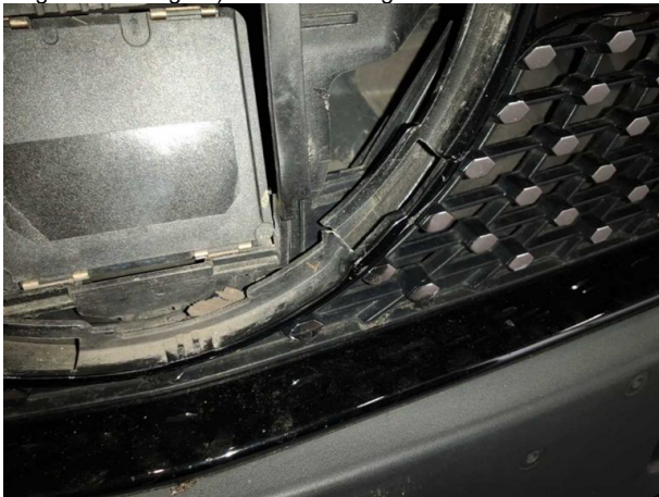
Beschädigung #7: Motorhaube: Kühlergrill - gebrochen / gerissen... erneuern
