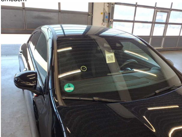
Beschädigung #9: Verglasung: Frontscheibe mit Spurhalteassistent (Mit rissbildung) - Steinschlag - erneuern
