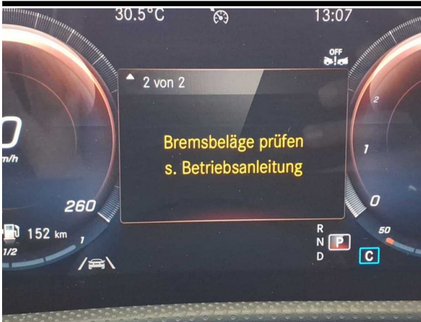
Beschädigung #5: Instrumententafel: Kontrollleuchte (Diverse Folgekosten möglich) - leuchtet - Diagnose durchführen
