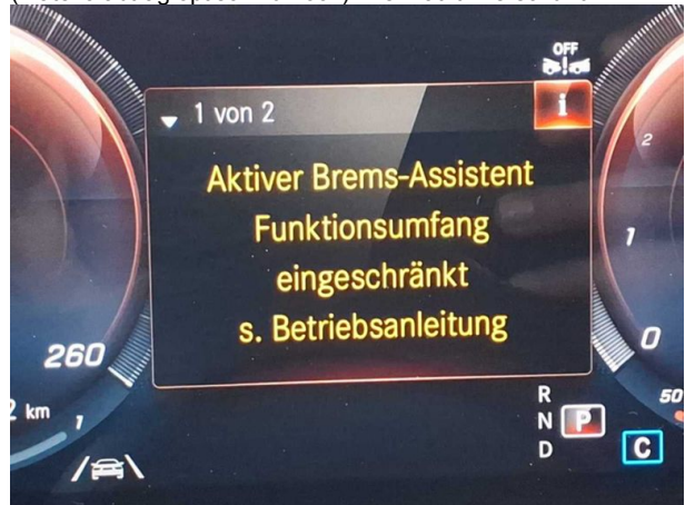
Beschädigung #5: Instrumententafel: Kontrollleuchte (Diverse Folgekosten möglich) - leuchtet - Diagnose durchführen
