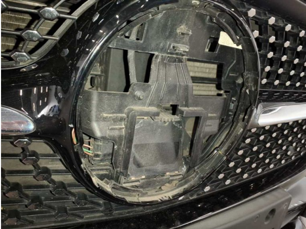
Beschädigung #1: Frontmaske: Emblem - gebrochen / gerissen - erneuern
