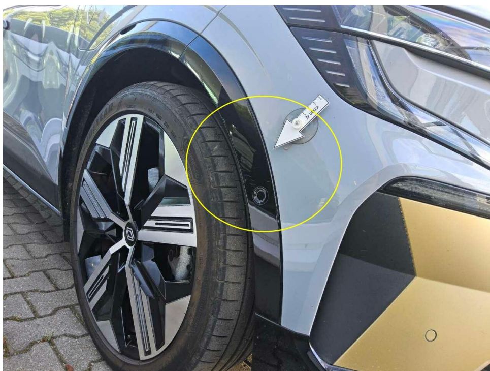
Bild 10 : Stoßfänger vorne Lackierung, verschrammt, polieren
