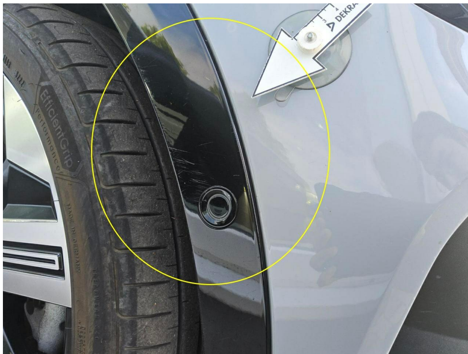
Bild 11 : Stoßfänger vorne Lackierung, verschrammt, polieren
