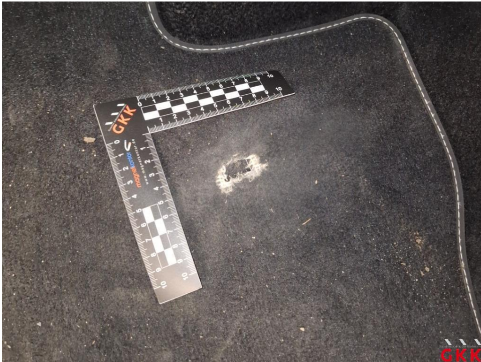
Bild 21 Fußmatte(n), vorne links, beschädigt, ersetzen
