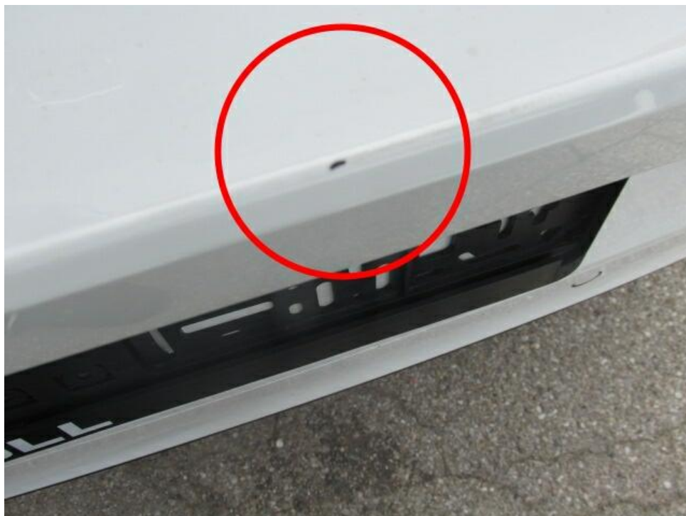
Bild 19 : Stoßfänger hinten verschrammt
