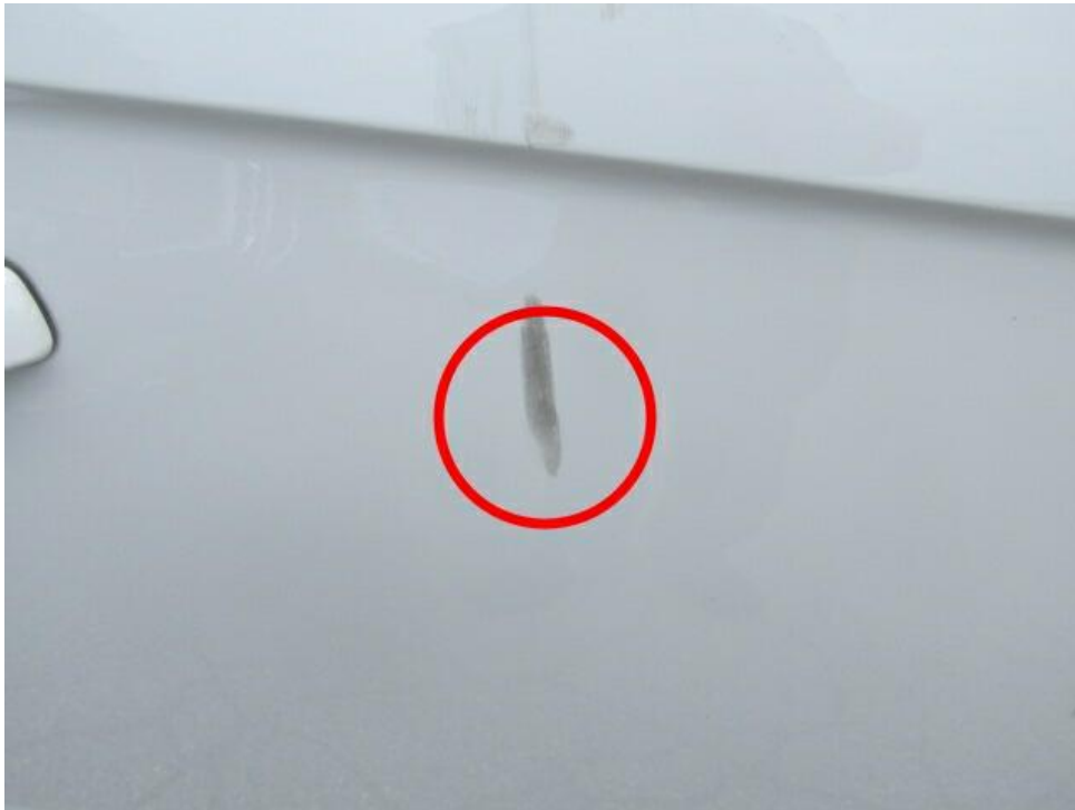
Bild 14 : Türe vorne rechts Lackanätzungen
