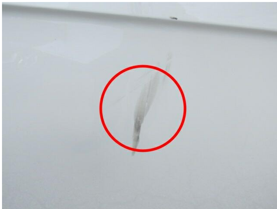
Bild 13 : Türe vorne rechts Lackanätzungen
