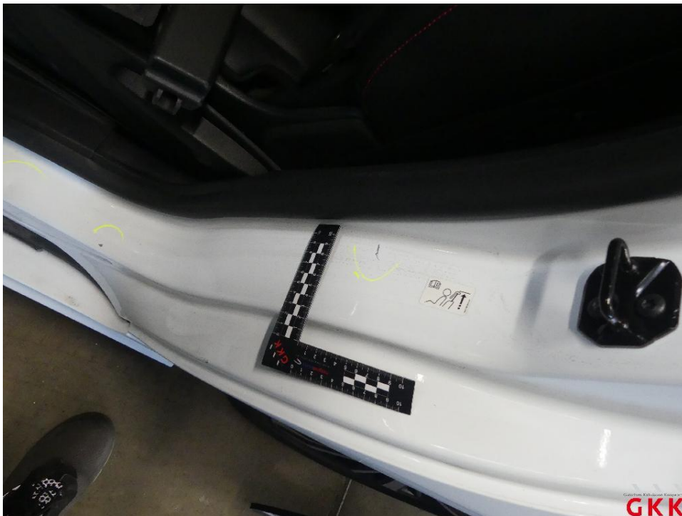
Bild 24 Tür hinten links, Einstieg, verkratzt, Smartrepair
