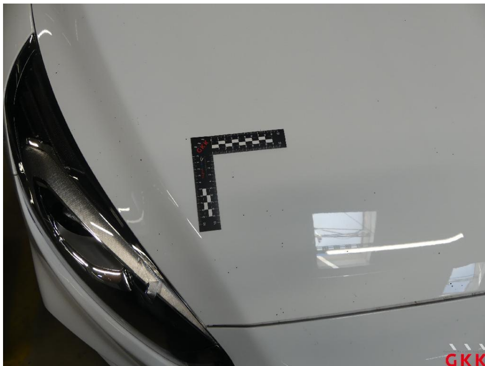
Bild 15 Motorhaube, Steinschlag, lackieren
