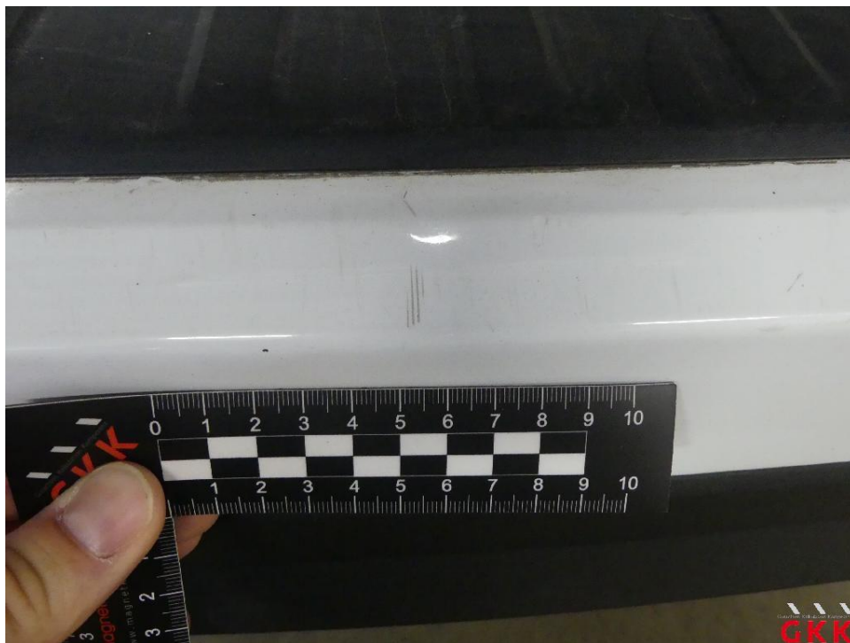
Bild 22 Stoßfänger hinten, Verkleidung -lackiert-, verkratzt, lackieren
