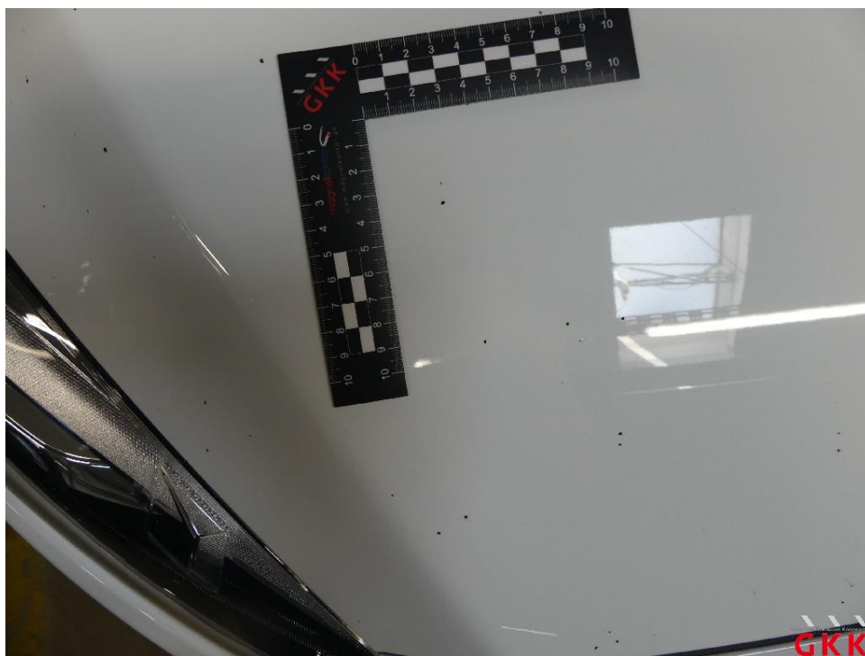
Bild 16 Motorhaube, Steinschlag, lackieren
