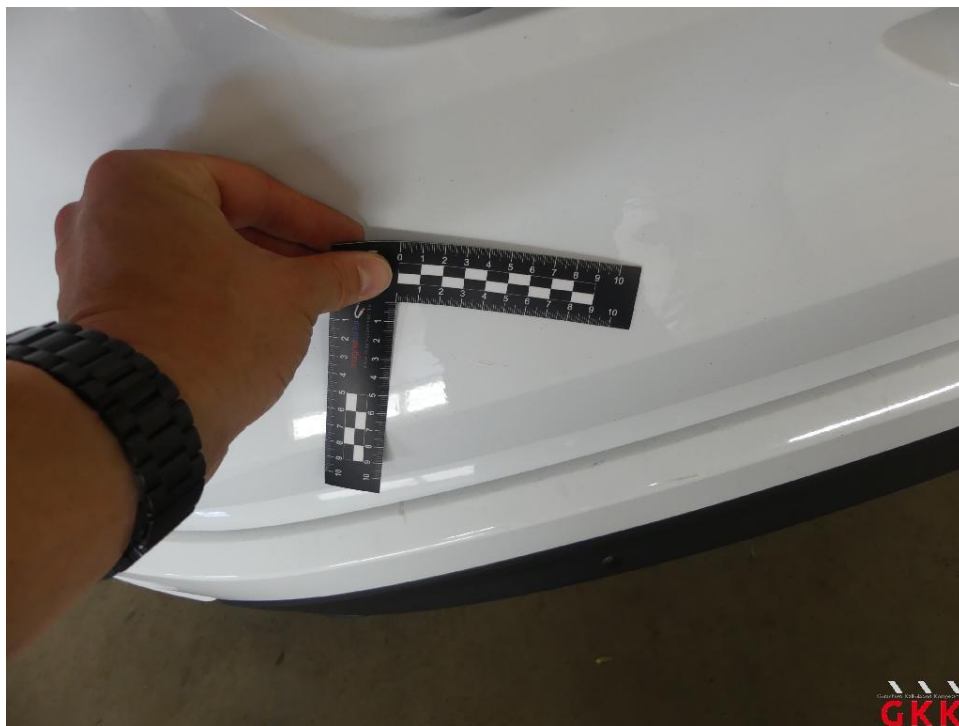
Bild 18 Heckklappe, Blende -lackiert-, verkratzt, lackieren
