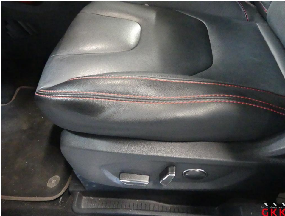
Bild 28 Sitz vorne links, Polster Sitzkissen, beschädigt, ersetzen
