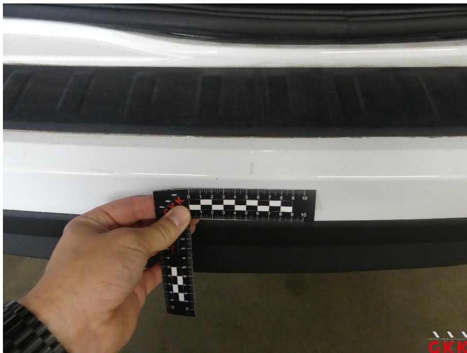
Bild 21 Stoßfänger hinten, Verkleidung -lackiert-, verkratzt, lackieren
