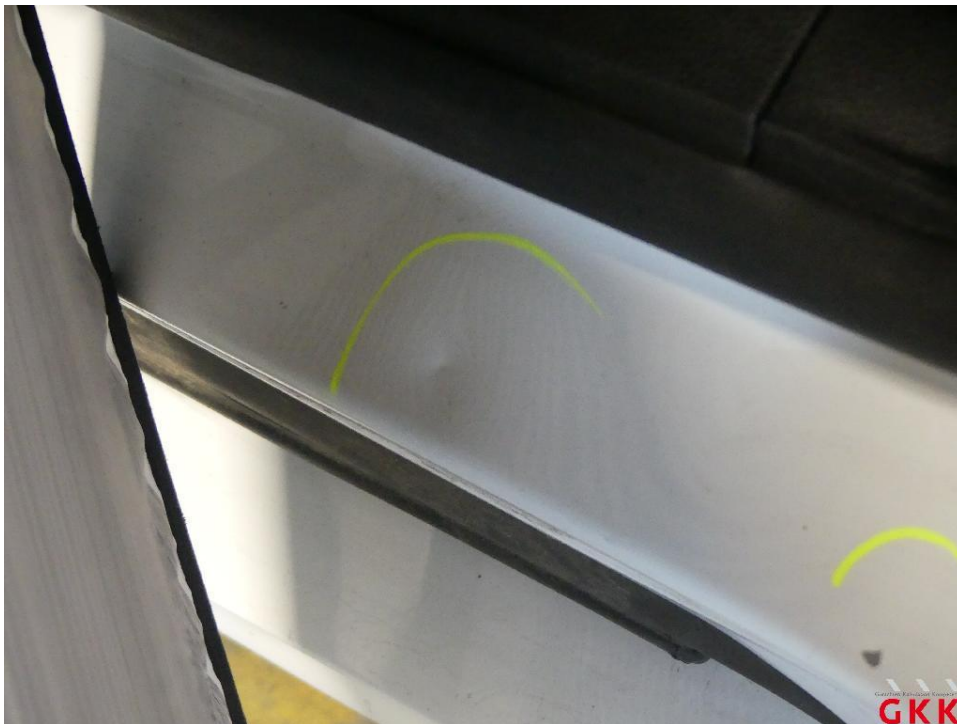
Bild 26 Tür hinten links, Einstieg, verkratzt, Smartrepair
