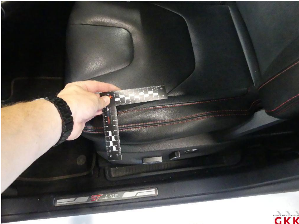
Bild 27 Sitz vorne links, Polster Sitzkissen, beschädigt, ersetzen
