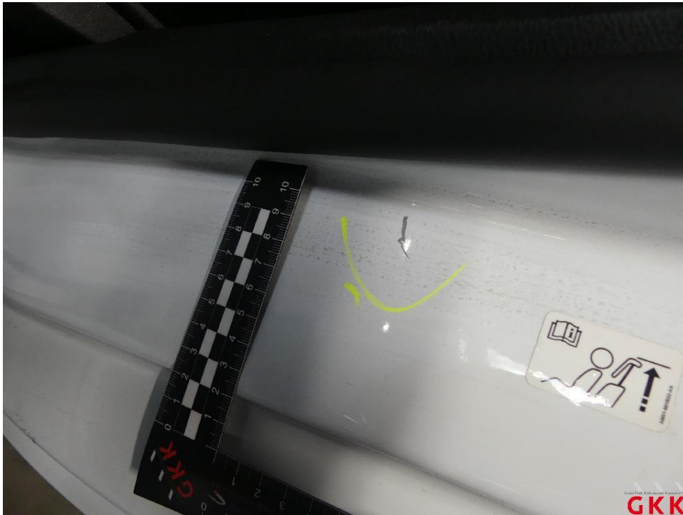
Bild 25 Tür hinten links, Einstieg, verkratzt, Smartrepair
