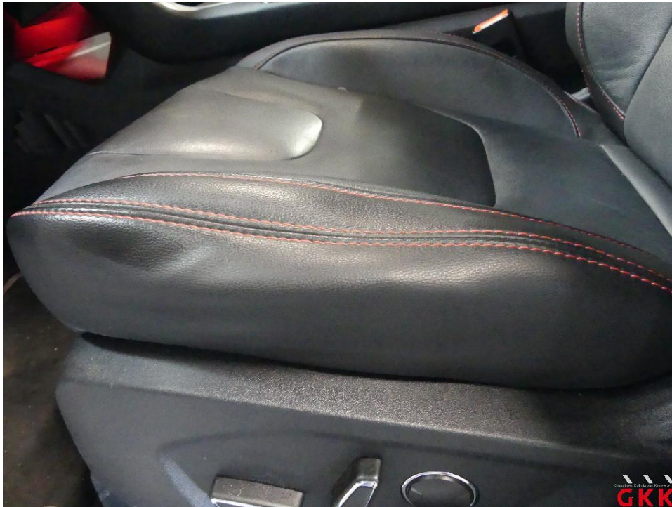
Bild 29 Sitz vorne links, Polster Sitzkissen, beschädigt, ersetzen
