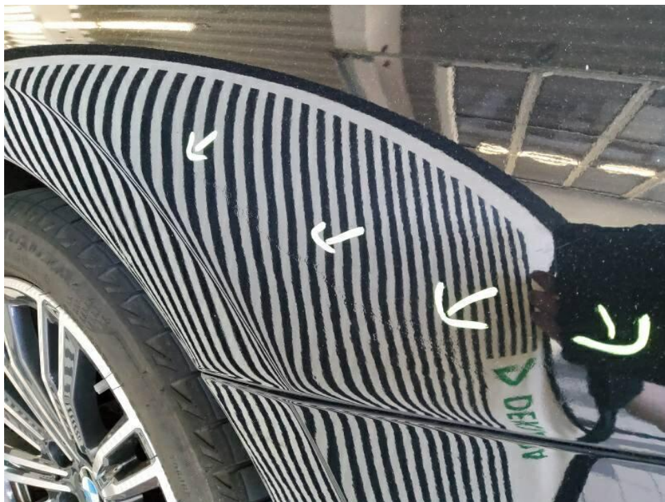
Bild 47 : Seitenwand hinten links unsachgemäß instandgesetzt - Silikoneinschlüsse / Lackfehler erkennbar
