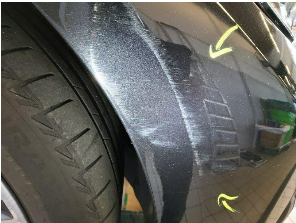
Bild 44 : Frontstoßfängerverkleidung linksseitig Lackabplatzung sowie rechts Verschrammung
