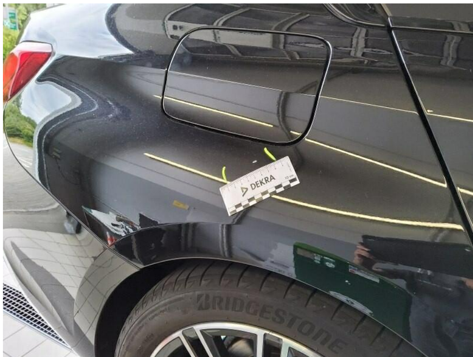
Bild 23 : Seitenwand hinten rechts "harte" Delle mit Lackbeschädigung
