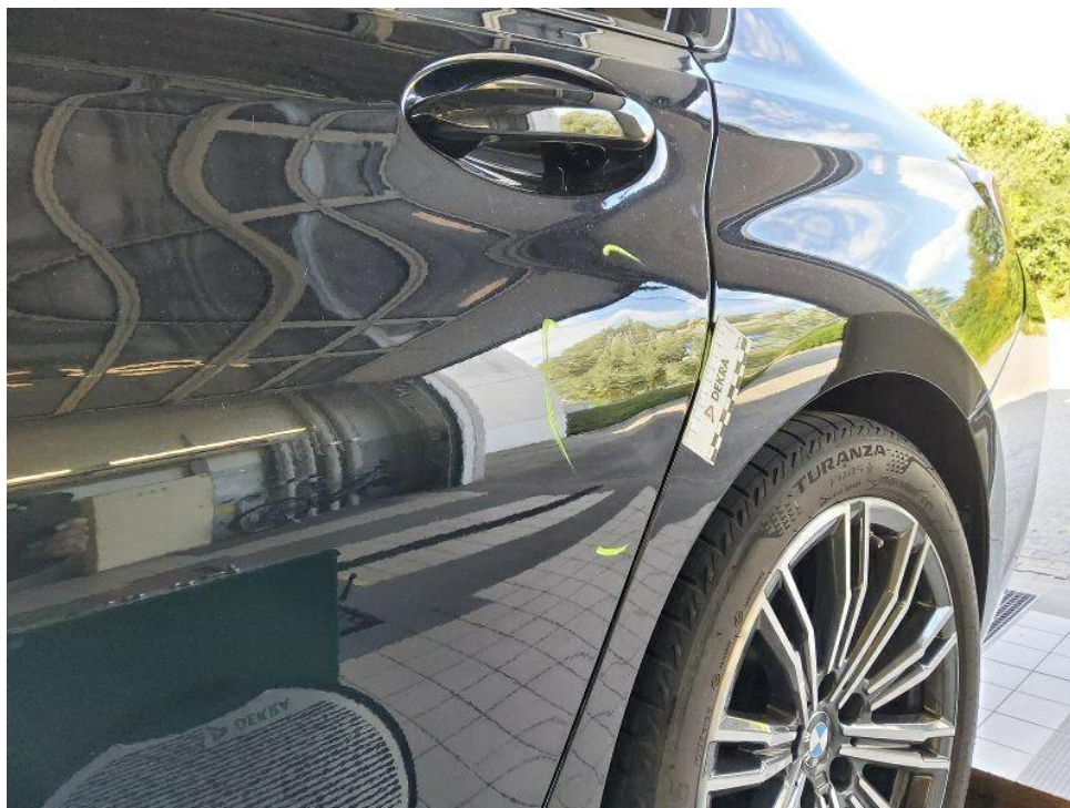
Bild 31 : Tür hinten links eingedrückt - Unfallschaden
