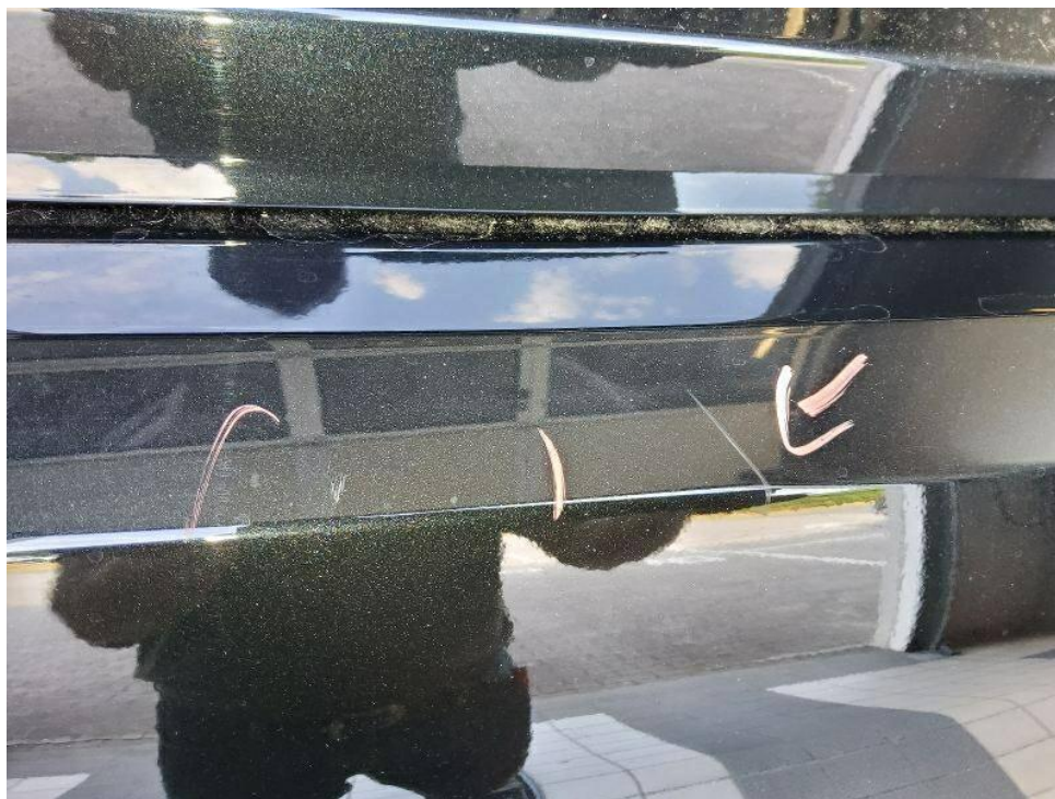
Bild 28 : Ladekante oberflächige Kratzer
