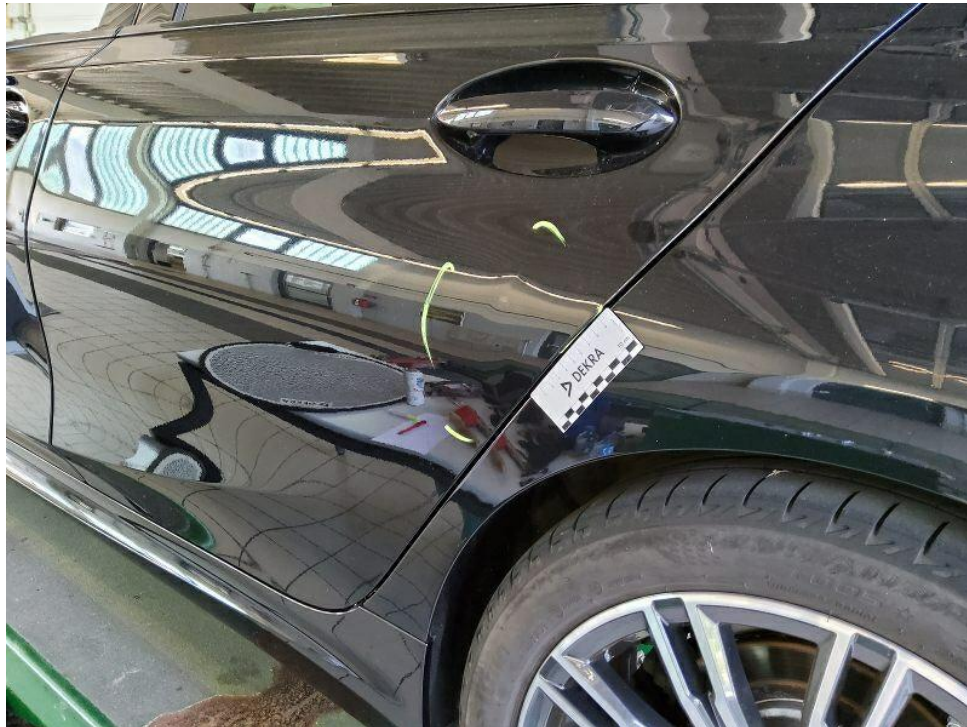
Bild 29 : Tür hinten links eingedrückt - Unfallschaden
