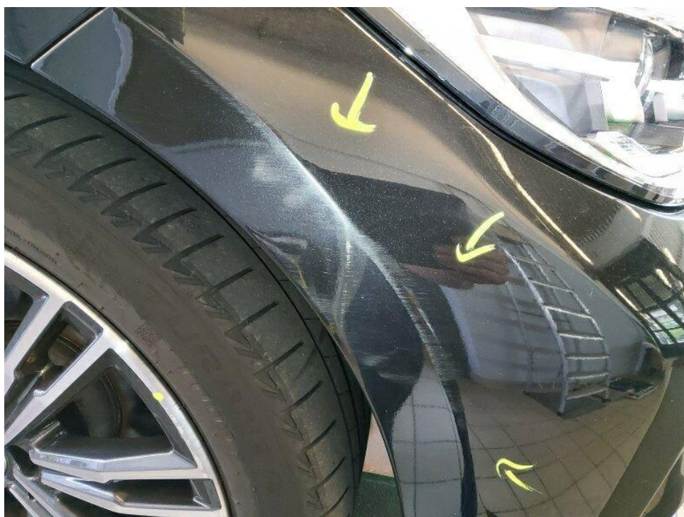
Bild 42 : Frontstoßfängerverkleidung linksseitig Lackabplatzung sowie rechts Verschrammung
