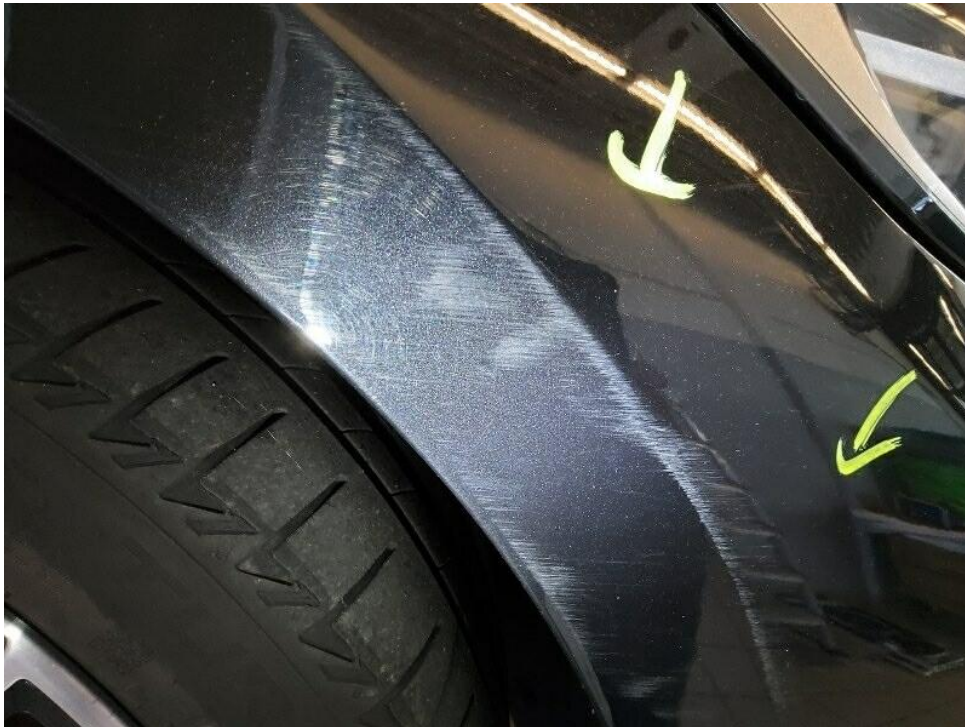
Bild 43 : Frontstoßfängerverkleidung linksseitig Lackabplatzung sowie rechts Verschrammung
