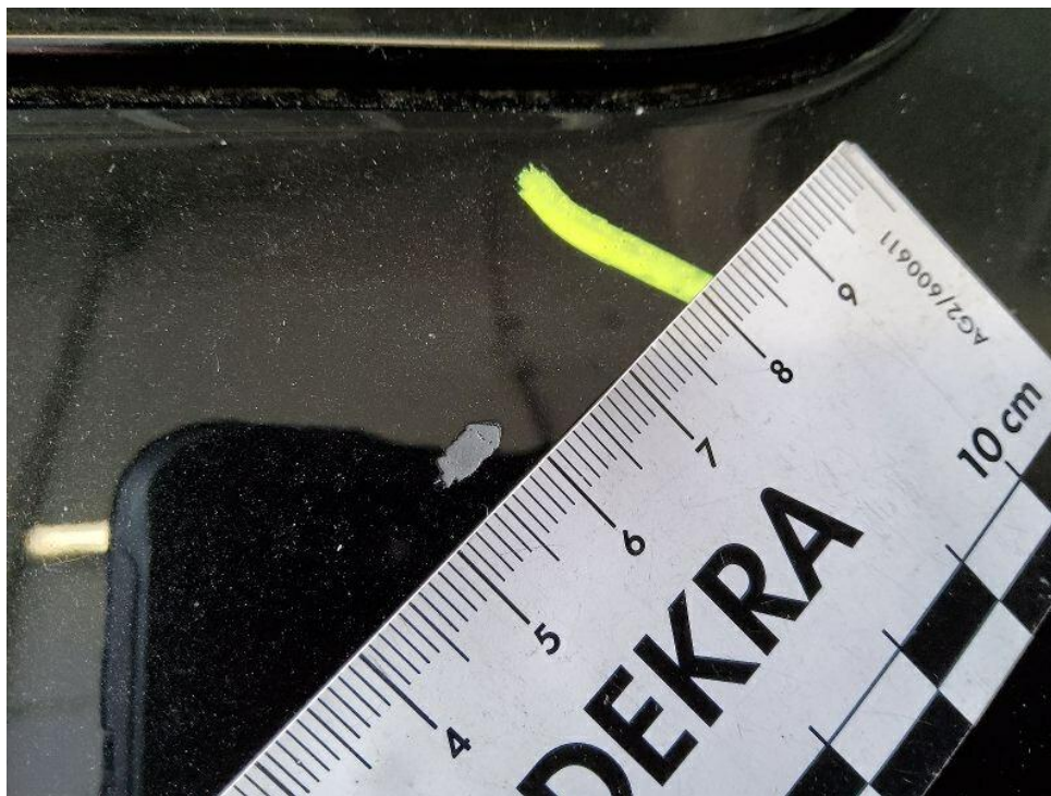
Bild 24 : Seitenwand hinten rechts "harte" Delle mit Lackbeschädigung
