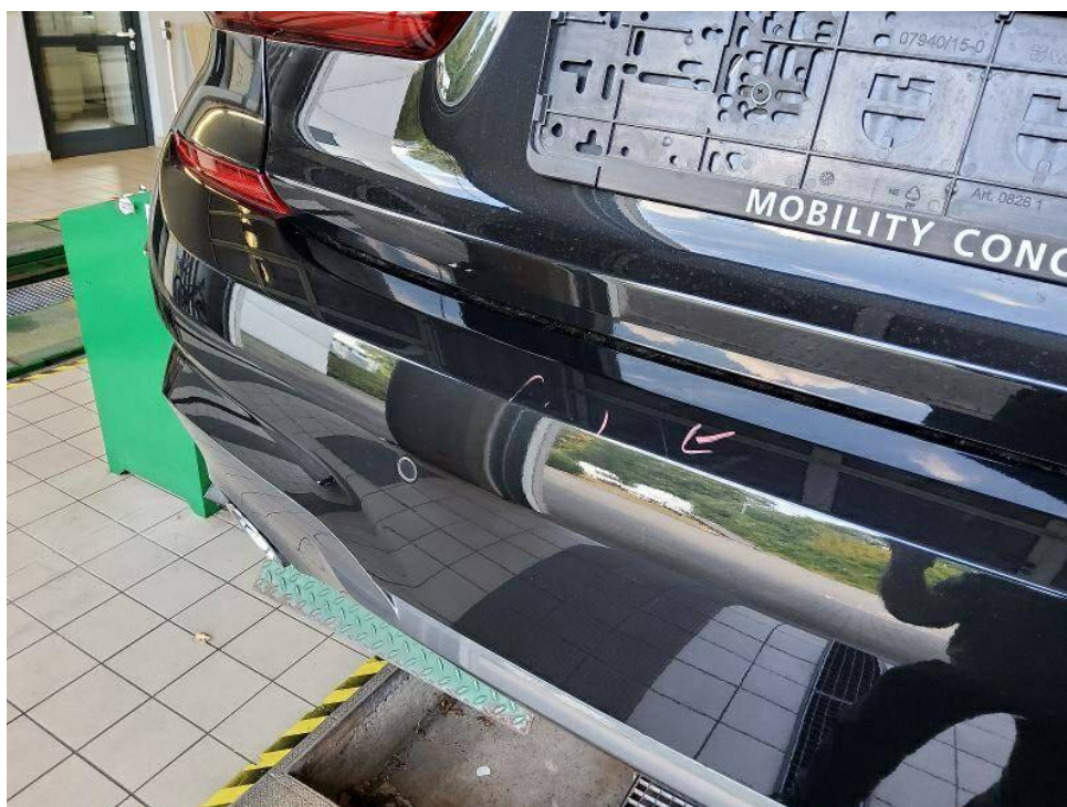
Bild 26 : Ladekante oberflächige Kratzer
