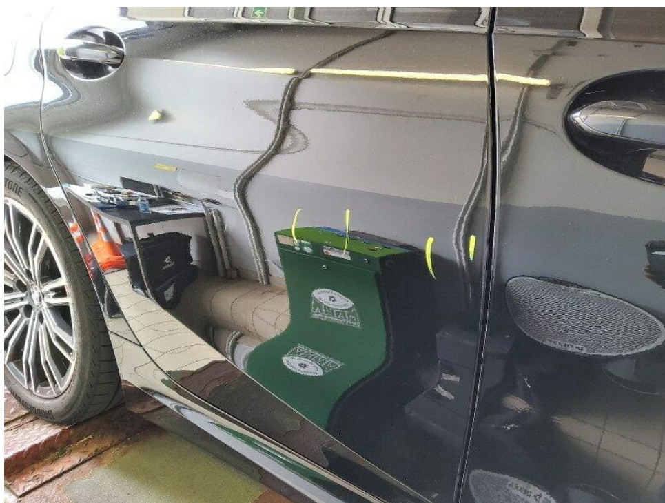
Bild 20 : Tür hinten rechts zwei "weiche" Dellen
