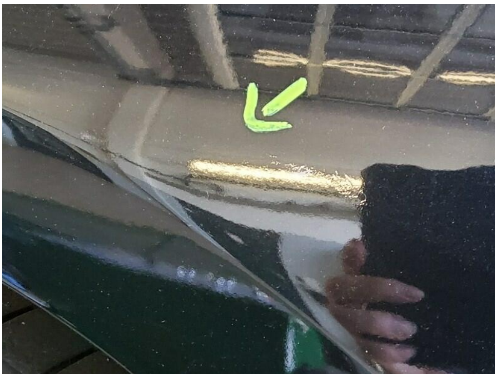
Bild 50 : Seitenwand hinten links unsachgemäß instandgesetzt - Silikoneinschlüsse / Lackfehler erkennbar
