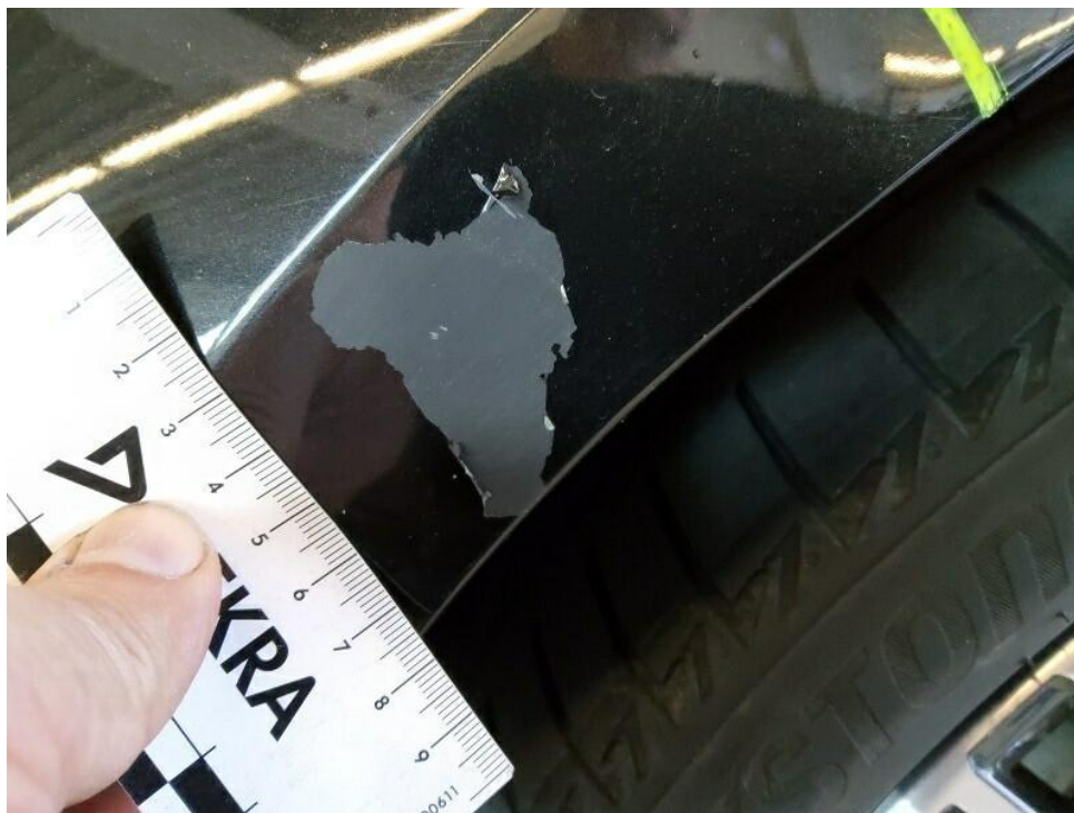
Bild 40 : Frontstoßfängerverkleidung linksseitig Lackabplatzung sowie rechts Verschrammung
