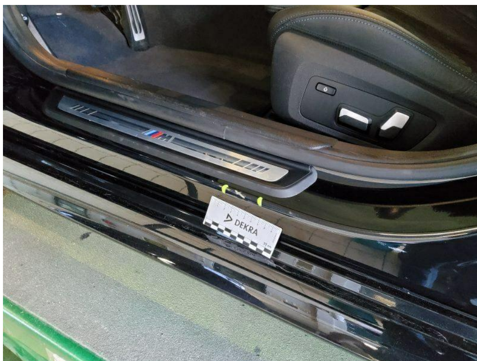
Bild 32 : Einstiegsschweller vorne links tiefer Kratzer bis Grundierung
