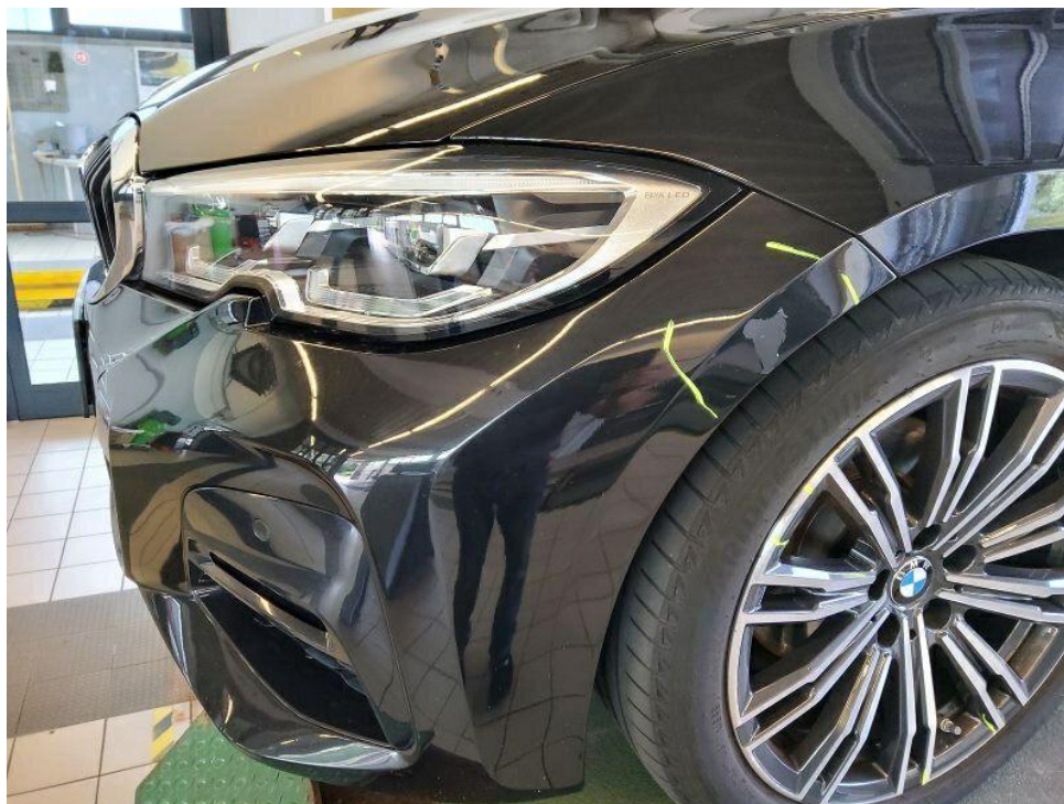
Bild 39 : Frontstoßfängerverkleidung linksseitig Lackabplatzung sowie rechts Verschrammung
