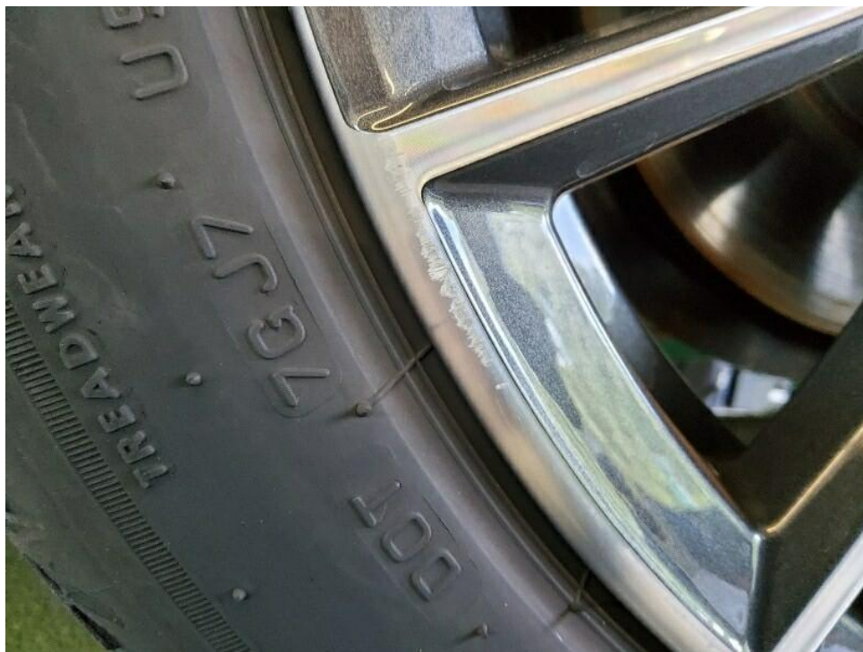
Bild 37 : Glanzgedrehte Felge vorne links umlaufende Verschrammungen
