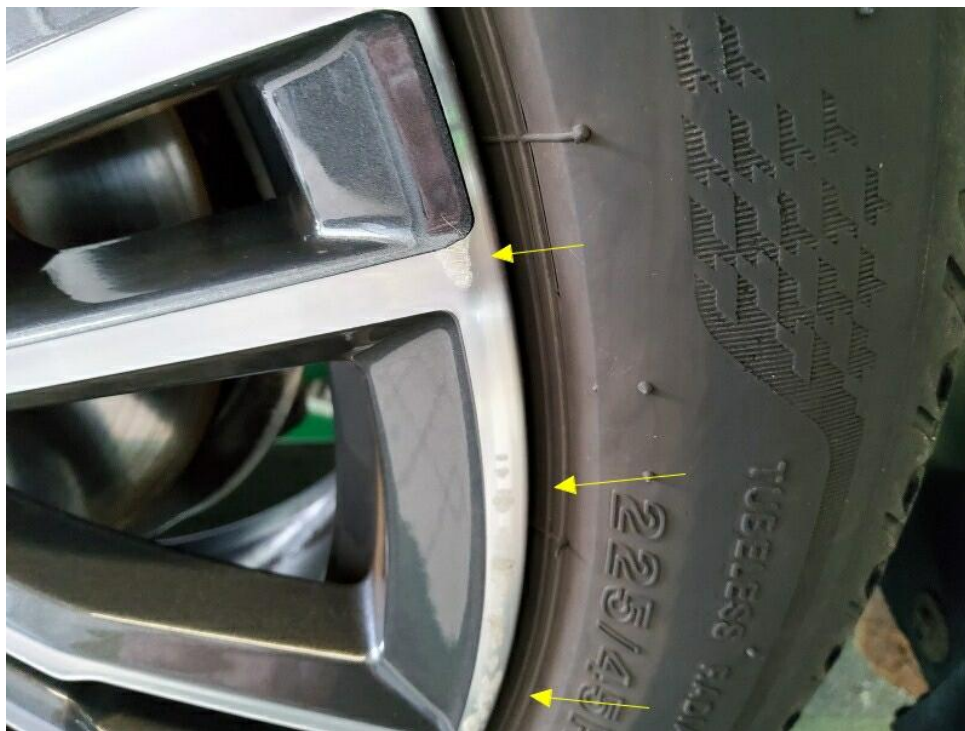
Bild 16 : Glanzgedrehte Felge vorne rechts umlaufende Verschrammungen
