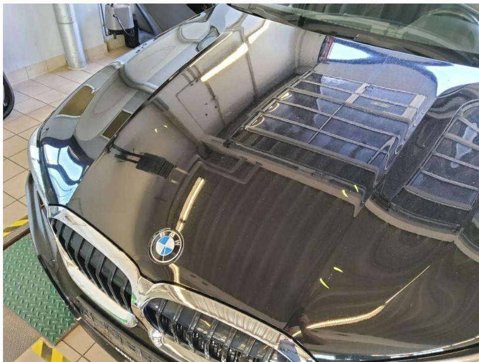
Bild 51 : Motorhaube mehrere tiefere Steinschläge - Auslegen und Polieren
