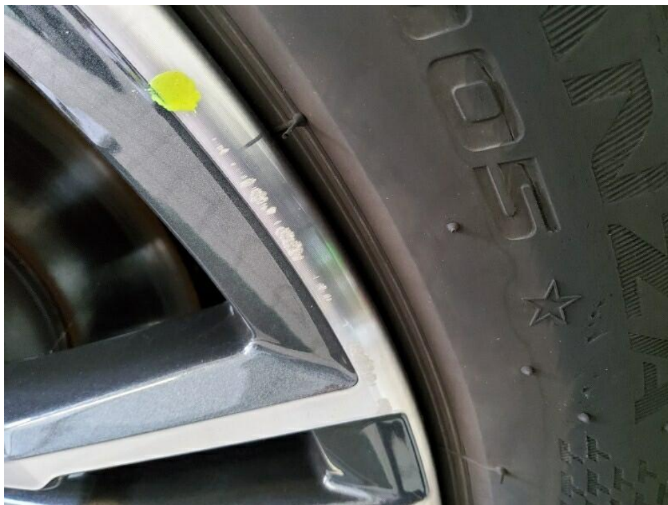
Bild 15 : Glanzgedrehte Felge vorne rechts umlaufende Verschrammungen
