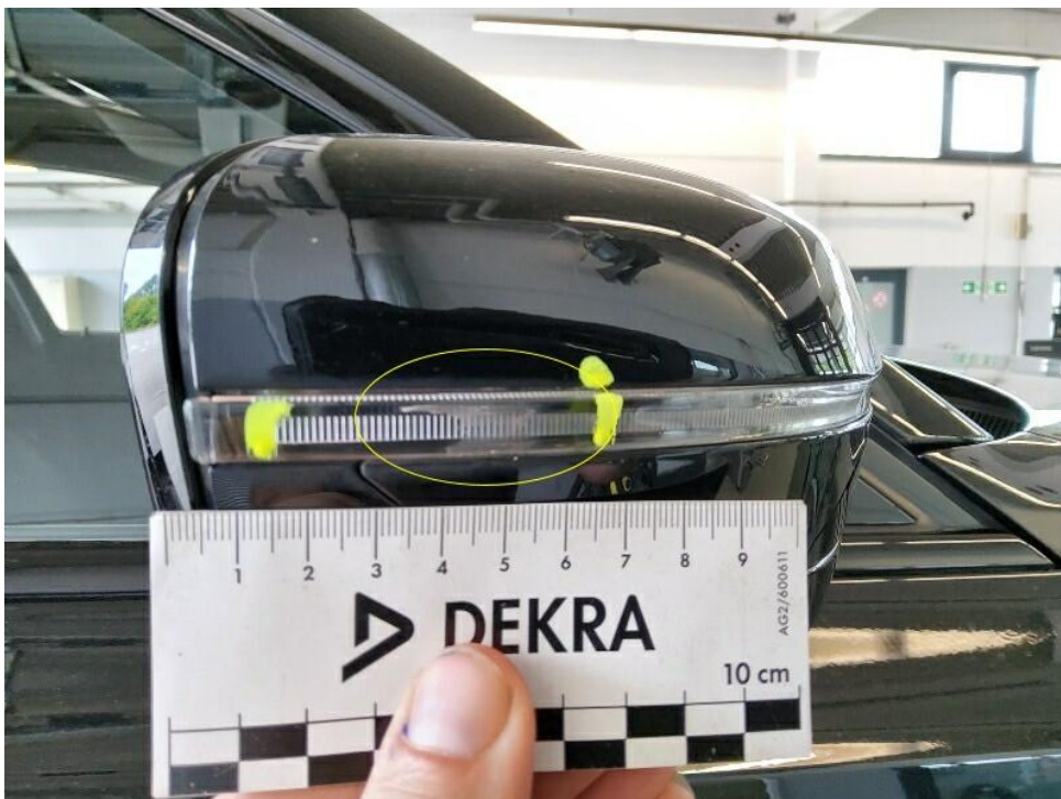
Bild 18 : Spiegelblinker rechts oberflächige Schramme ohne Beeinträchtigung der Funktion
