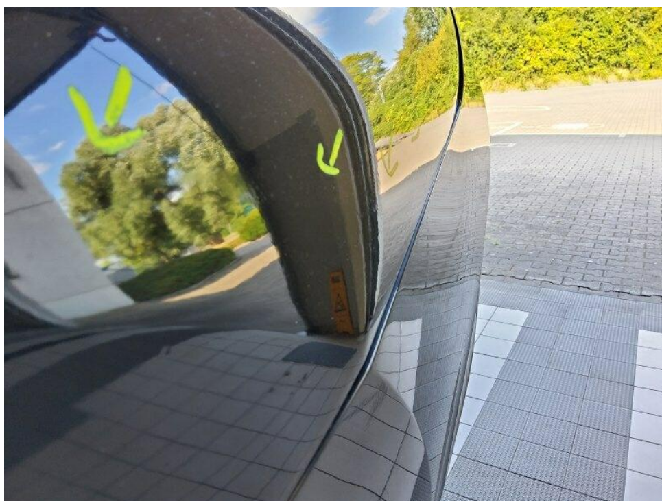
Bild 46 : Seitenwand hinten links unsachgemäß instandgesetzt - Silikoneinschlüsse / Lackfehler erkennbar
