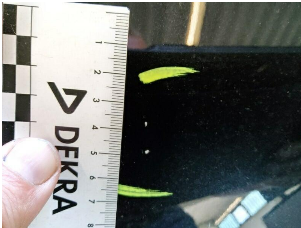
Bild 52 : Motorhaube mehrere tiefere Steinschläge - Auslegen und Polieren
