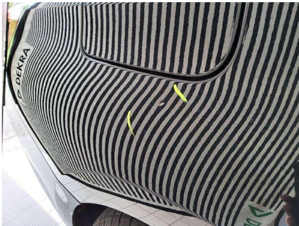
Bild 25 : Seitenwand hinten rechts "harte" Delle mit Lackbeschädigung
