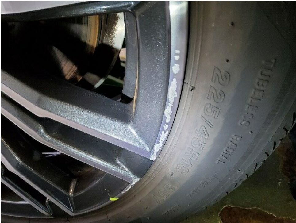
Bild 17 : Glanzgedrehte Felge vorne rechts umlaufende Verschrammungen
