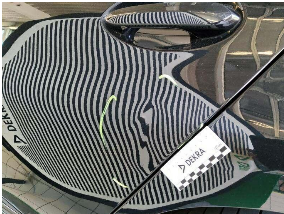
Bild 30 : Tür hinten links eingedrückt - Unfallschaden
