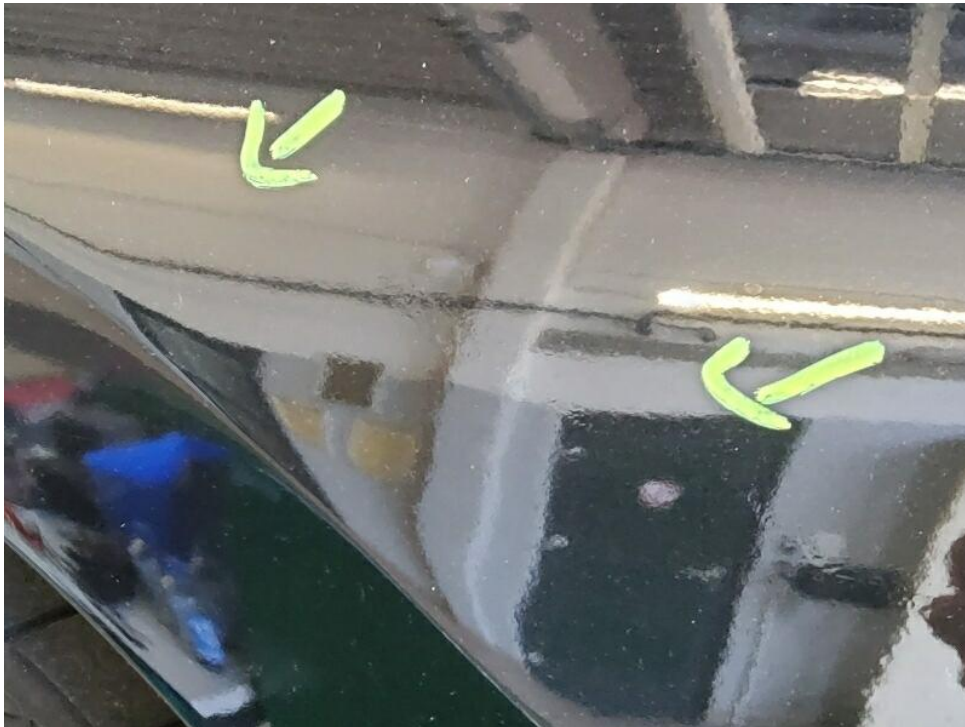
Bild 49 : Seitenwand hinten links unsachgemäß instandgesetzt - Silikoneinschlüsse / Lackfehler erkennbar
