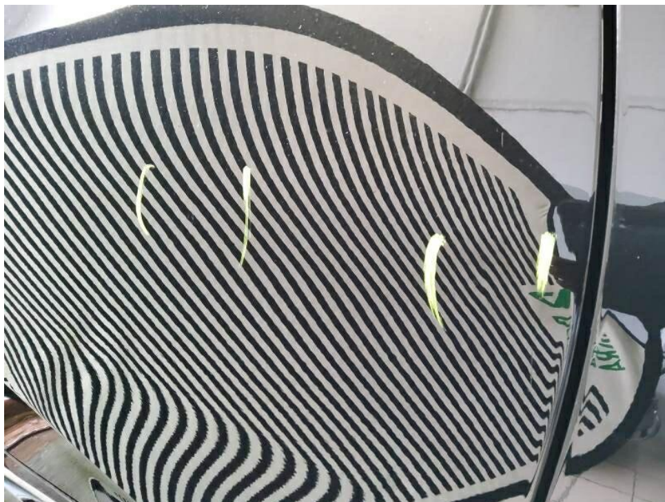
Bild 21 : Tür hinten rechts zwei "weiche" Dellen
