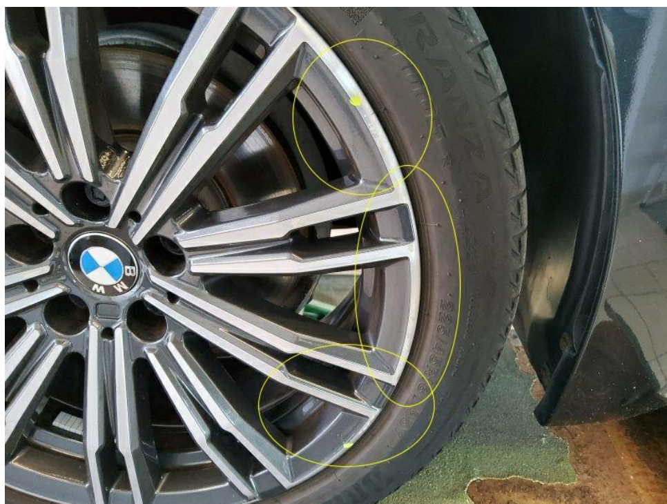
Bild 14 : Glanzgedrehte Felge vorne rechts umlaufende Verschrammungen
