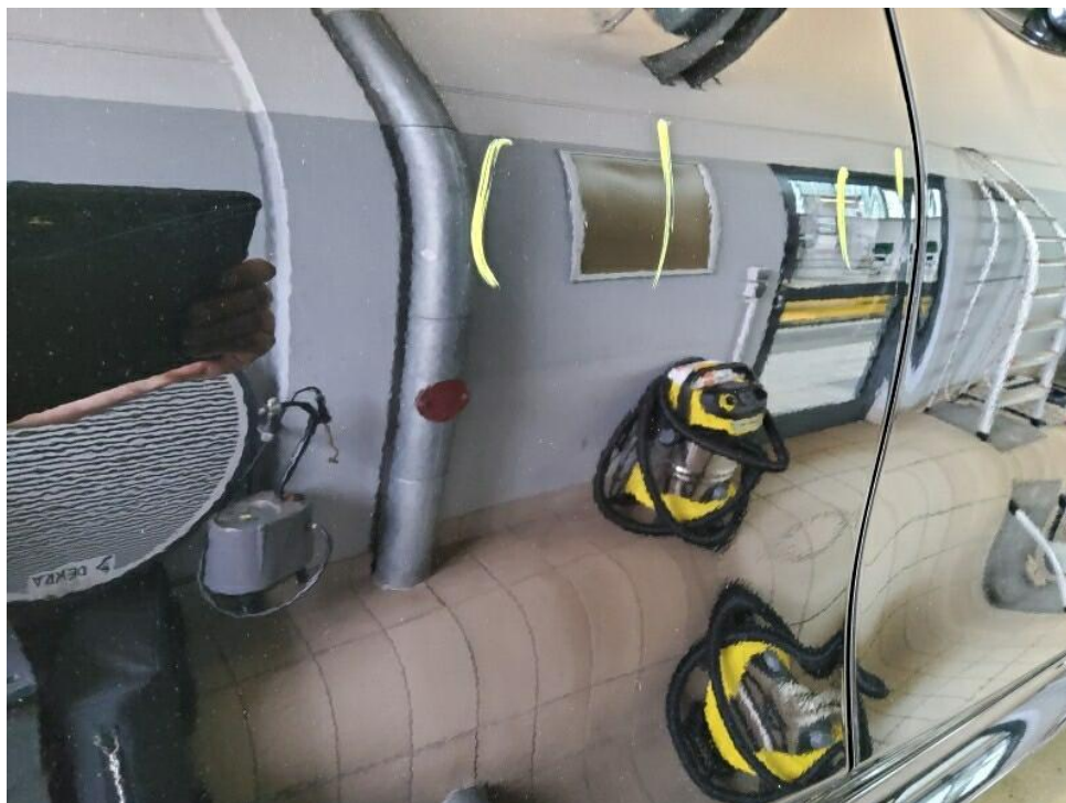
Bild 22 : Tür hinten rechts zwei "weiche" Dellen
