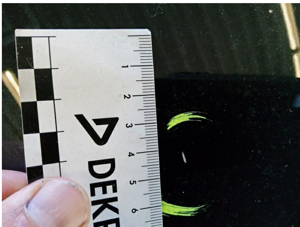
Bild 54 : Motorhaube mehrere tiefere Steinschläge - Auslegen und Polieren
