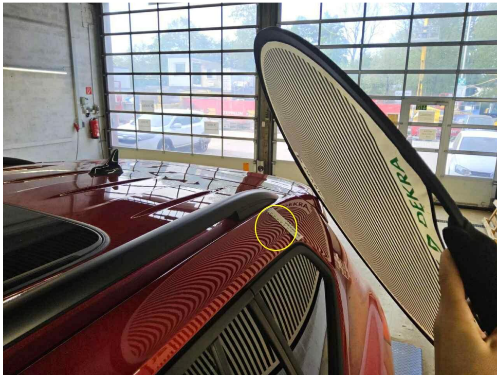
Bild 16 : Dachrahmen links, eingedellt, Gebrauchsspur
