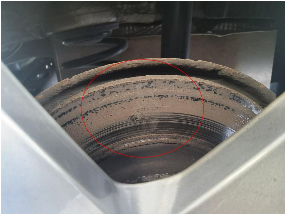
Bild 22 : Bremsscheiben hinten, Riefenbildung, Tragbild mangelhaft
