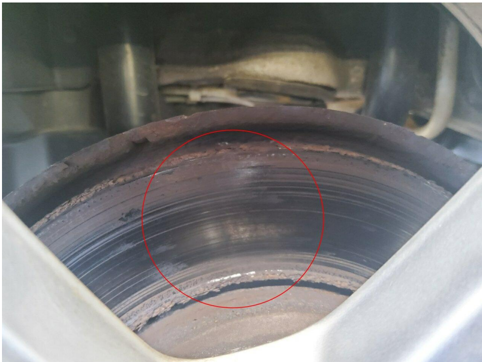
Bild 23 : Bremsscheiben hinten, Riefenbildung, Tragbild mangelhaft
