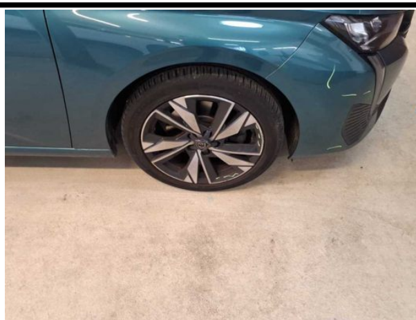
Beschädigung #4: Rad/Reifen: Leichtmetallfelge vorn rechts - verkratzt / verschürft - Wertminderung
