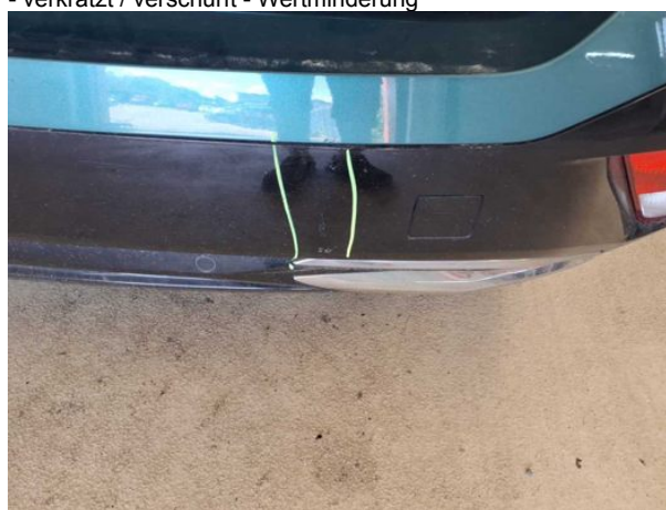
Beschädigung #7: Stossfänger hinten: Spoiler - verkratzt / verschürft - erneuern
