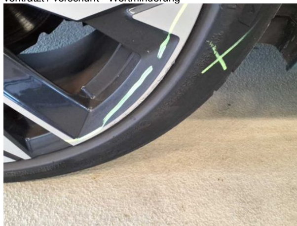
Beschädigung #5: Rad/Reifen: Leichtmetallfelge hinten rechts - verkratzt / verschürft - Wertminderung
