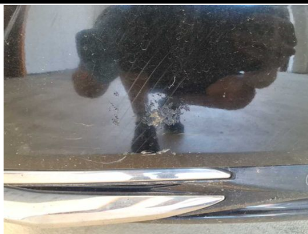
Beschädigung #7: Stossfänger hinten: Spoiler - verkratzt / verschürft - erneuern
