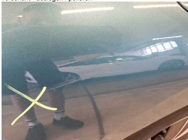
Beschädigung #1: Seitenwand rechts: Seitenwand - verkratzt / verschürft - auslegen / polieren
