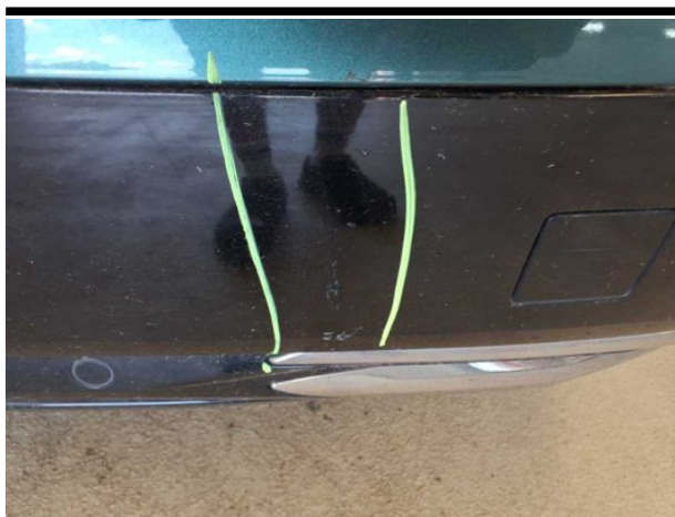
Beschädigung #7: Stossfänger hinten: Spoiler - verkratzt / verschürft - erneuern
