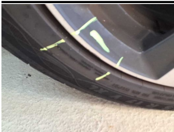
Beschädigung #3: Rad/Reifen: Leichtmetallfelge vorn links - verkratzt / verschürft - Wertminderung
