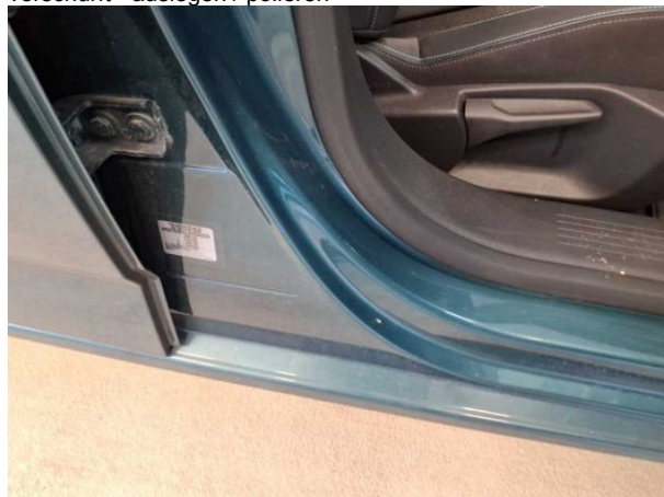
Beschädigung #2: Schweller rechts: Einstieg - Delle(n) - sanft instandsetzen
