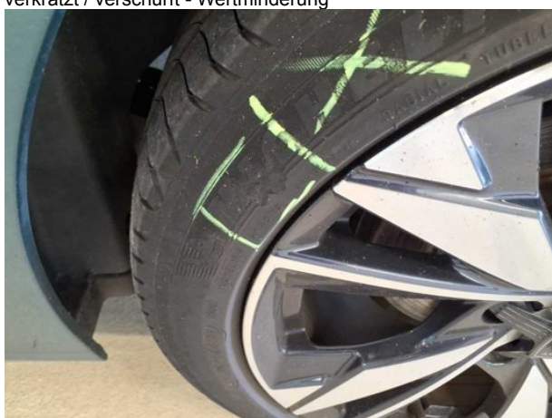
Beschädigung #6: Rad/Reifen: Reifen hinten links - beschädigt - erneuern
