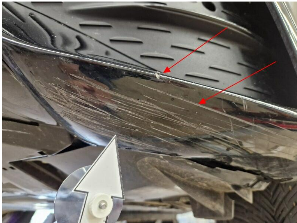
Bild 16 : Stoßfänger vorne Lackierung, verschrammt, lackieren mit Lackaufbau
