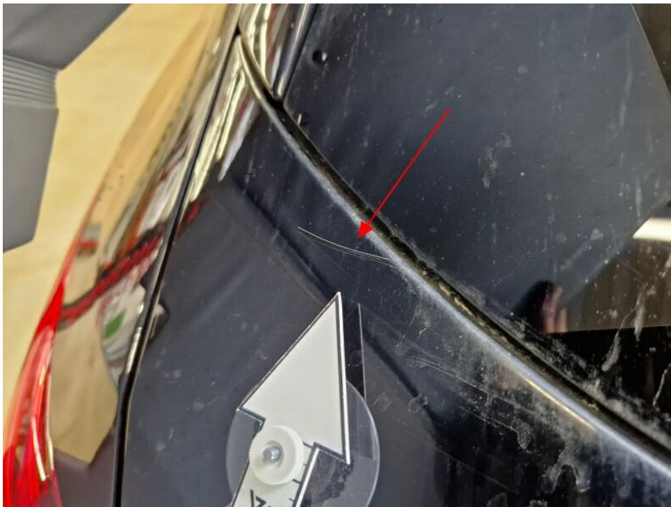
Bild 28 : Heckdeckel Lackierung, zerkratzt, lackieren mit Lackaufbau
