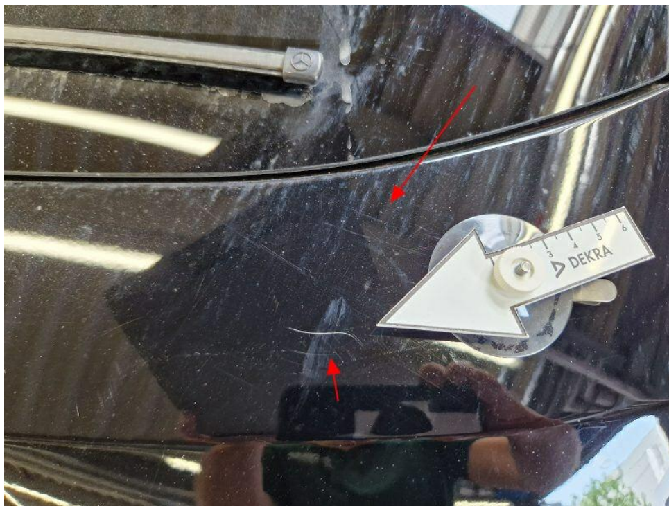
Bild 26 : Heckdeckel Lackierung, zerkratzt, lackieren mit Lackaufbau
