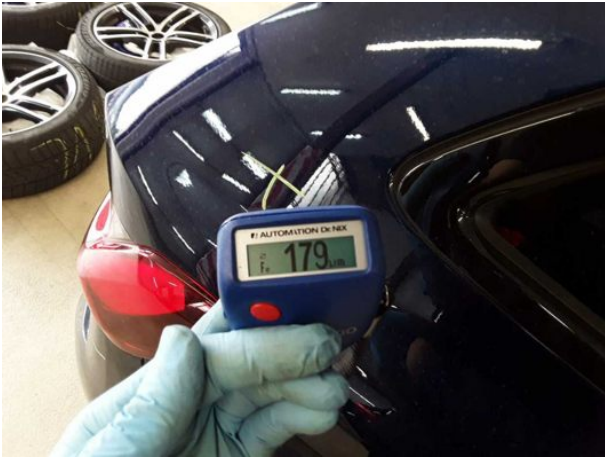
Nachlackierung 1: Seitenwand rechts
