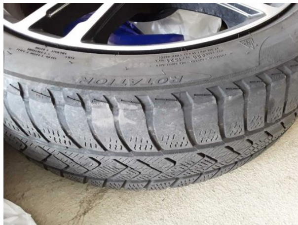
Beschädigung #2: 2.Radsatz: 2 Reifen - verschlissen - kein Abzug
