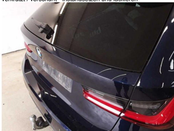
Beschädigung #14: Heckklappe/-tür: Heckklappe - verkratzt / verschürft - instandsetzen und lackieren
