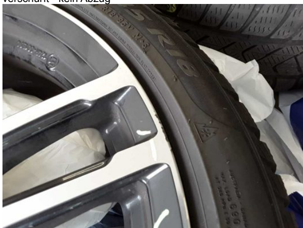
Beschädigung #3: 2.Radsatz: 2 Leichtmetallfelgen - verkratzt / verschürft - kein Abzug
