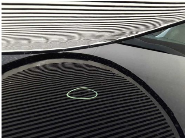
Beschädigung #6: Motorhaube: Motorhaube - Delle(n) - sanft instandsetzen
