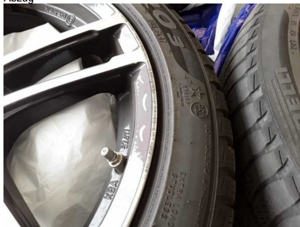
Beschädigung #3: 2.Radsatz: 2 Leichtmetallfelgen - verkratzt / verschürft - kein Abzug
