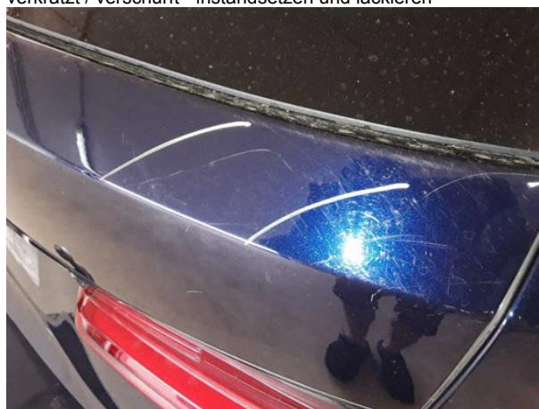
Beschädigung #14: Heckklappe/-tür: Heckklappe - verkratzt / verschürft - instandsetzen und lackieren
