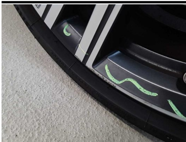
Beschädigung #9: Rad/Reifen: Leichtmetallfelge vorn rechts - verkratzt / verschürft - Wertminderung
