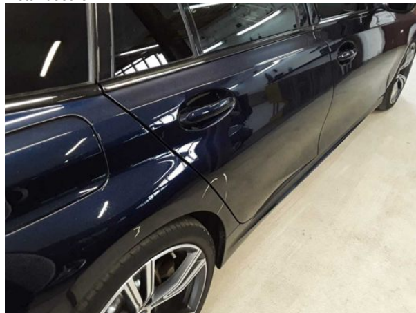
Beschädigung #7: Seitenwand rechts: Seitenwand - Delle(n) - sanft instandsetzen
