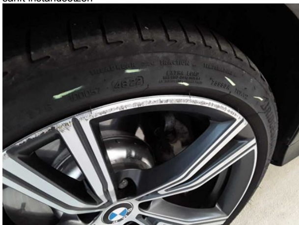
Beschädigung #8: Rad/Reifen: Leichtmetallfelge vorn links - verkratzt / verschürft - Wertminderung
