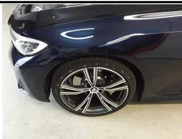
Beschädigung #8: Rad/Reifen: Leichtmetallfelge vorn links - verkratzt / verschürft - Wertminderung
