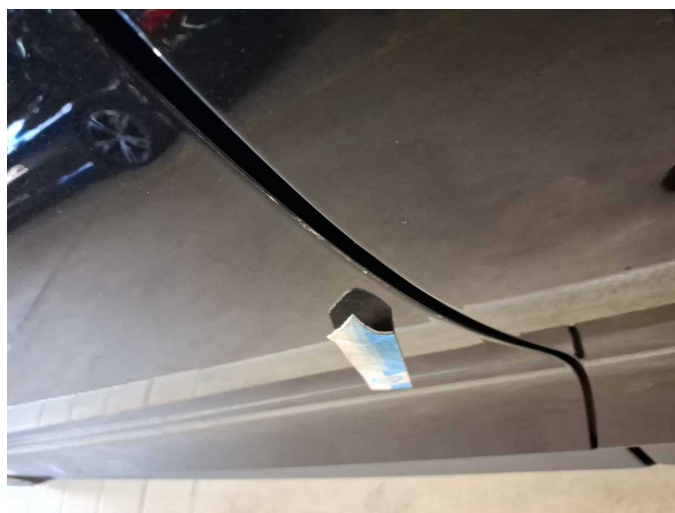
Damage 15: Door - front left side: Door - Scratch(es) - Paint
