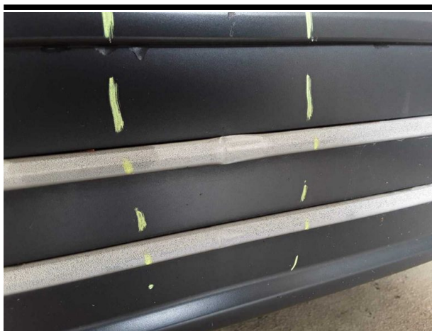
Beschädigung #6: Stossfänger hinten: Spoiler - verkratzt / verschürft - erneuern
