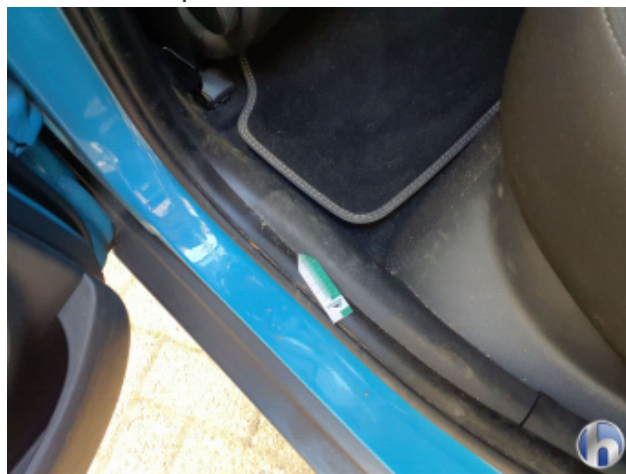
7. Verkleidung Verschmutzt - Reinigen
