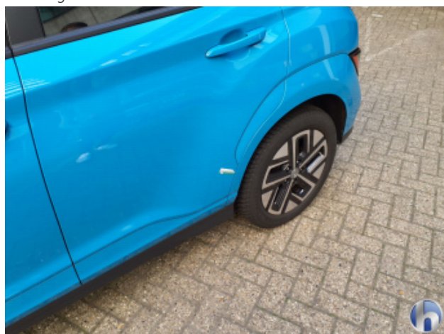
1. Seitenwand - Hinten - Links Kratzer - Smart Repair
