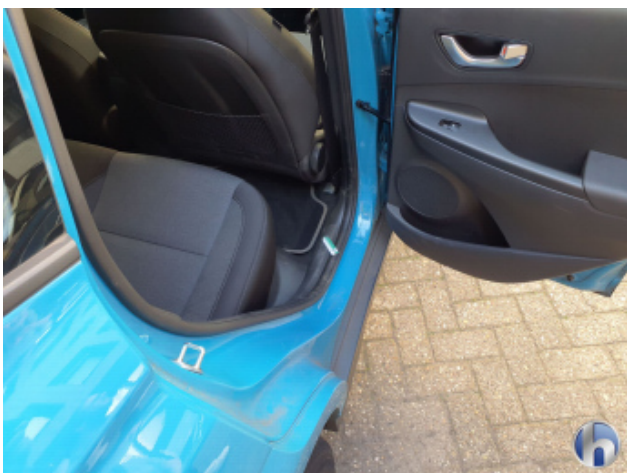
7. Verkleidung Verschmutzt - Reinigen
