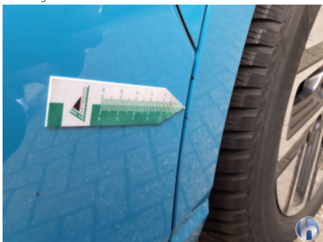
1. Seitenwand - Hinten - Links Kratzer - Smart Repair
