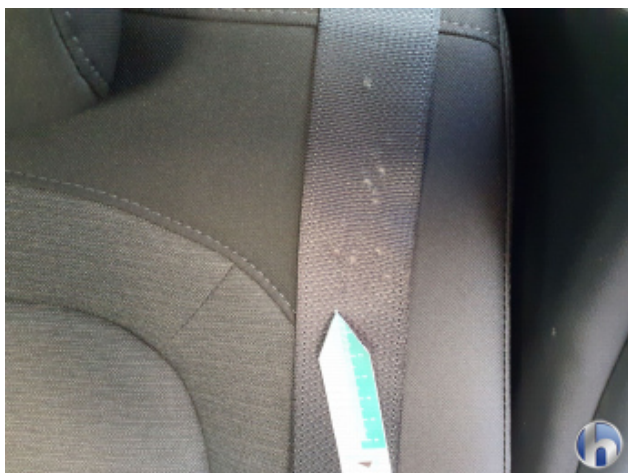
11. Gurt Beschädigt - Erneuern
