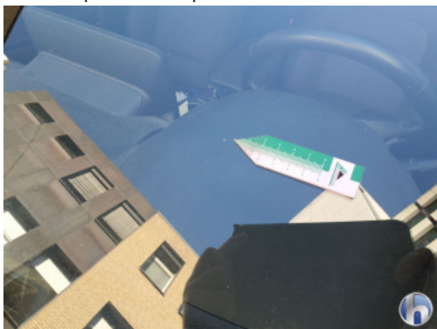
3. Windschutzscheibe Gebrauchsspuren - Ohne Reparatur
