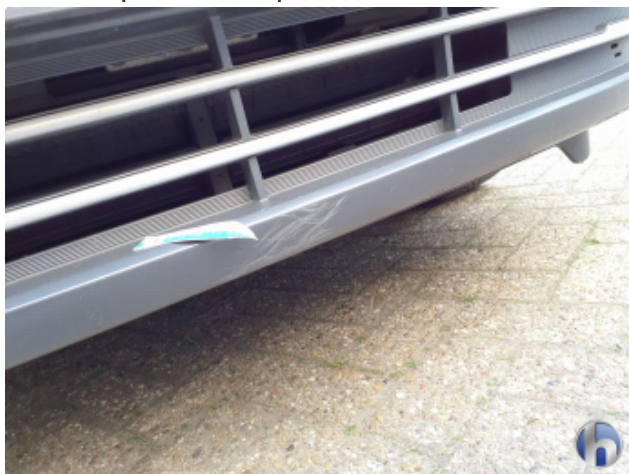
4. Stoßfänger Vorne Kratzer - Erneuern
