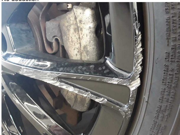
Damage #2: Wheel / tyres: Alloy rim - front right side (Sicherheitsrelevante Beschädigung) - Scratched - No deduction
