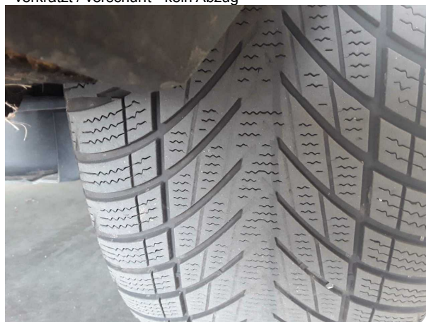
Beschädigung #3: Rad/Reifen: Reifen hinten - verschlissen - kein Abzug
