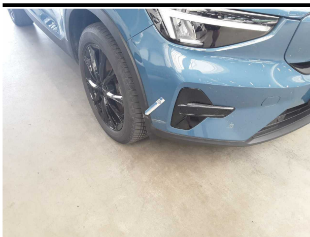
Beschädigung #5: Stossfänger vorn: Spoiler - verformt - erneuern
