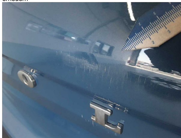
Beschädigung #6: Heckklappe/-tür: Heckklappe - verkratzt / verschürft - lackieren
