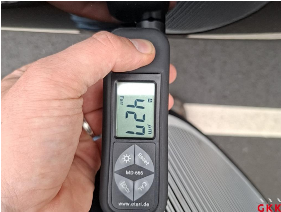
Bild 14. Seitenwand rechts, Reparaturmangel, lackieren
