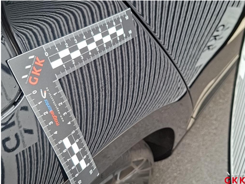
Bild 15. Seitenwand rechts, Reparaturmangel, lackieren
