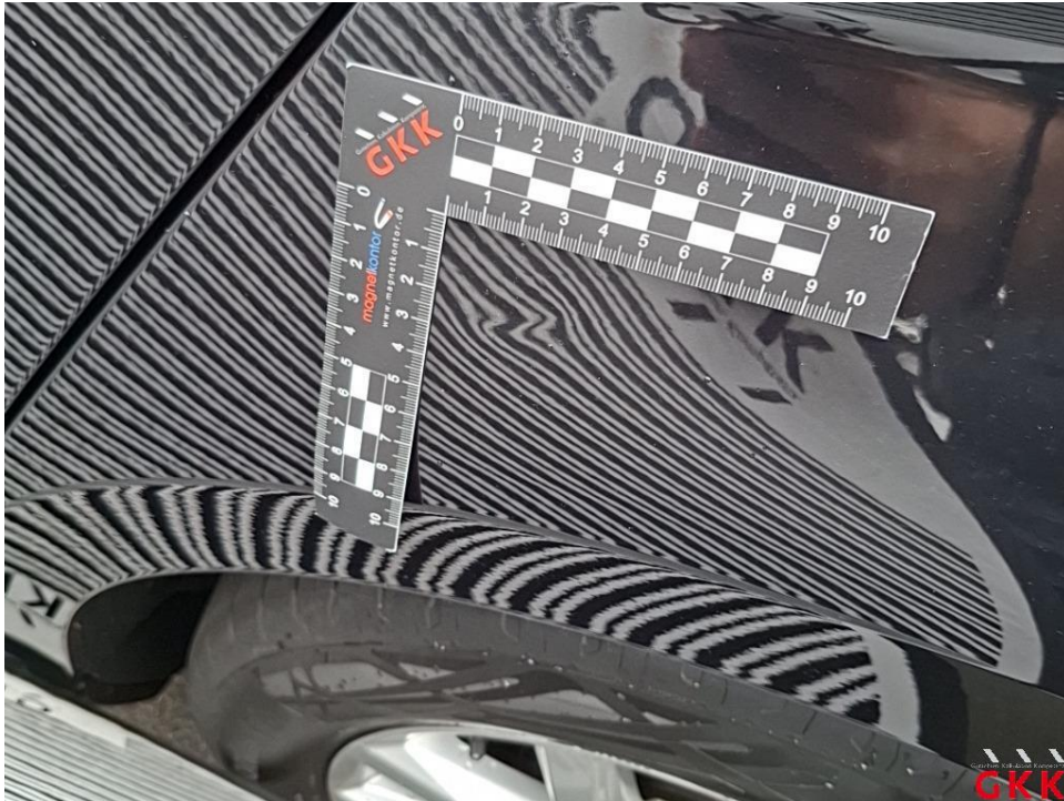
Bild 17. Seitenwand links, beschädigt, kalt drücken
