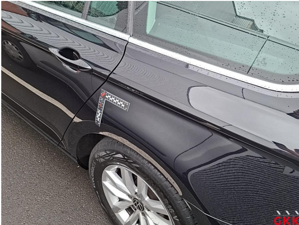
Bild 16. Seitenwand links, beschädigt, kalt drücken
