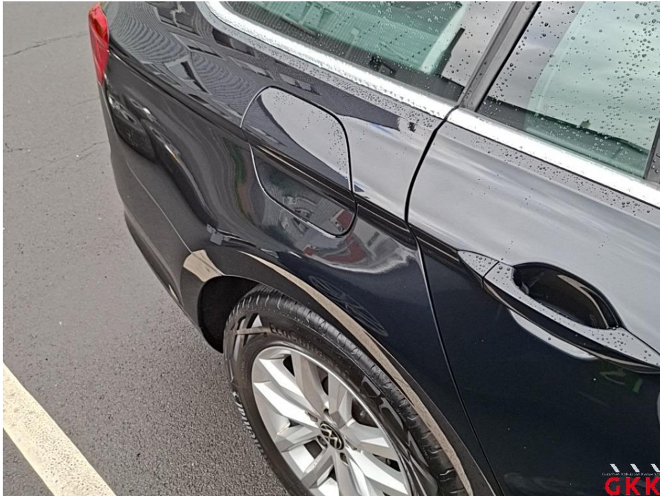
Bild 13. Seitenwand rechts, Reparaturmangel, lackieren
