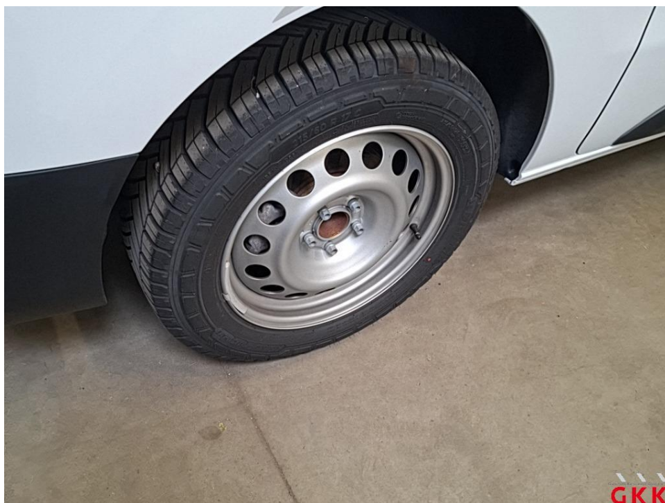
Bild 20 Radkappe(n), hinten rechts, fehlt, ersetzen
