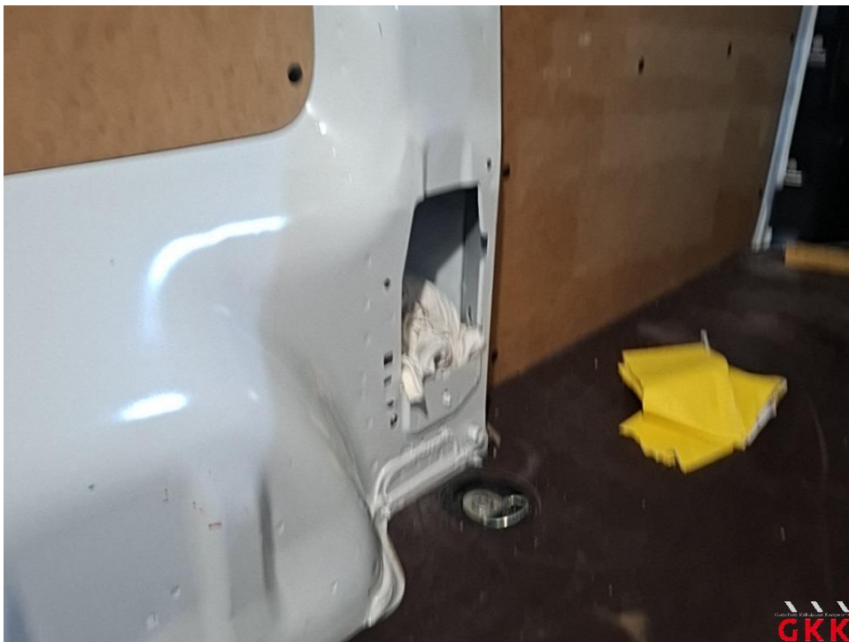
Bild 14 Laderaum, Abdeckung, fehlt, ersetzen
