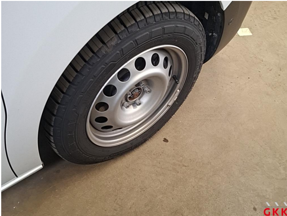
Bild 21 Radkappe(n), vorne rechts, fehlt, ersetzen
