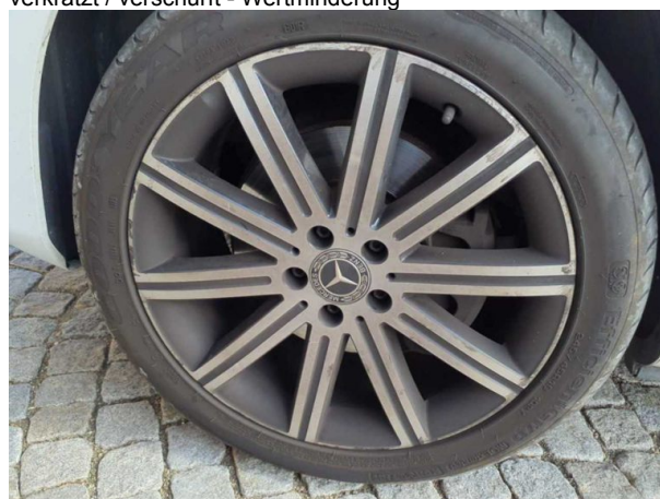
Beschädigung 4: Rad/Reifen: Leichtmetallfelge vorn links - verkratzt / verschürft - instandsetzen und lackieren
