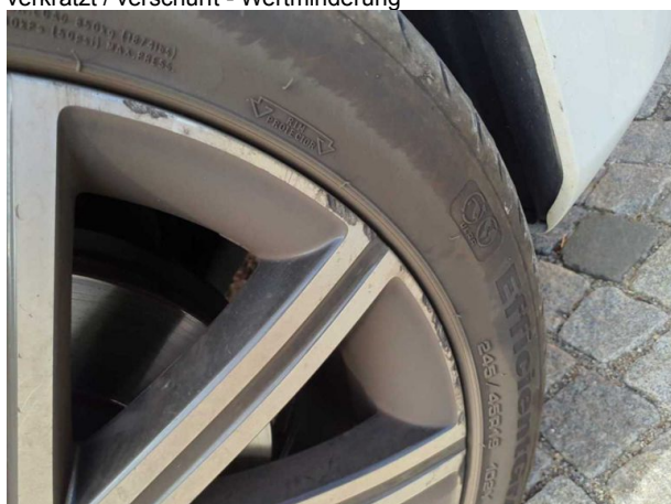
Beschädigung 5: Rad/Reifen: Leichtmetallfelge vorn rechts - verkratzt / verschürft - Wertminderung
