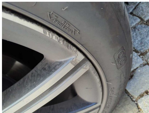
Beschädigung 3: Rad/Reifen: Leichtmetallfelge hinten rech... verkratzt / verschürft - Wertminderung
