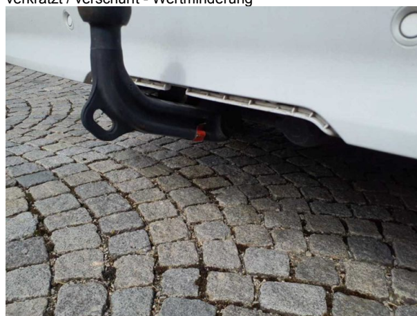
Beschädigung 6: Stossfänger hinten: Abdeckung Stossfänger hinten - fehlt - erneuern
