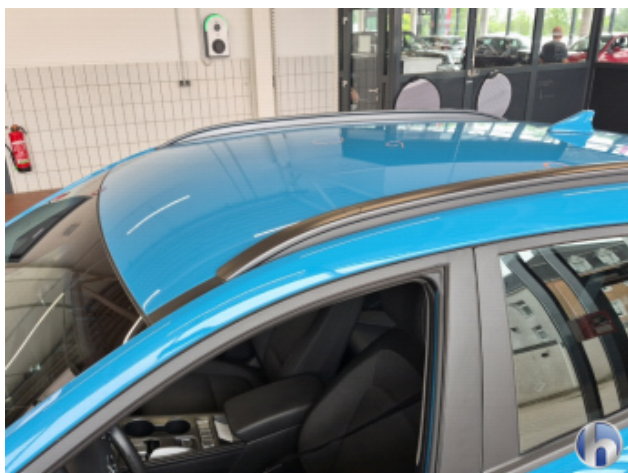
1. Dach 3 Dellen - Sanft Instandsetzen
