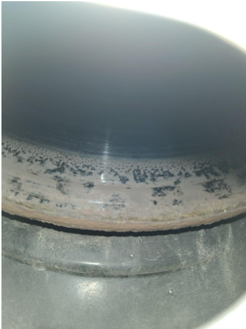
Bild 12 : Bremsscheiben hinten Tragbild mangelhaft
