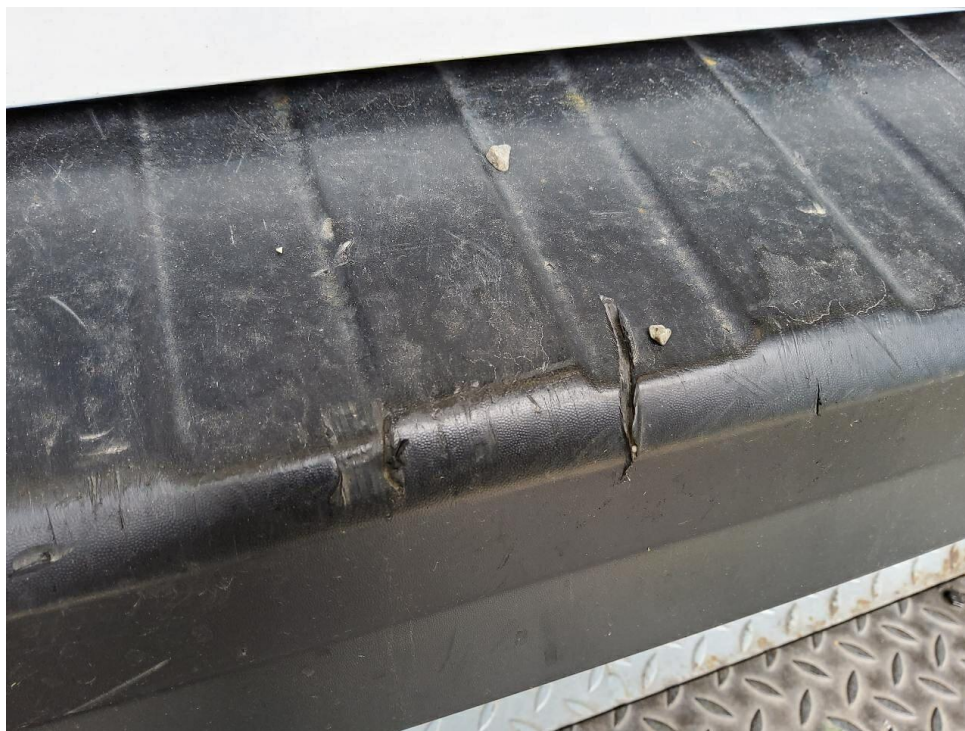
Bild 10 : Stoßfänger hinten verschrammt
