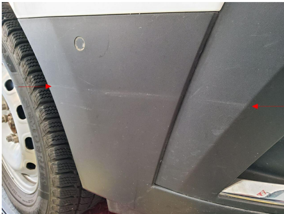
Bild 7 : Stoßfänger vorn verschrammt
