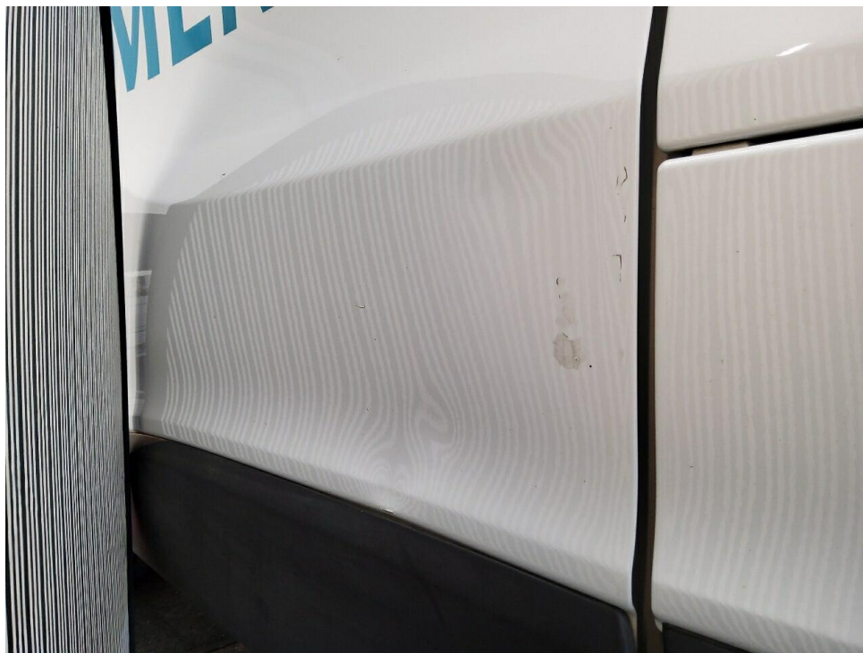
Bild 8 : Tür vorn links deformiert
