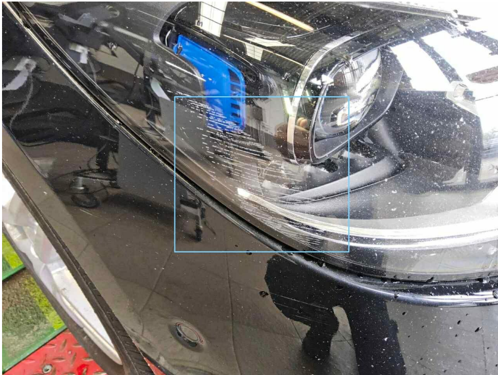
Bild 19 : Scheinwerfer rechts, zerkratzt, Gebrauchsspur
