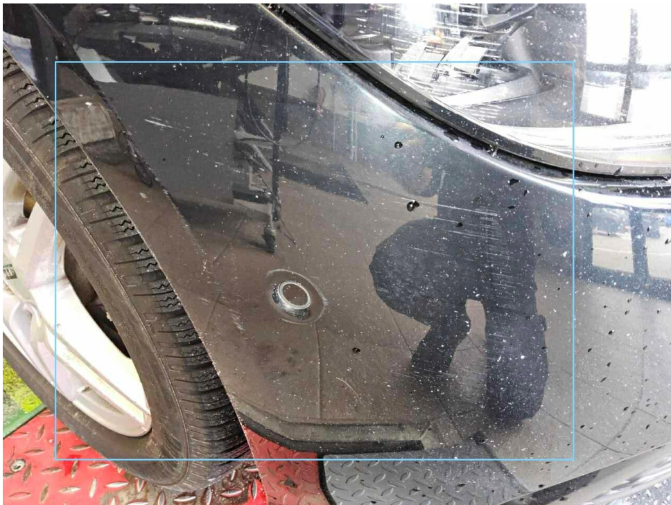
Bild 20 : Stoßfänger vorne Lackierung, zerkratzt, smart repair
