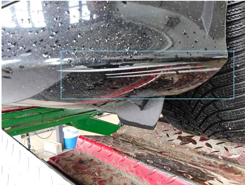
Bild 21 : Frontspoiler Lackierung, zerkratzt, lackieren mit Lackaufbau
