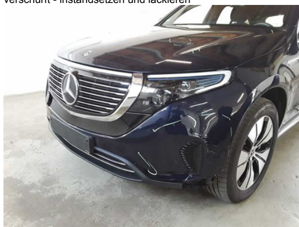
Beschädigung #18: Stossfänger vorn: Stossfänger mit Parktronic - beschädigt - erneuern
