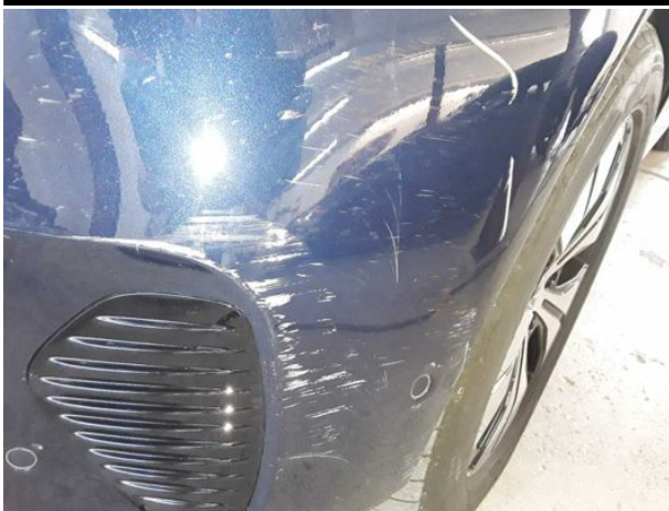
Beschädigung #18: Stossfänger vorn: Stossfänger mit Parktroni... beschädigt - erneuern
