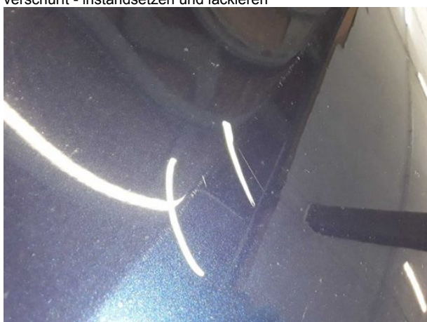
Beschädigung #17: Motorhaube: Motorhaube - verkratzt / verschürft - instandsetzen und lackieren
