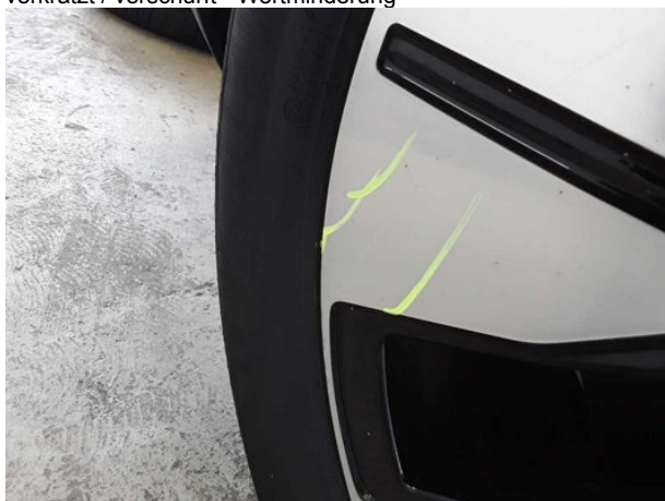
Beschädigung #8: Rad/Reifen: Leichtmetallfelge hinten rechts - verkratzt / verschürft - Wertminderung
