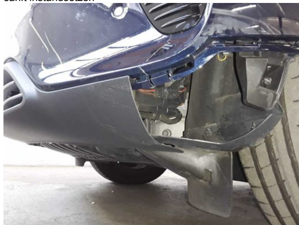
Beschädigung #13: Stossfänger vorn: Spoiler - beschädigt - erneuern
