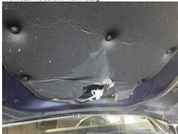
Beschädigung #4: Motorhaube: Dämmmatte - Marderschaden - erneuern
