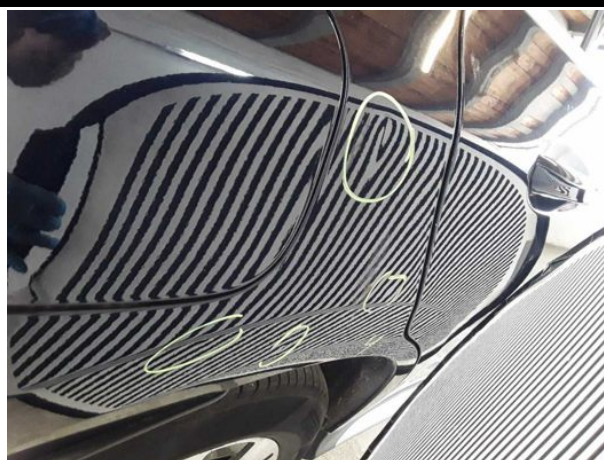
Beschädigung #16: Seitenwand rechts: Seitenwand - Delle / Lackschaden - instandsetzen und lackieren
