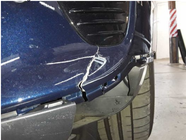
Beschädigung #18: Stossfänger vorn: Stossfänger mit Parktroni... beschädigt - erneuern
