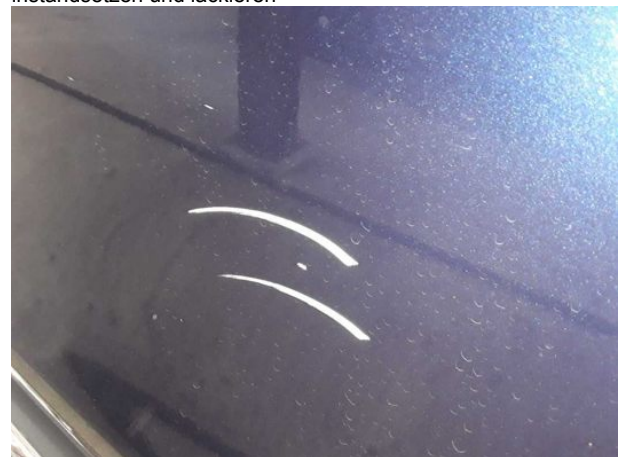
Beschädigung #15: Tür vorn links: Tür - verkratzt / verschürft - instandsetzen und lackieren
