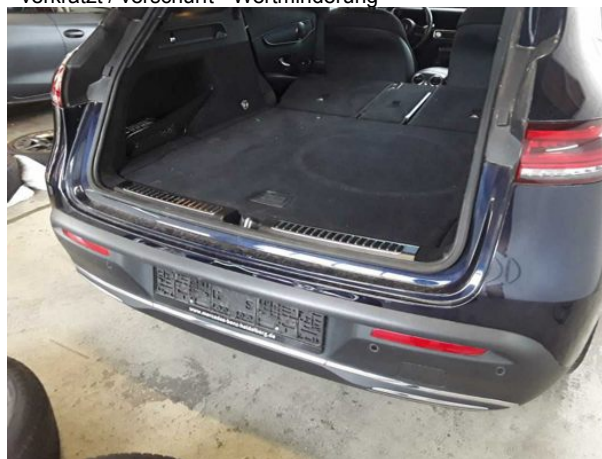
Beschädigung #9: Stossfänger hinten: Stossfänger hinten - verkratzt / verschürft - Smart Repair
