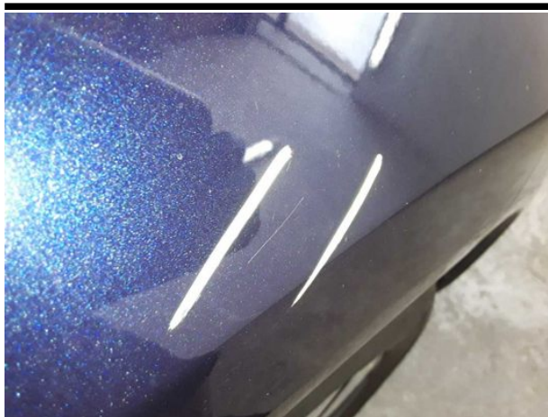
Beschädigung #10: Kotflügel rechts: Kotflügel rechts - verkratzt / verschürft - Smart Repair
