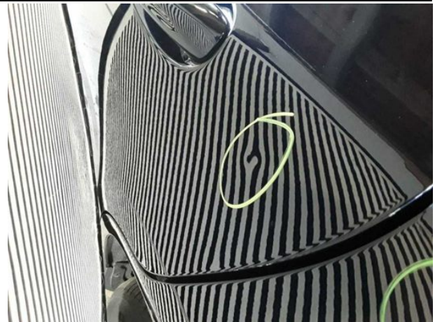
Beschädigung #14: Tür hinten links: Tür - Delle / Lackschaden - instandsetzen und lackieren
