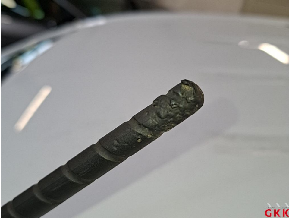
Bild 17 Antenne, Stab, beschädigt, ersetzen
