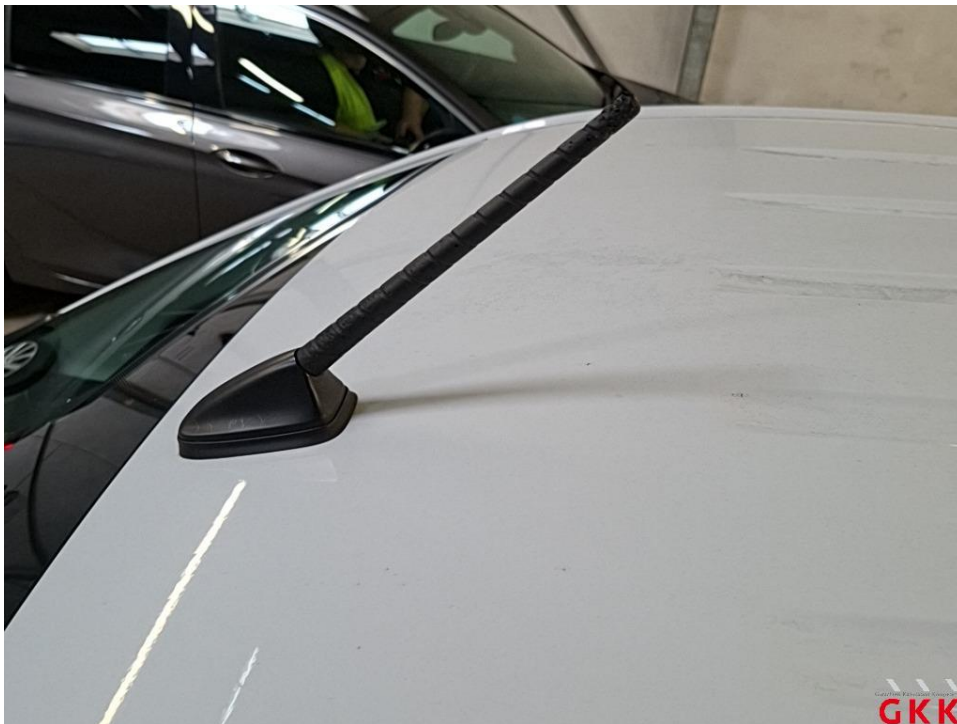
Bild 16 Antenne, Stab, beschädigt, ersetzen
