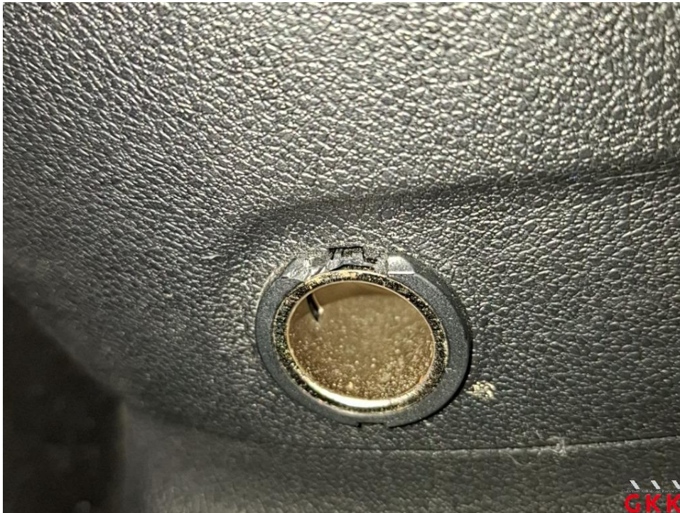
Bild 15 Armaturenbrett, Steckdose, beschädigt, ersetzen
