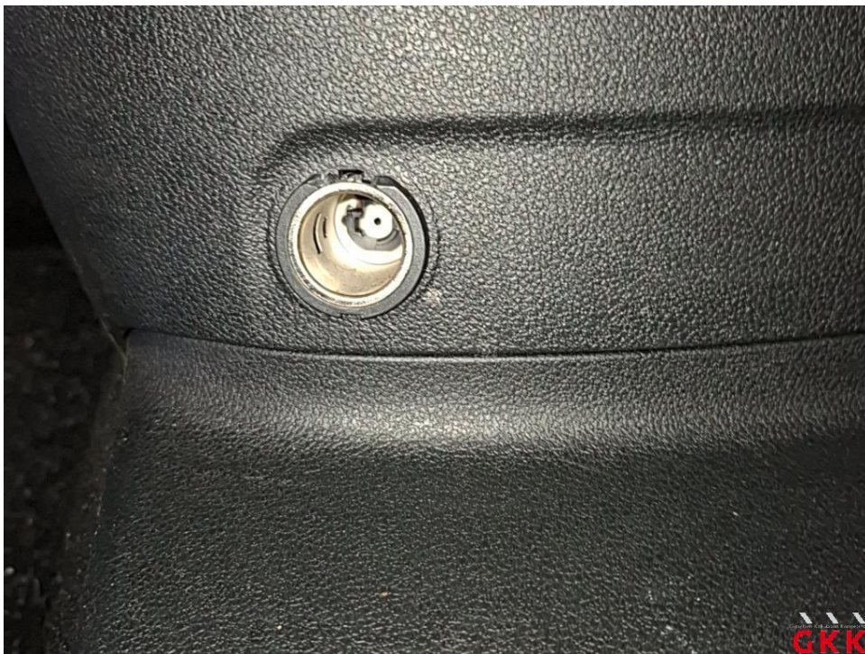
Bild 14 Armaturenbrett, Steckdose, beschädigt, ersetzen
