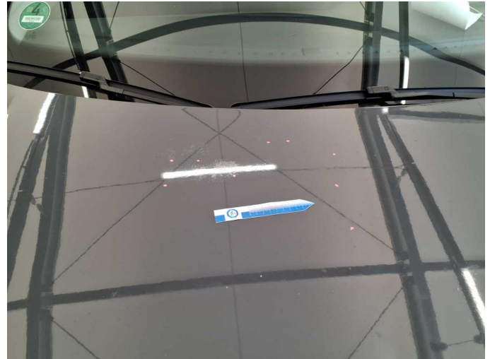
Damage 8: Bonnet: Bonnet (Delle+ Verätzungen) - Dent / paintcoat damage - Repair and paint
