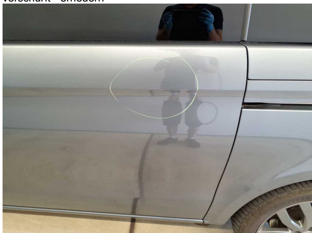
Beschädigung #4: Schiebetür links: Schiebetür mit Glasscheibe - Delle / Lackschaden - sanft instandsetzen
