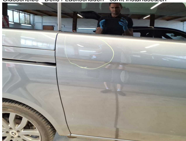
Beschädigung #5: Schiebetür rechts: Schiebetür mit Glasscheibe - Delle(n) - sanft instandsetzen
