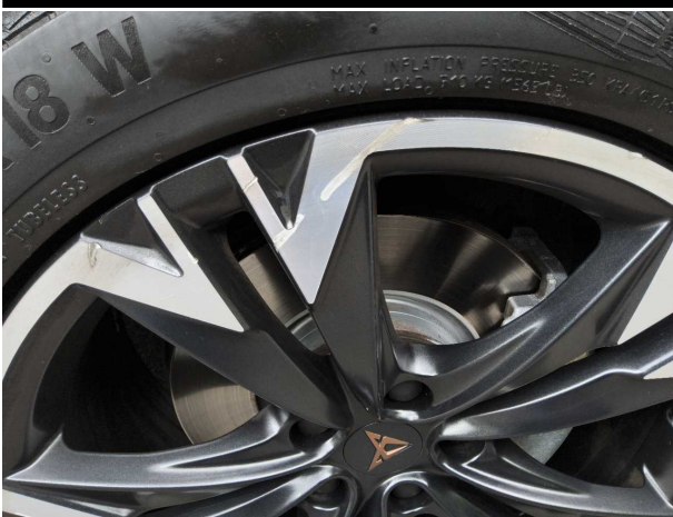
Beschädigung #2: Rad/Reifen: Leichtmetallfelge vorn rechts (Materialabrieb) - verkratzt / verschürft - erneuern
