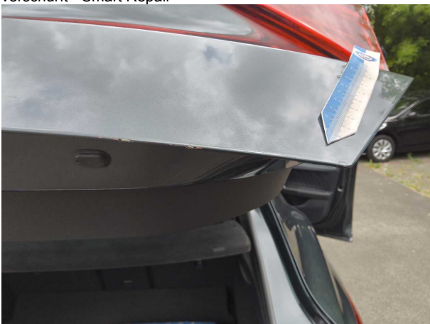
Beschädigung #1: Heckklappe/-tür: Heckklappe - verkratzt / verschürft - Smart Repair
