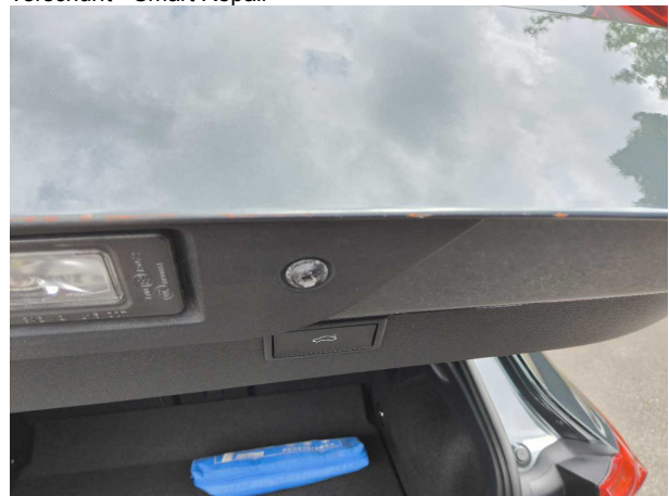
Beschädigung #1: Heckklappe/-tür: Heckklappe - verkratzt / verschürft - Smart Repair
