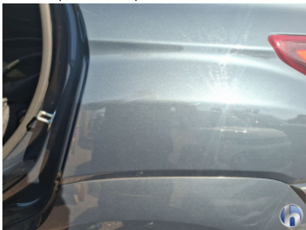
7. Seitenwand - Hinten - Links Kratzer - Lackieren
