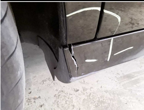
Beschädigung #4: Schweller rechts: Verkleidung - gebrochen / gerissen - erneuern
