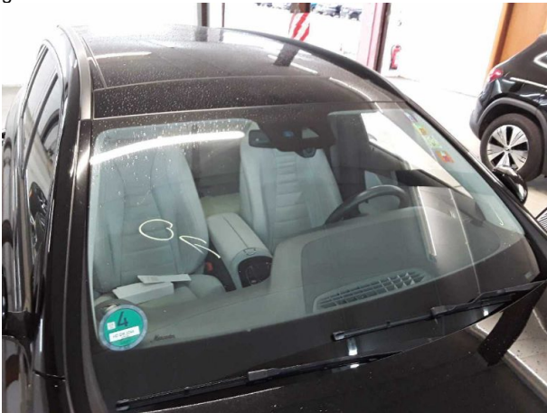
Beschädigung #5: Verglasung: Frontscheibe (Steinschläge) - erneuern
