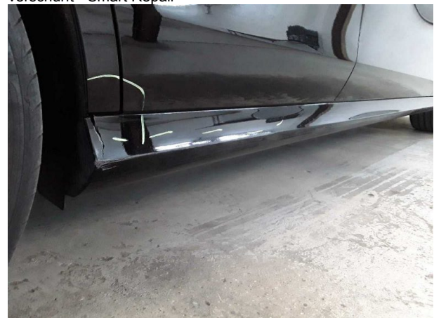
Beschädigung #4: Schweller rechts: Verkleidung - gebroche... gerissen - erneuern
