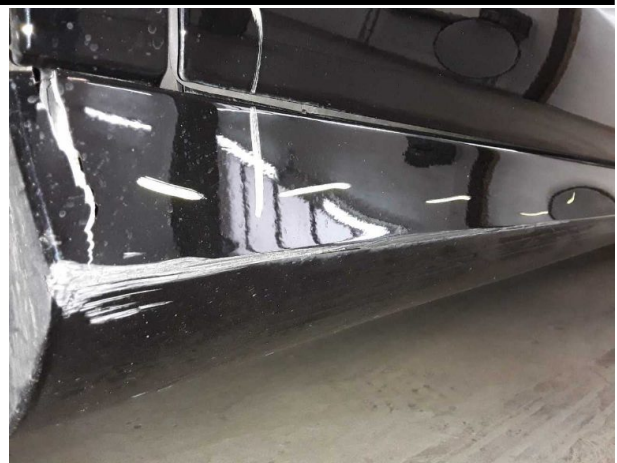
Beschädigung #4: Schweller rechts: Verkleidung - gebroche... gerissen - erneuern
