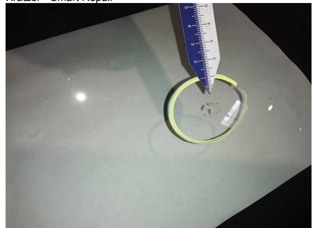
Beschädigung #2: Verglasung: Frontscheibe - Steinschlag - erneuern
