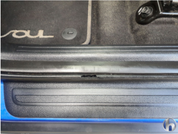
3. Türdichtung Vorne - Links Beschädigt - Erneuern
