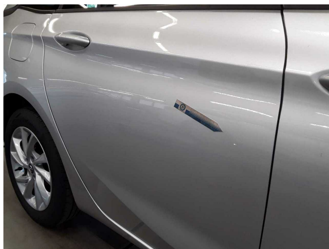
Damage 5: Door - rear right side: Door (Mehrkosten möglich) - Scratch(es) - Conditioning
