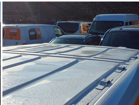
Pavillon / Arrière / Enfoncement
